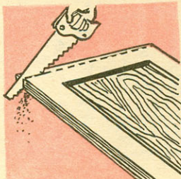
Р и с. 4. Спиливание полотна двери по линии верхней планки.
