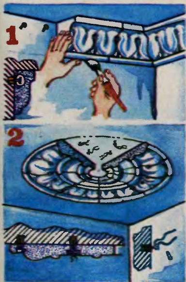
1 — установка деталей карниза; 2 — установка деталей розетки.
