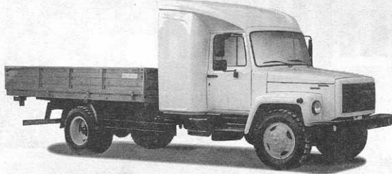
ГАЗ-3307/09 БОРТОВОЙ, кабина с двумя спальными местами, удлиненное шасси (5 или 6 метров)
