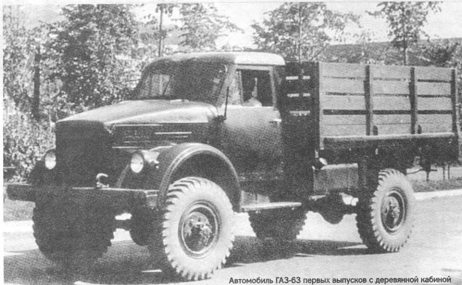
Автомобиль ГАЗ-63 первых выпусков с деревянной кабиной
