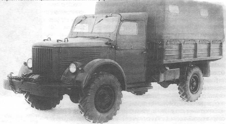
Опытный образец вездехода 4x4 с ведущими мостами БРДМ-1 и кабиной опытного ГАЗ-52
