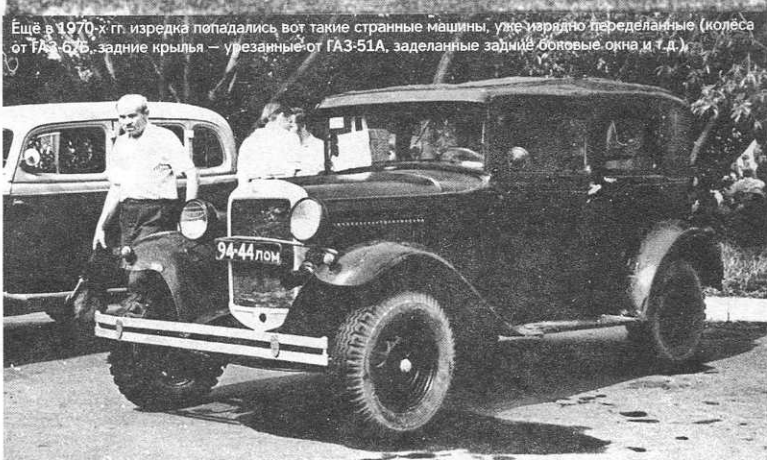
ГАЗ-А с самодельным закрытым четырёхдверным кузовом, собранным из двух кабин ГАЗ-АА. Новосибирск, 1936 г.
