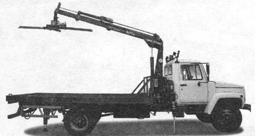
ГАЗ-3307/3309 ЭВАКУАТОР с прямой платформой и крано-манипуляторной установкой Amco Veba
