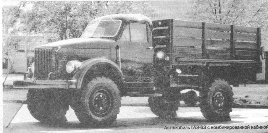
Автомобиль ГАЗ-63 первых выпусков с деревянной кабиной
