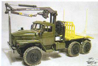
Урал с гидроманипулятором Rotne RK80 (conversion)
