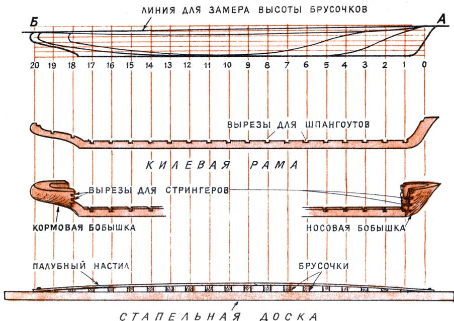
После того как листы обшивки вы смажете клеем и прикрепите гвоздями к шпангоутам и стрингерам, можете вырезать палубу из 2—3-мм фанеры и поставить ее с клеем и гвоздиками на свое место. Не забудьте предварительно сделать в ней вырезы для доступа внутрь корпуса, где размещаются механизмы, батареи и т. д.
