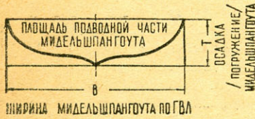
Рис. 10. Схематическое изображение площади подводной части шпангоута и площади прямоугольника с шириной и высотой, равными ширине и погружению шпангоута.
