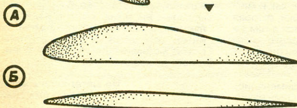
Рис. 3. Профили крыла (А) и стабилизатора (Б), построенные по приведенным координатам.
