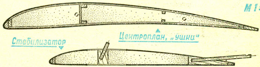
Шаблоны профилей несущих поверхностей модели. Окантовка нервюр крыла — липовый шпон толщиной 0,5 мм, «наполнитель» — пенопласт марки ПС-4-40 или упаковочный мелкошарииковый.
