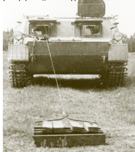
Испытание лебёдки гусеничного транспортёра ГАЗ-73 (ГТ-МУ) путём подтягивания груза массой 400 кг
