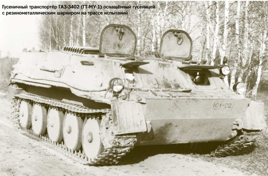
Гусеничный транспортёр ГАЗ-3402 (ГТ-МУ-1) оснащённый гусеницей с резинометаллическим шарниром на трассе испытаний
