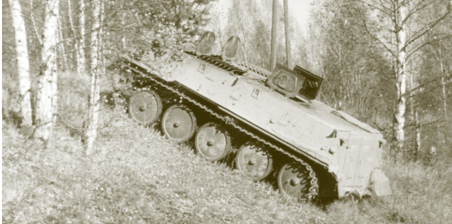
Гусеничный транспортёр ГАЗ-3402 (ГТ-МУ-1) преодолевает подъём. Видны открытые створки верхнего люка десантного отделения
