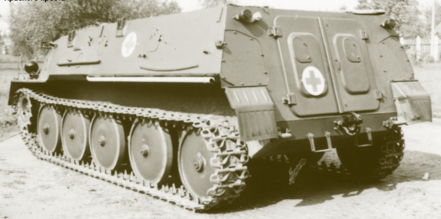
Гусеничный транспортёр ГАЗ-3402 (ГТ-МУ-1) оснащённый гусеницей с резинометаллическим шарниром со знаками Красного креста
