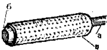
Рис 8. Распылитель воздуха: а - шланг от воздуходувного аппарата, б - резиновая пробка, в - отрезок резиновой трубки.
