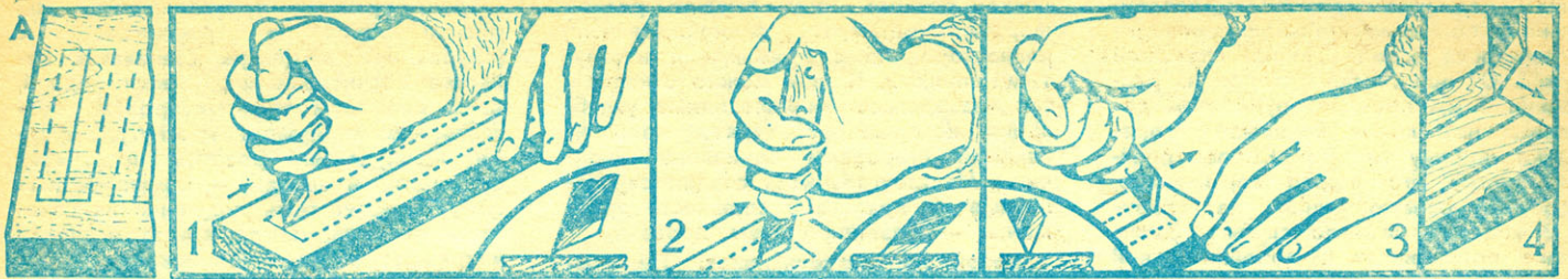
Рис. 5. Работа ножом-носячком: 1 — положение ножа в начале прорезки, 2 — конечное врезание, 3 — дорезание линии, 4 — поперечная подрезка конца соломки; А — размеченная заготовка.
