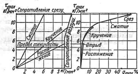
Фиг. 11. Диаграмма механического состояния.
