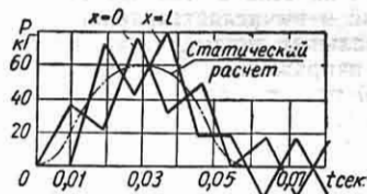
Фиг. 14. Изменение усилий в витках клапанной пружины при движении ее конца по закону, представленному на фиг. 13.
