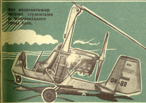
Двигатель «Микро-III» имеет мощность 65 л. с. Габаритные размеры: длина — 3,6 м, высота — 2,34 м, ширина — 1,9 м. Вес пустого — 145 кг, полный вес — 270 кг. Разбег — от 500 до 300 м, посадка — на «пятчок», скорость — 110 км/час.
