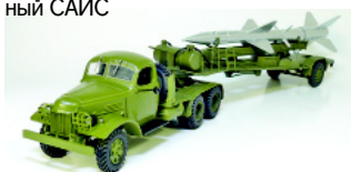
ЗИС-151 + ПР-11А транспортно-разряжающая машина (ТЗМ) комплекса С75 Волхов с ракетой 13Д САИС
