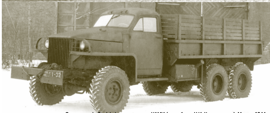
«Односкатный» Studebaker конструкции НАМИ (разработка Н.И. Коротоношко). Москва, 1944 г.
