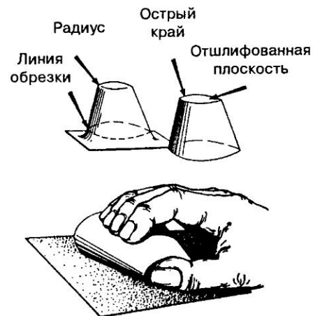
Рис. 82. Окончательная обработка кожуха дымовой трубы после горячей вытяжки
