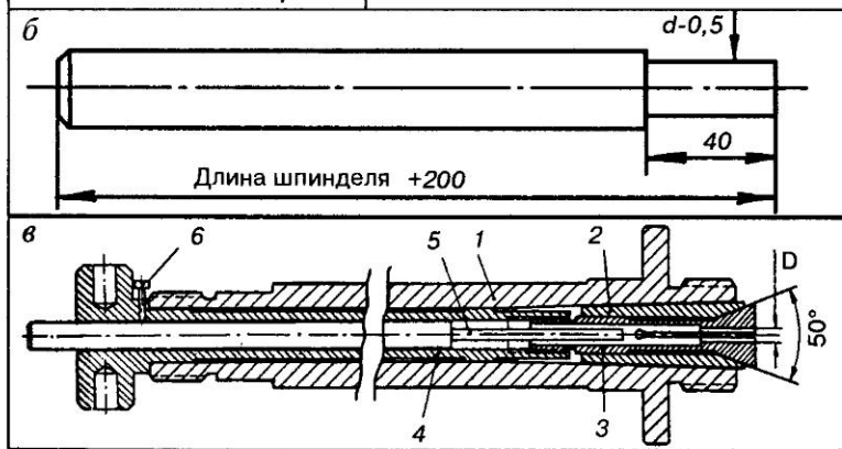
Рис. 119. Варианты конструкции цангового патрона: а) 1 — шпиндель; 2 — промежуточная гильза; 3 — цанга; 4 — зажимная гайка; б — стержень; в) 1 — шпиндель; 2 — промежуточная гильза; 3 — цанга; 4 — зажимающий стержень; 5 — установщик заготовок; 6 — фиксирующий винт; D — номинальный диаметр цанги
