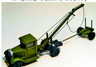
Кран для укладки труб с прицепом на шасси ЗИС-5 (ИИИ)
