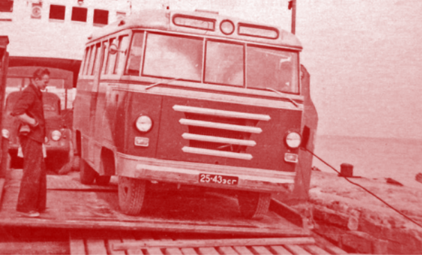
КАГ-3 второй серии в весьма редком исполнении грузового фургона с наращенной крышей. Москва, кон. 1960-х гг.
