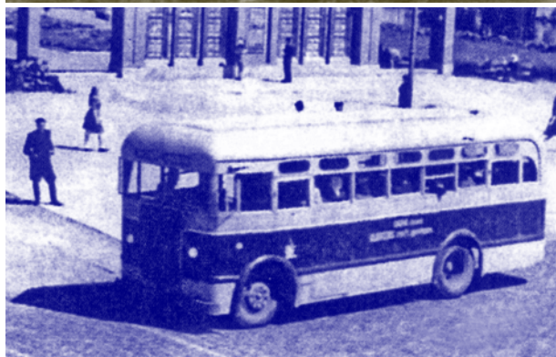
Автобус Л-1 с деревяннометаллическим кузовом производится на КАГ, внешне отличившийся от ленинградского оригинала АТУЛ. Каунас, нач. 1950-х гг.
