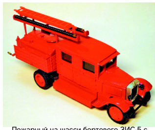
Пожарный на шасси бортового ЗИС-5 с двухрядной кабиной (ИИИ)
