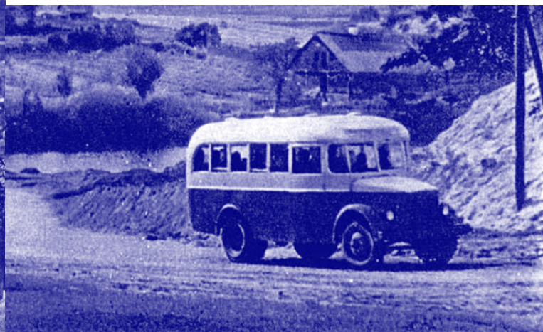
Капитальный 19-местный автобус КАГ-1 на шасси ГАЗ-51 также выпускался по образцу и подобию горьковского автобуса ГЗА-651, но имел иную заднюю часть кузова. 1952
