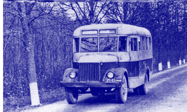
Поздние исполнения КАГ-1 имели более простые лобовые стёкла. 1955
