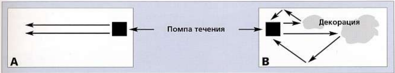
Типы течения: А = ламинарное, В = турбулентное; направление течения показано стрелками.
