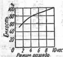
Фиг. 39. Зависимость емкости кислотного аккумулятора от режима разряда.
