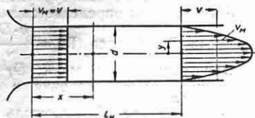
Фиг. 41. Ламинарный поток в круглой трубе.
