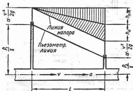
Фиг. 34. Эпюра высот при неустановившемся движении реальной жидкости.
