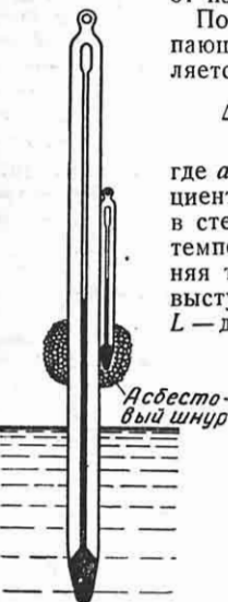
Фиг. 1. Расположение термометров при внесении поправки на выступающий столбик.
