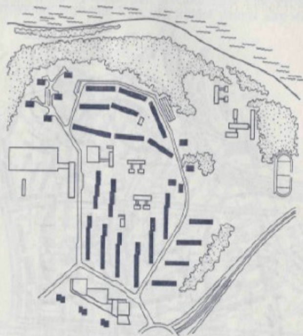
Рис. 2.4. Пример строчной планировки микрорайона Д-25 жилого района Жирмунай в Вильнюсе
