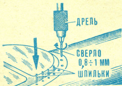
Рис. 2. Крепление фонаря кабины к фюзеляжу.
