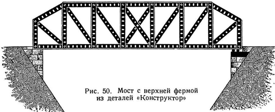
Рис. 50. Мост с верхней фермой
