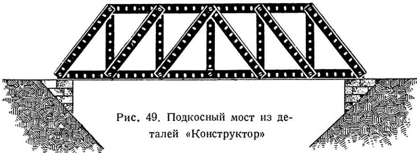
Рис. 49. Подкосный мост из деталей «Конструктор»
