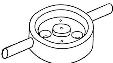
Рис. 59. Литниковая часть колесной формы
