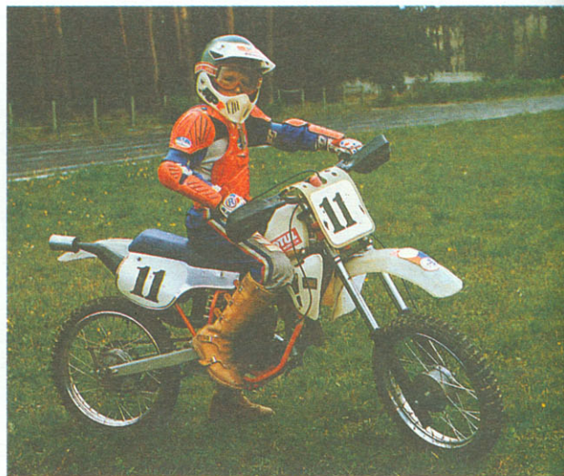
Этот подростковый мотоцикл [разработчик Д. Степанов из латвийского города Цесис] предназначен для кроссовых соревнований. Ходовые качества машины в значительной степени определяются оригинальными конструкторскими решениями — в их числе жидкостное охлаждение двигателя и дисковые тормоза.
