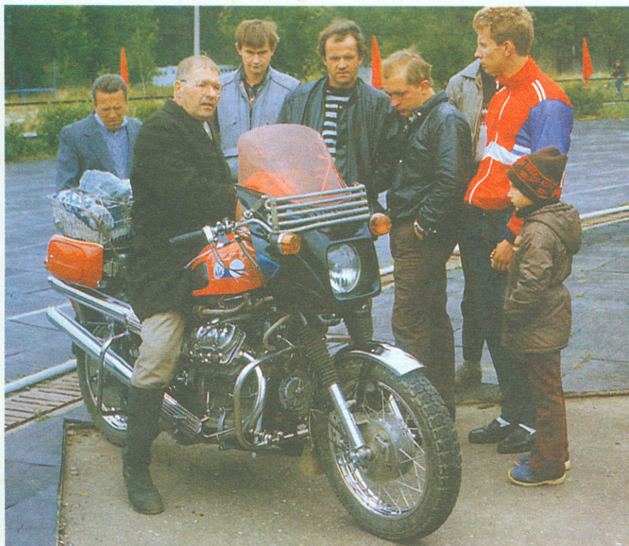
Мотоцикл класса «гран-туризмо», оснащенный двигателем от «Запорожца» [автор В. Пугачев, Москва], постоянно был в центре внимания.
