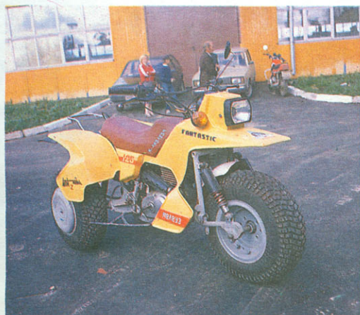
Необычная конструкция задней подвески трицикла «Фантастик» [работа коллектива СЮТ г. Мелеуз, руководитель О. Чельшев] позволяет ему наклоняться на поворотах (фото слева).
