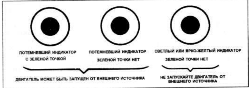
3.5b Индикатор степени заряженности необслуживаемого аккумулятора Delco
