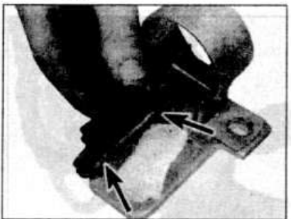
7.4 Модуль зажигания и монтажная пластина (установочные штифты отмечены стрелками)
