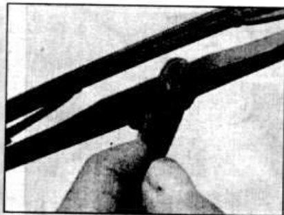
15.3 Снятие лопасти стеклоочистителя
