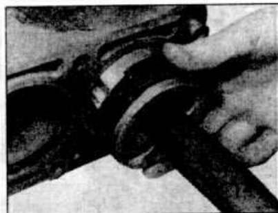
11.14 Установка поршня в блок цилиндров
