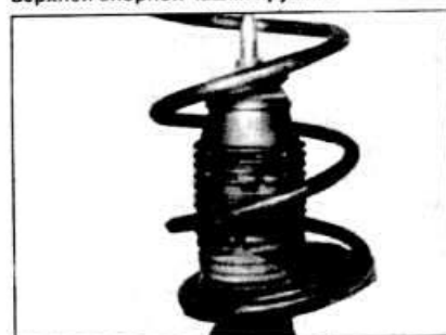
4.7 Защитный кожух стойки
