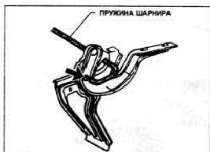
29.4 Шарнир крышки багажника и пружина Выпустите пружину из отверстия (отмечено стрелкой)
