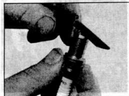
25.10a Измерение межэлектродного зазора свечи зажигания, используя щуп
