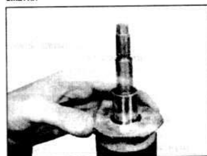
4.9b Снятие поджимной гайки
