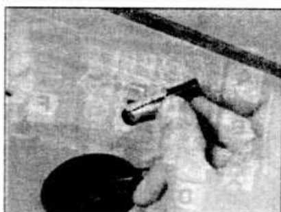
4.19a Снятие светового выключателя багажника (Универсал)
