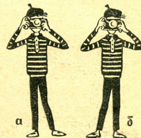
РИС. 2. Способ стереофото съемки с рук.
