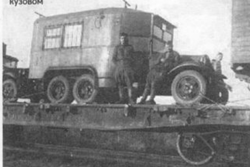
Радиофургон на шасси ГАЗ-ААА довоенного производства с более объёмным, нежели «05-193» кузовом
