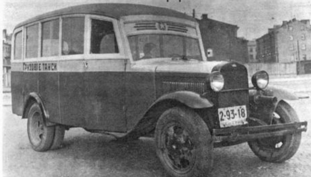
12-местное грузотакси на шасси ГАЗ-АА, изготовленное на АРЗ № 2 АТУЛ в 1935 г.
