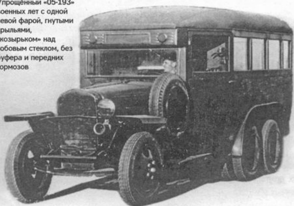
Радиофургон на шасси ГАЗ-ААА довоенного производства с более объёмным, нежели «05-193» кузовом
