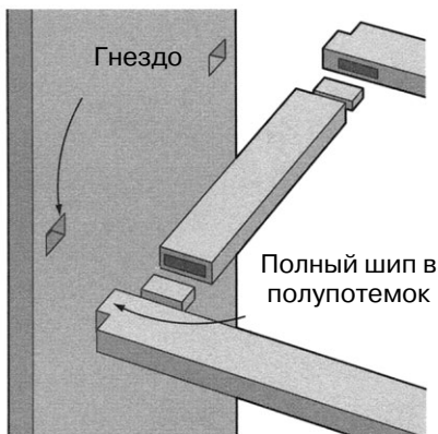
Вставной шип с гнездом
