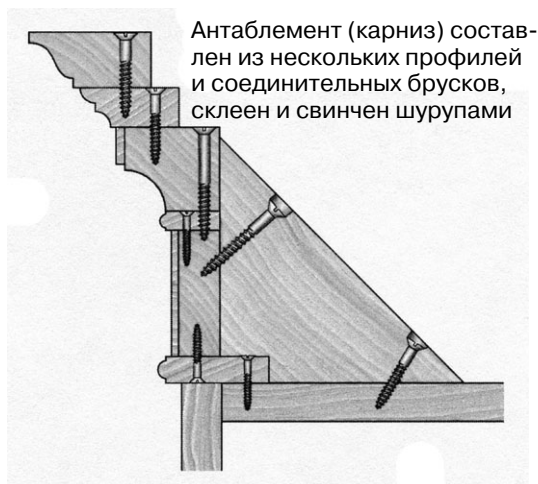
Конструкция антаблемента
