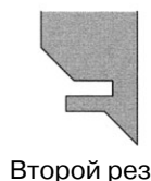
Замковое соединение со скосом (на ус)
