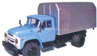
фургон изотермический ЛумЗ-890Б на шасси ЗИЛ-130 (ДНК)
