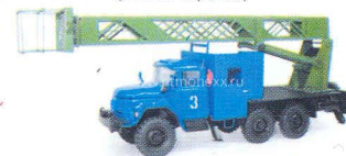
вышка телескопическая ВТ-26 на базе ЗИЛ-131 (конверсия)
