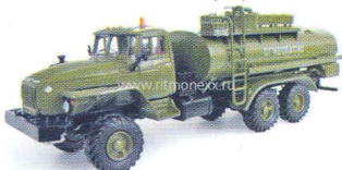
топливозаправщик АТЗ-10М на шасси Урал-4320-0911 (ДиК)
