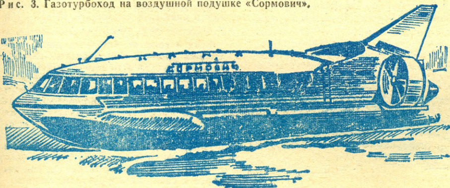
Рис. 3. Газотурбоход на воздушной подушке «Сормович».
