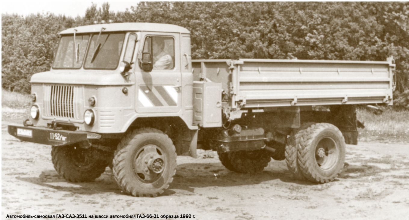
Автомобиль-самосвал ГАЗ-САЗ-3511 с надставными бортами на шасси автомобиля ГАЗ-66-31 образца 1992 г.
