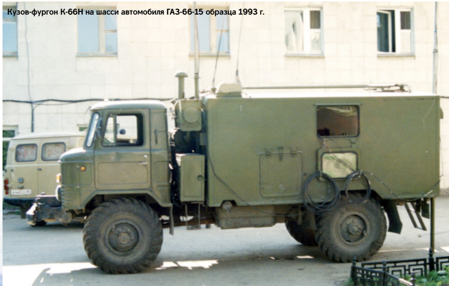
Кузов-фургон К-66Н на шасси автомобиля ГАЗ-66-15 образца 1993 г.
