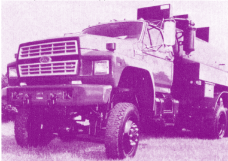
Ford FT900 (6x6) с передним ведущим мостом Marmon-Herrington. Конверсия компании Manning для ВМС США (1990)
