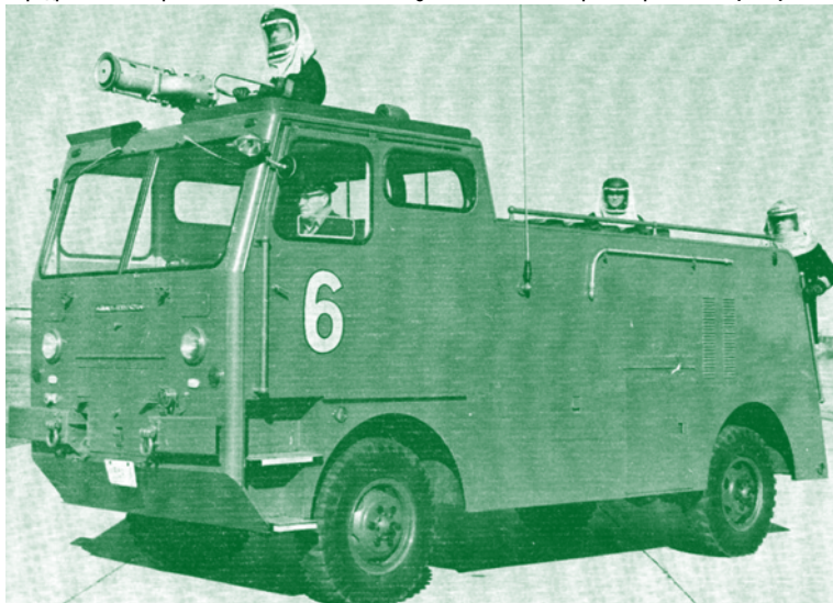
Marmon-Herrington O-12 (1958) – аэродромный пожарный автомобиль для ВВС США. Его полный вес 31 т, мощность двигателя 810 л.с. Ещё один двигатель мощностью 500 л.с. приводил в действие водяной насос
