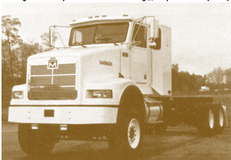
Marmon SB90L (6x6) с передним ведущим мостом Marmon-Herrington (1995). Шасси создано по заказу из Саудовской Аравии для монтажа мобильного дома
