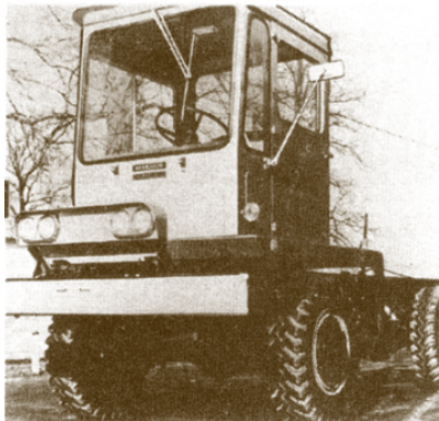
Строительное шасси Marmon-Herrington (1973) - последний автомобиль оригинальной конструкции этой марки
