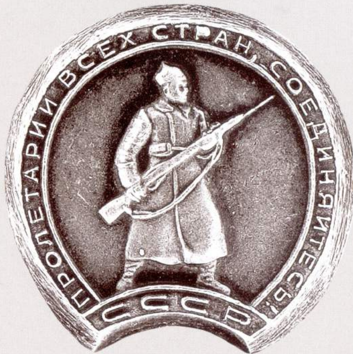
Медальоны орденов Красной Звезды, изготовленные изношенными штампами. Слева – медальон ордена № 1790645, в надписи «Пролетарии всех стран, соединяйтесь!» запятая превращается практически в точку. Справа – медальон ордена № 2767158 с характерным дефектом в виде небольшой выпуклой черточки после запятой в надписи «Пролетарии всех стран, соединяйтесь!» и дефектной буквой «р» в слове «стран».
