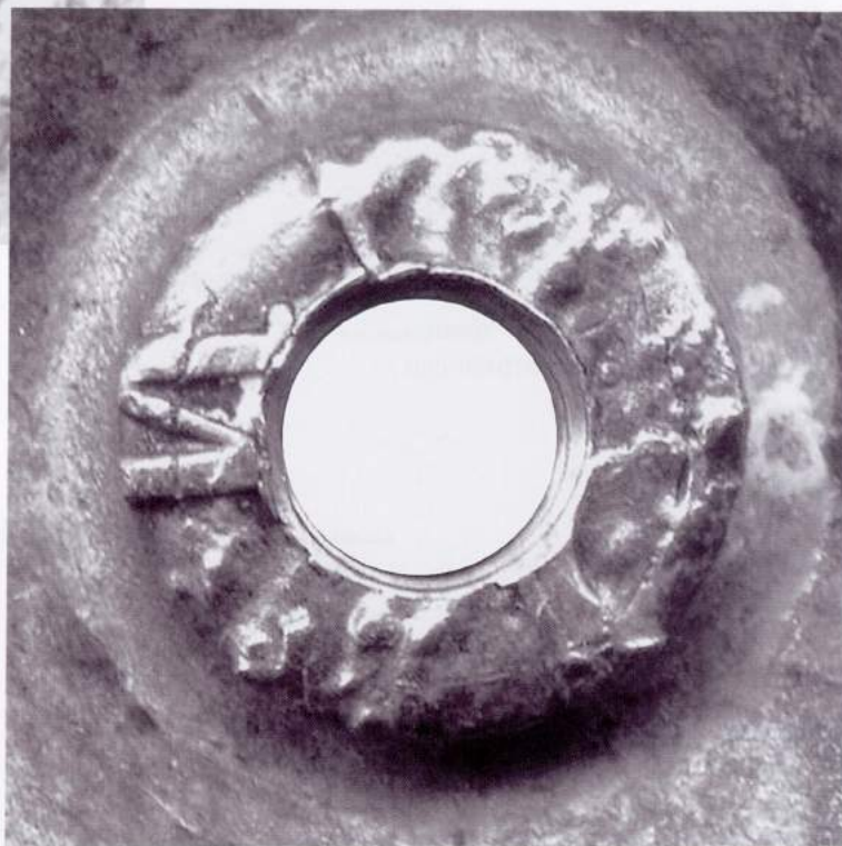
Шайбы гаек типа 2, варианта 2, вырубленные из забракованных серебряных медалей.
