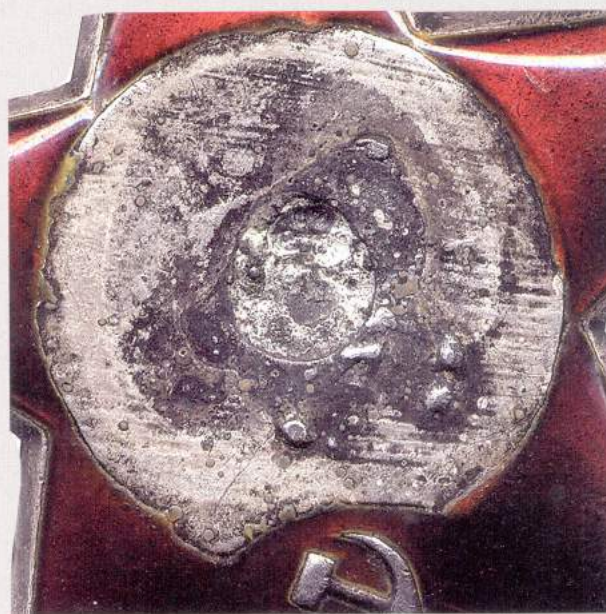
Новое крепление винта без фланца к орденам изготавливаемым на Московском монетном дворе с 1943 г. Винт запрессовывался в просверленное в центре сквозное отверстие и припаявался с лицевой стороны.
