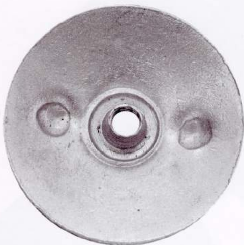
Гайка типа 4, варианта 1, разновидности 2 без конусообразного углубления с выпуклой стороны гайки. Круглое, кольцеобразное углубление вокруг ниппеля – более глубокое и маленького диаметра.
