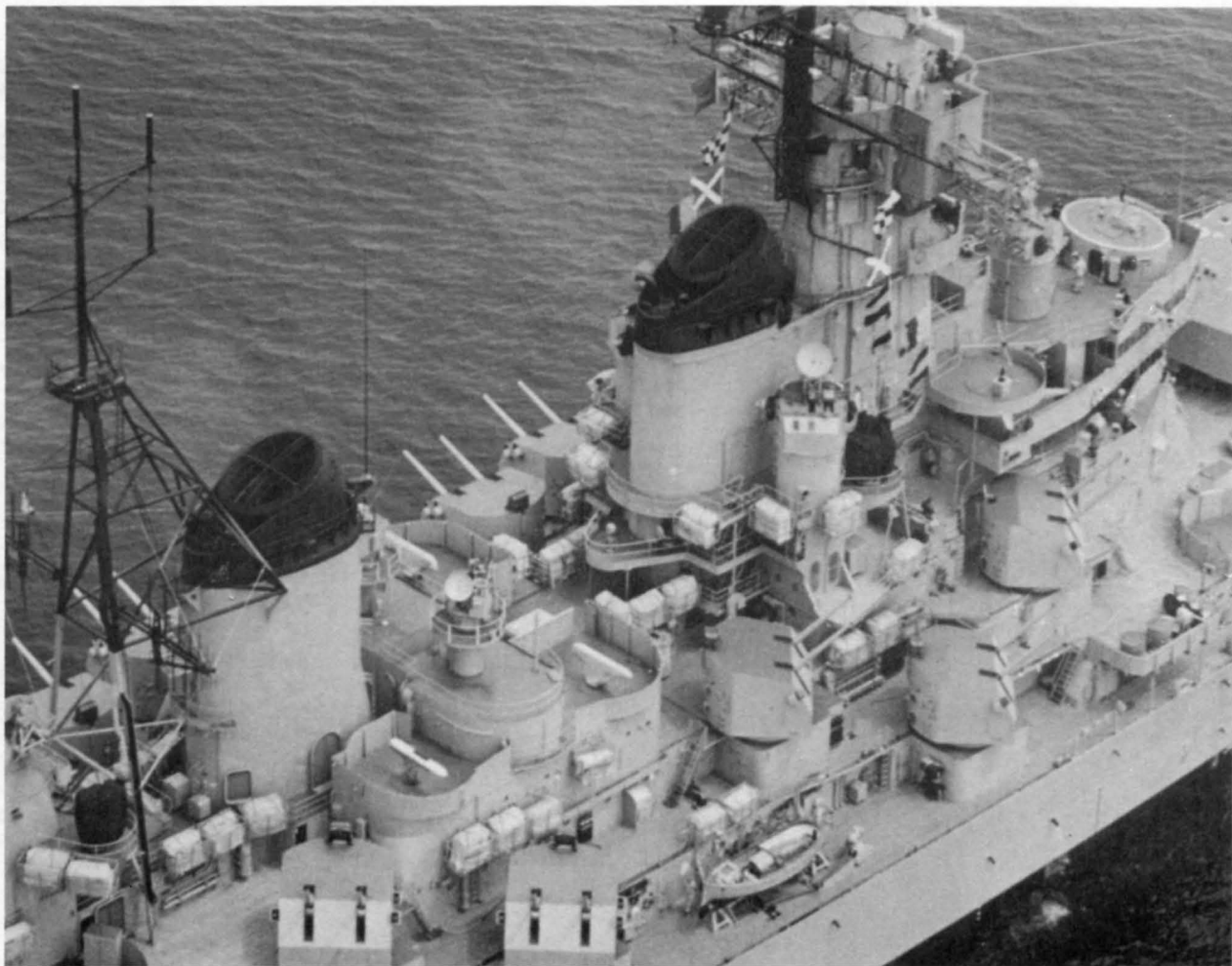
Линкор «Нью-Джерси», 20 апреля 1968 г. Обратите внимание на пусковые установки системы радио- электронной борьбы ULQ-6, смонтированные на площадках в центральной части надстройки вместо 40-мм «бофорсов»
