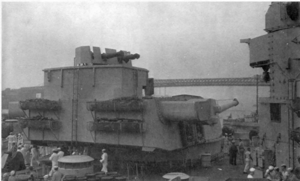
Кормовая башня ГК линкора «Айова» с установленным на ее крыше 40-мм четырехствольным «бофорсом», 9 июля 1943 г.
