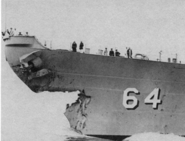
Форштевень «Висконсина» после столкновения (вверху) и носовая часть линкора «Кентакки» во время ее буксировки из Ньюпорт-Ньюс в Норфолк (слева)
