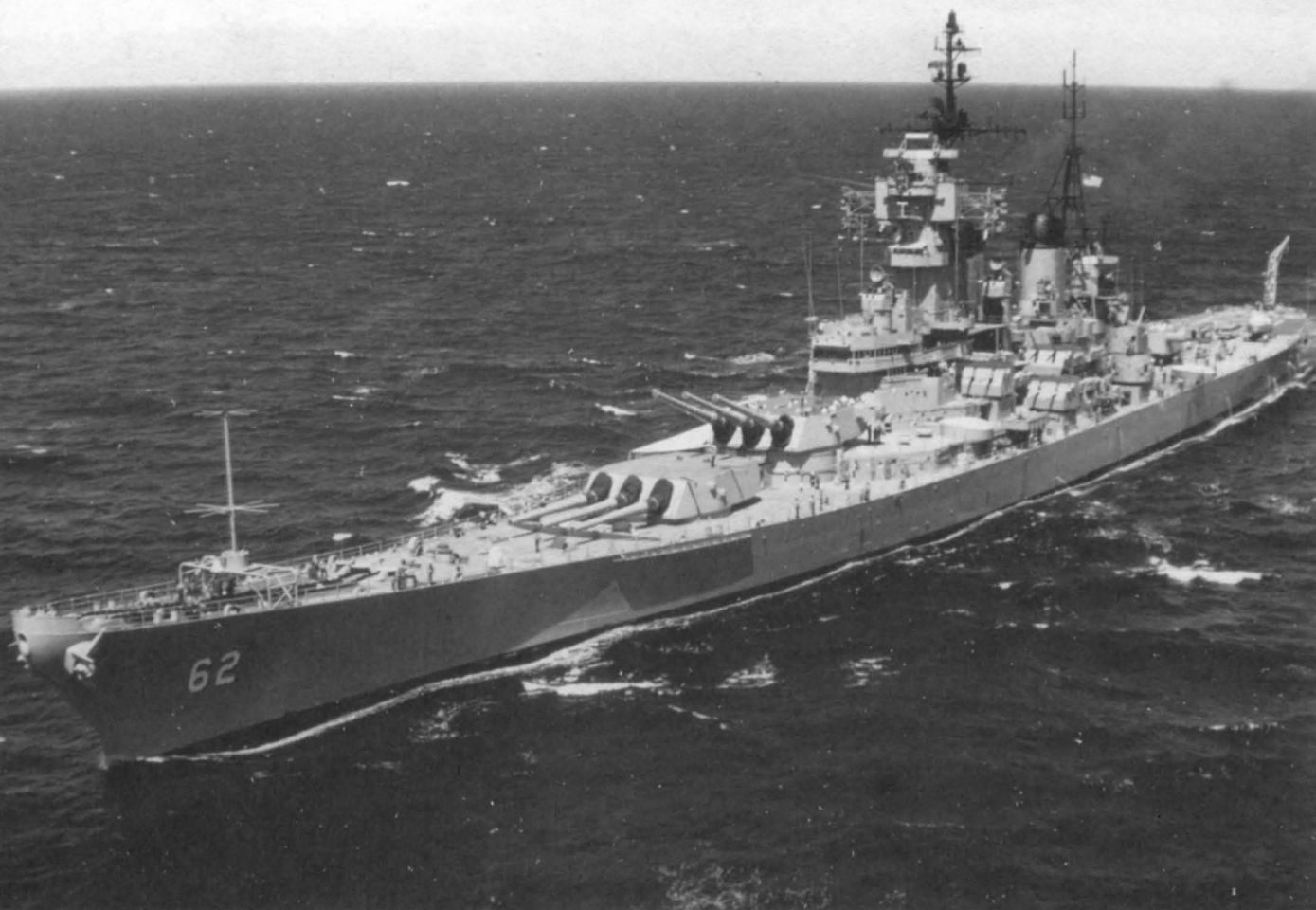
«Нью-Джерси» в сентябре 1968 г. Большая антенна в носовой части корпуса входит в состав комплекса NTDS
