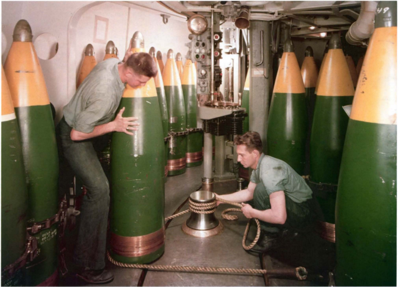
Вверху: подача 406-мм снарядов на вращающуюся кольцевую платформу башни линкора «Нью-Джерси», 9 апреля 1953 г. Внизу: «Нью-Джерси» у берегов Гавайев, 9 сентября 1968 г.
