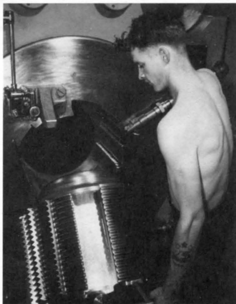
Затвор 406-мм орудия линкора «Миссури», 1944 г.
