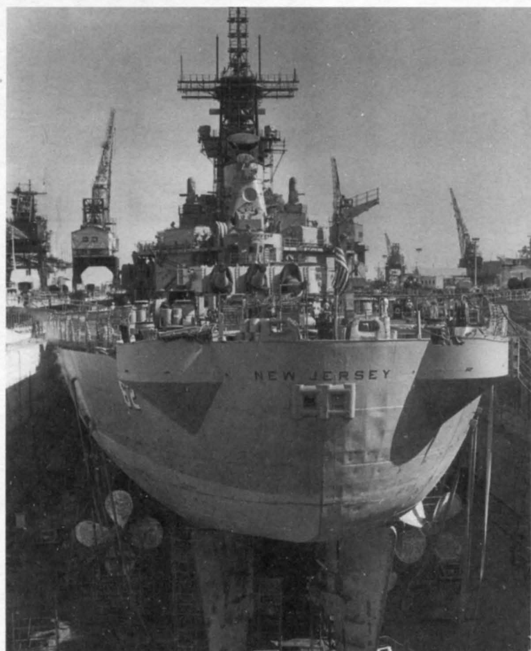
«Нью-Джерси» после модернизации. На нижнем снимке, сделанном в Лонг Биче в мае 1987 г., хорошо видны лацпорты противоторпедной системы «Никси», расположенные в корме под названием корабля
