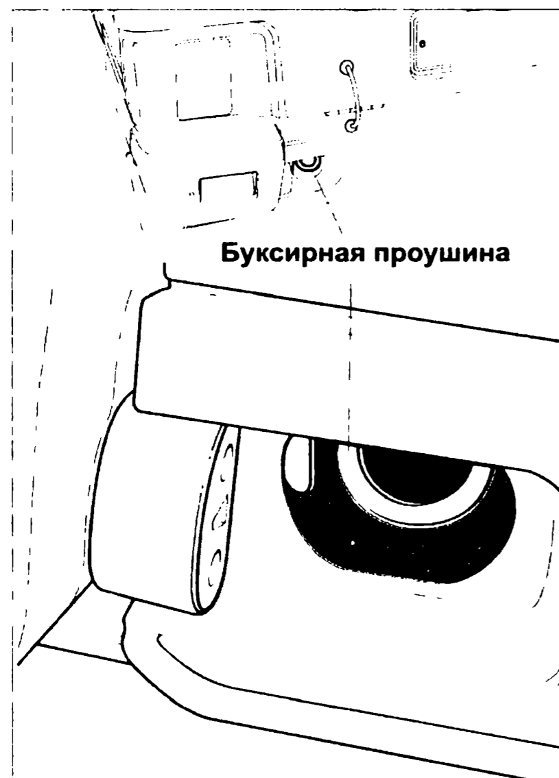
Рис.29.Задняя буксирная проушина автомобиля ИЖ-27175
