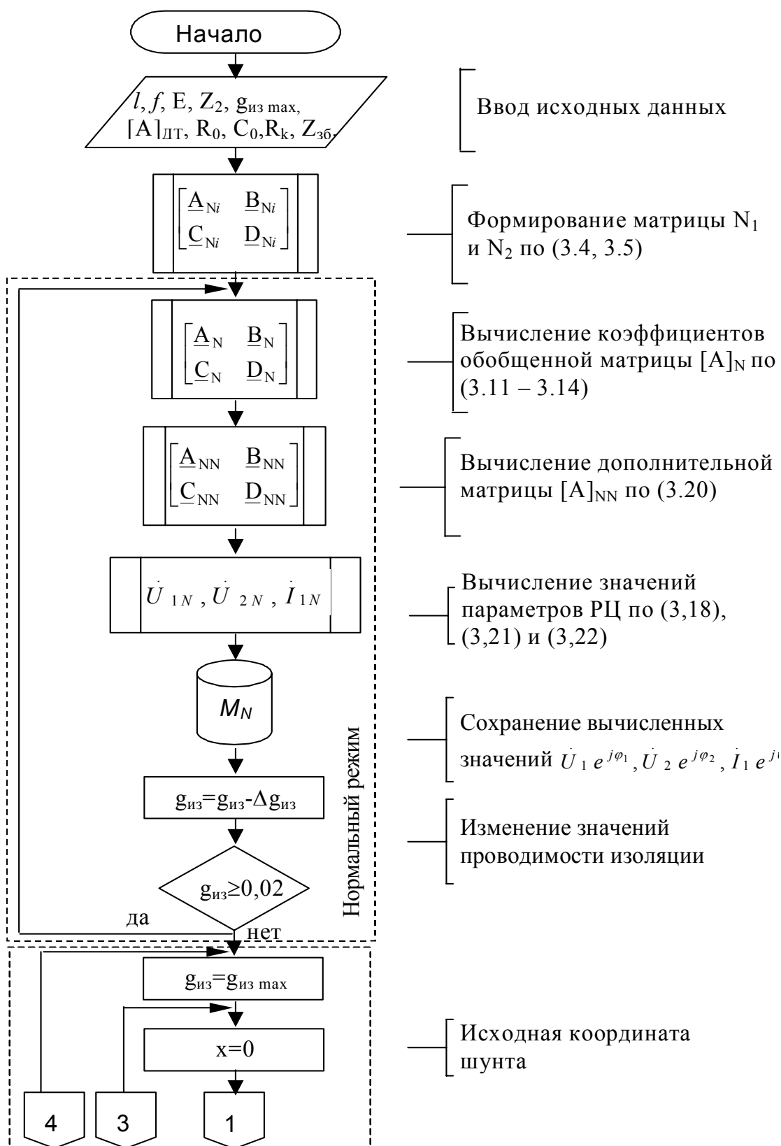
Блок – схема программы моделирования рельсовых цепей четырехполюсной схемой замещения рельсовой линии
