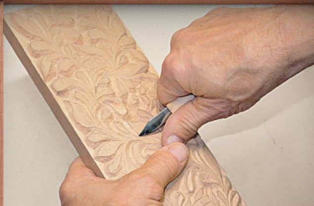
Второй способ срезания древесины ножом
