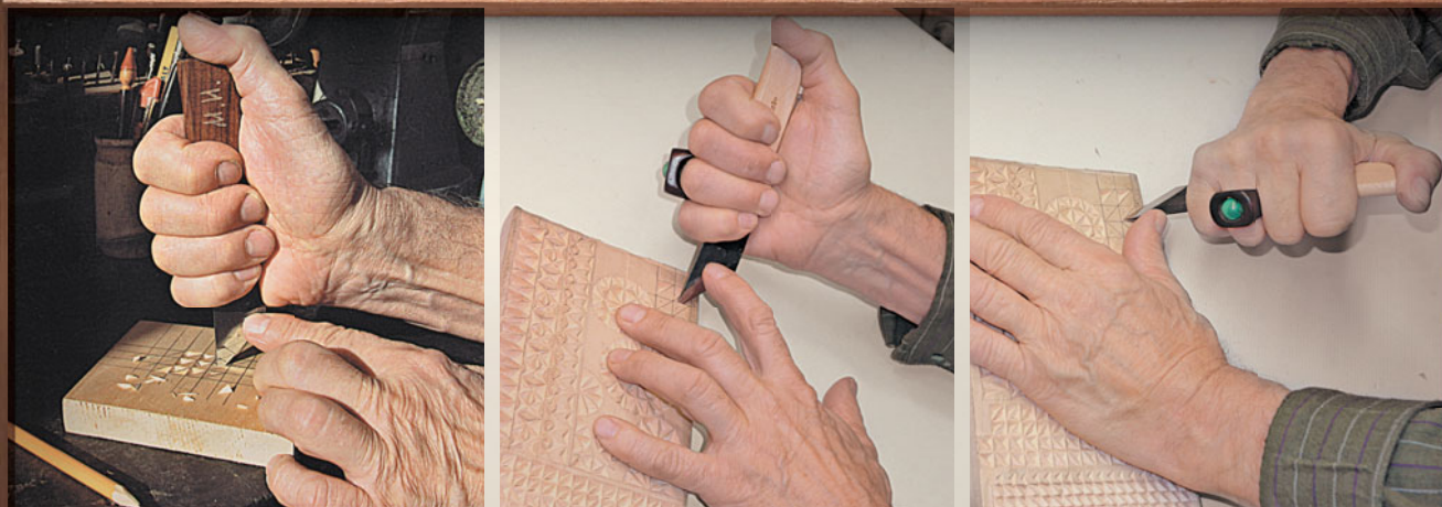
Способ держания косяка в геометрическом орнаменте. Правый подрез. Левый подрез
