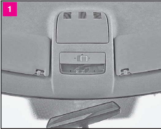
Плафон освещения салона расположен на потолке у ветрового стекла
