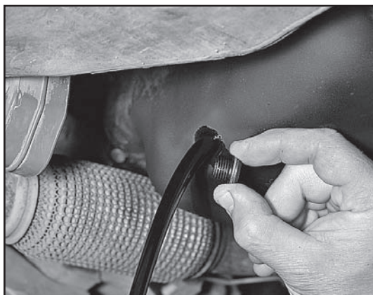
Отворачиваем пробку вручную и сливаем масло не менее 10 мин
