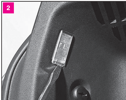
2 Лезвием шлицевой (плоской) отвертки поддеваем плафон снизу за специальную выемку
