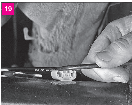
19 Освобождаем тормозную трубку из пластмассовых держателей
