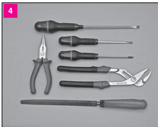
4 Отвертки: шлицевые (плоские) большая и средняя; крестообразная; пассатижи с узкими губками, пассатижи раздвижные; напильник
