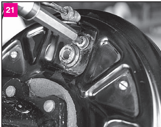
Ключом Torx T-30 отворачиваем винт крепления рабочего тормозного цилиндра к тормозному щиту
