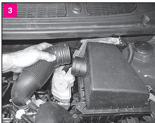
3 Покачивая воздуховод из стороны в сторону, отсоединяем его от патрубка крышки воздушного фильтра и отводим в сторону
