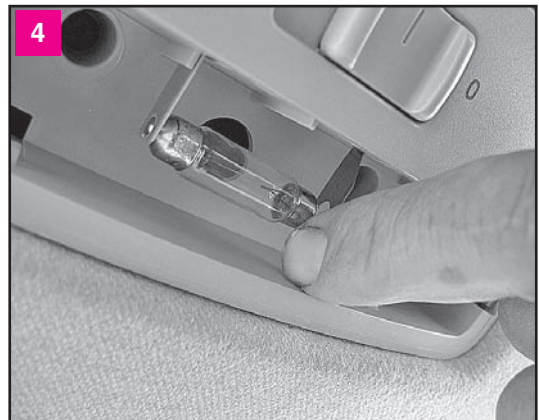
Отжимаем пружинный контакт лампы
