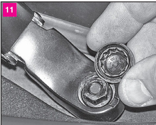
11 При установке защитного колпачка грани на его внутренней поверхности должны совпадать с гранями гайки
