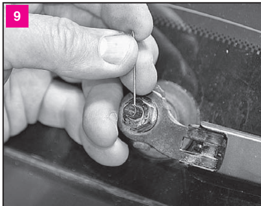
9 Тонкой иглой или булавкой прочищаем жиклер форсунки омывателя заднего стекла
