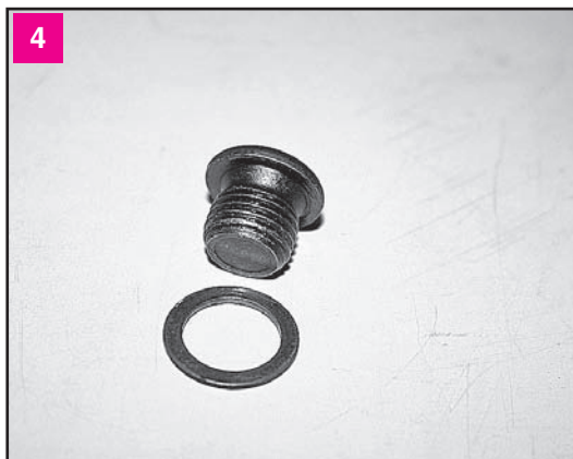
4 Пробка уплотнена медной шайбой — не потеряйте ее. Если шайба сильно деформирована или изношена, заменяем ее. После слива масла протираем пробку, заворачиваем и затягиваем ее. Удаляем потеки масла с поддона картера двигателя
