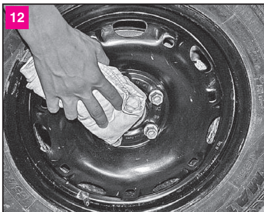
Протираем снимаемое колесо (особенно его центральную часть и головки болтов крепления) от грязи и пыли
