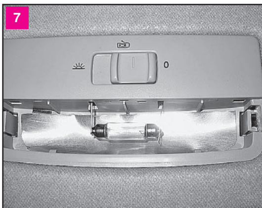
Можно сделать отражатель самостоятельно: наклеить кусок алюминиевой фольги над лампой так, чтобы фольга не касалась контактов лампы. Устанавливаем лампу в плафон и проверяем ее работу
