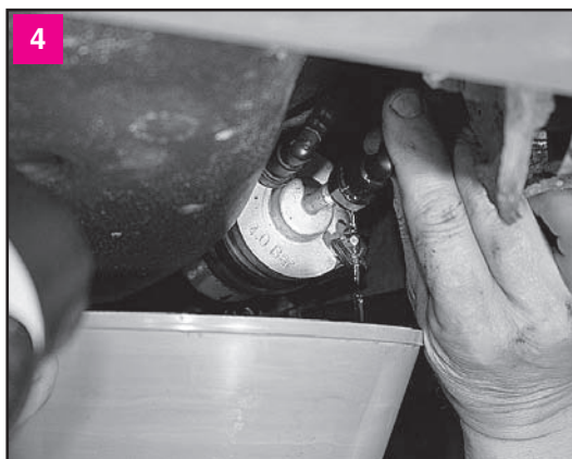
4 Подставляем под фильтр небольшую широкую емкость, затем окончательно снимаем наконечник и сливаем бензин. Для того чтобы не облиться бензином, надеваем на штуцер топливного фильтра колпачок, сняв его с нового фильтра
