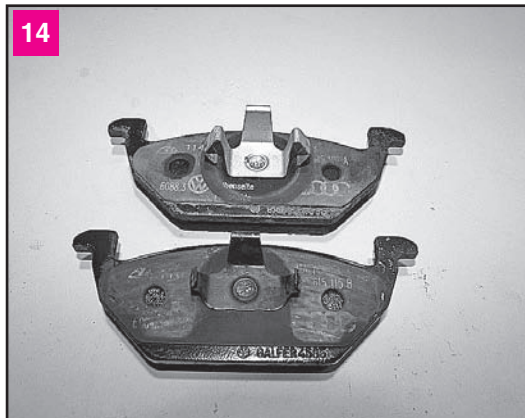
14 Комплект тормозных колодок переднего тормоза. Перед установкой новых тормозных колодок раздвижными пассатижами через деревянный брусок утапливаем поршень в цилиндр
