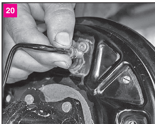
20 Отсоединяем штуцер трубки от тормозного цилиндра
