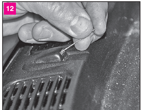
12 При необходимости тонкой иглой или булавкой прочищаем жиклер форсунки омывателя ветрового стекла
