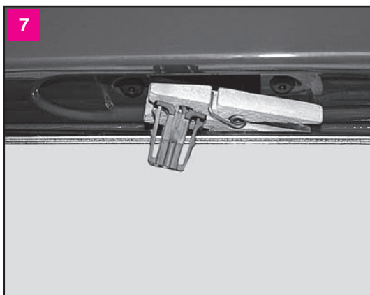
Закрепляем колодку номерного знака, иначе она упадет внутрь двери
