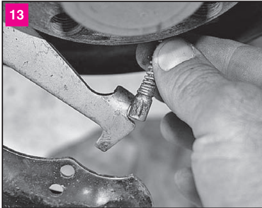
Отсоединяем наконечник троса привода стояночного тормоза от рычага
