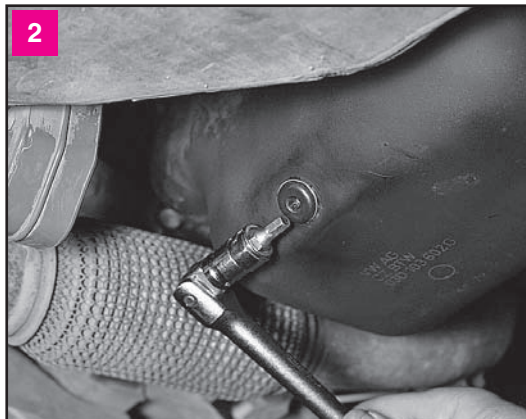
2 Снизу автомобиля очищаем от грязи поддон картера вокруг пробки сливного отверстия. Шестигранным ключом «на 6» ослабляем затяжку пробки. Подставляем под отверстие широкую емкость для слива масла объемом не менее 4 л
