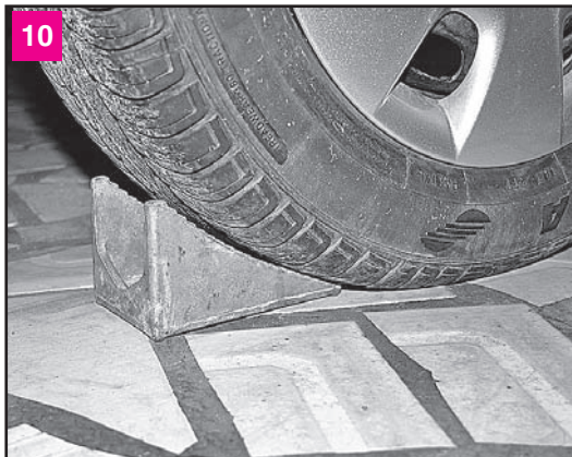
Устанавливаем противооткатный упор (лучше два) под одно из передних и одно из задних колес, которые не будут подняты
