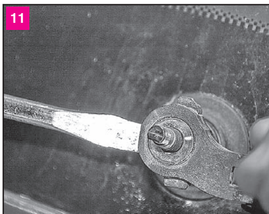
11 Вставив широкую шлицевую (плоскую) отвертку в основание поводка и стойки оси очистителя, отжимаем основание поводка
