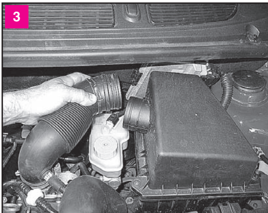
3 Снимаем воздуховод с патрубка крышки корпуса воздушного фильтра и отводим в сторону
