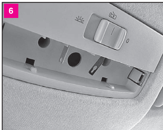
В плафоне освещения салона нет отражателя, поэтому его свет тусклый
