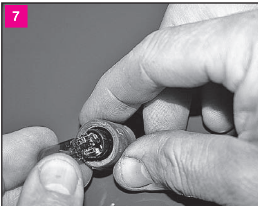
Потянув лампу за колбу, вынимаем ее из контактных зажимов патрона. Новую лампу устанавливаем в обратной последовательности
