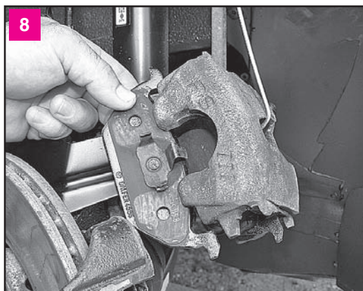
Для замены тормозных колодок поддеваем их шлицевой (плоской) отверткой и вынимаем из суппорта
