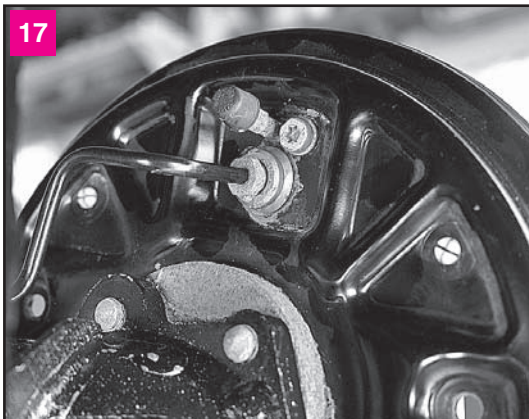
17 Очищаем от грязи наружную сторону заднего тормозного щита
