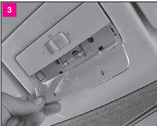
Снимаем рассеиватель плафона освещения салона
