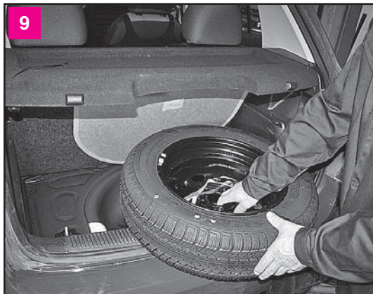
Вынимаем запасное колесо из багажника
