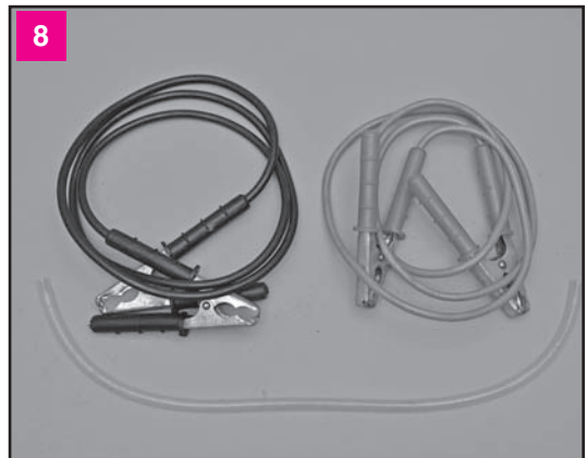
Провода для прикуривания, шланг для прокачки тормозов
