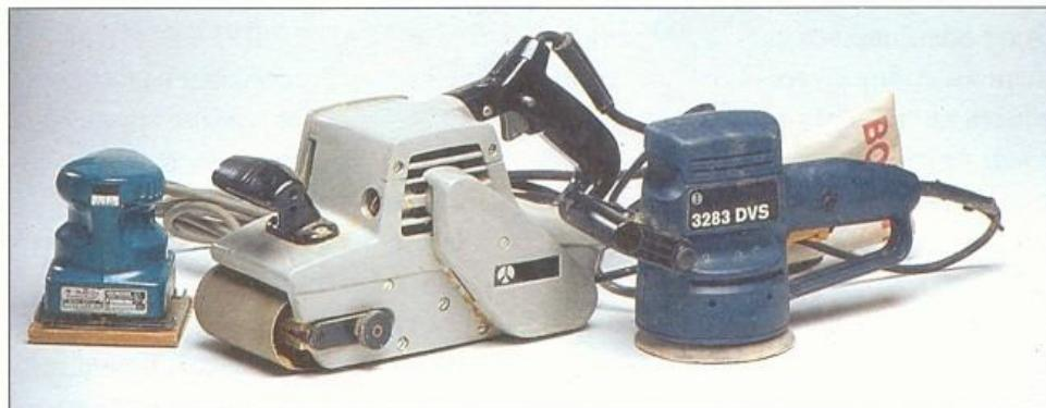
Три самых распространенных типа ручных шлифовальных машин (слева направо): дисковая машина, ленточная машина и эксцентриковая машина.
