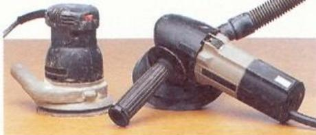
лярных размеров — на  $\frac{1}{4}$ ,  $\frac{1}{3}$  или  $\frac{1}{2}$  листа наждачной бумаги. Шлифовальными утюжками, рассчитанными на  $\frac{1}{3}$  и  $\frac{1}{2}$  листа, работают обеими руками, а моделями, рассчитанными на  $\frac{1}{4}$  листа, работают одной рукой. Утюжок шлифует по кругу, когда требуется быстро удалить излишок материала, или по прямой, когда требуется тонкая обработка. В некоторых моделях можно переключаться на тот или иной режим.
