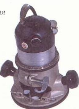
Фрезерная машина с заглублением фрезы
