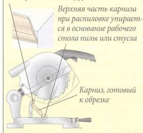
его под углом, прикрепите к направляющей планке ограничитель. Ограничитель представляет собой рейку квадратного сечения —  $\frac{3}{4} \times \frac{3}{4}$  дюйма (19 × 19 мм), прикрепленную зажимом или шурупами.
