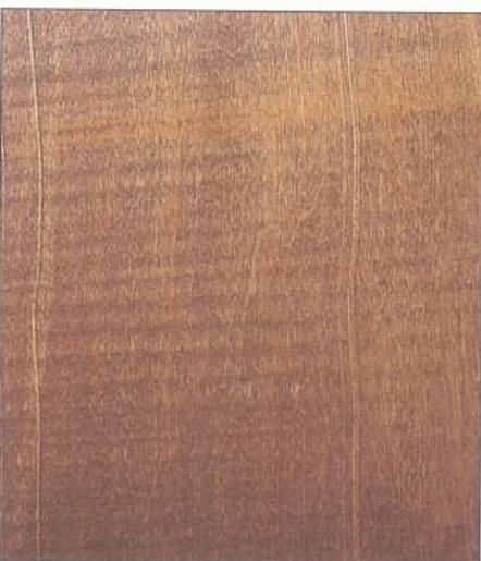
Любые электроинструменты оставляют на дереве следы, которые следует удалить наждачной бумагой. Показанная на иллюстрации волнистость обусловлена рубанком или фуганком.
