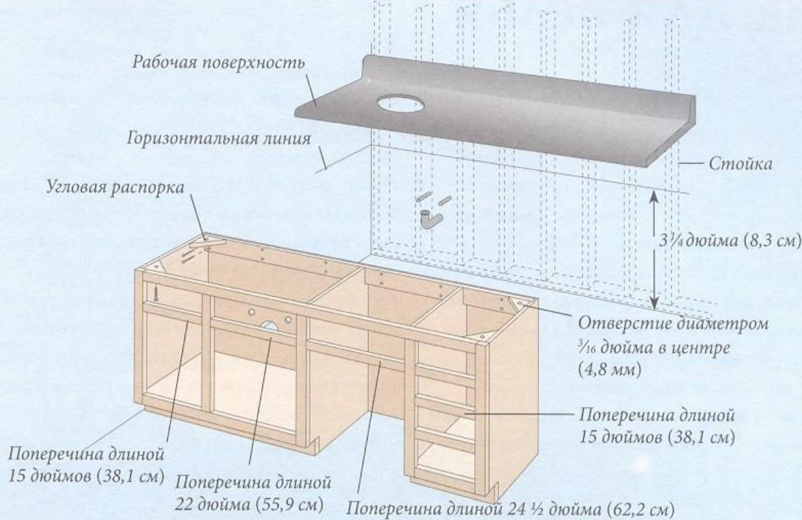
линию на высоте  $31 \frac{1}{4}$  дюйма (79,4 см) от самой высокой точки пола, как показано на рисунке «Установка туалетного столика». Установите столик на предназначено для него место и выровняйте его по горизонтали, при необходимости используя деревянные подкладки.
