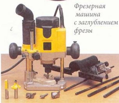
прямой, снабжены упорами, ведущими фрезу вдоль кромки. На концах у некоторых фрез есть ролики, идущие вдоль кромки деревянной заготовки. Имеются фрезы с фиксированными направляющими устройствами, вращающимися вместе с фрезой. Они дешевле, однако края дерева часто обугливаются из-за трения о вращающуюся направляющую.
