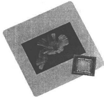
РИС. 3.5. Типичный датчик изображения намного меньше кадра 35-миллиметровой пленки
