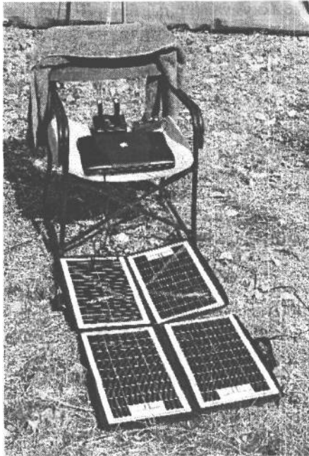
РИС. 5.3. Переносные солнечные батареи позволяют перезаряжать батареи фотокамеры и питать портативный компьютер во время съемок вдали от мест подключения к электросети. Приведенные здесь панели солнечных батарей на 12 В размером с портативный компьютер использовались фотографом Кевином Эймсом во время съемок в Африке. Фото Кевина Эймса
