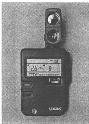
РИС. 7.3. Ручной экспонометр с насадкой для местных измерений в пределах поля зрения 50
