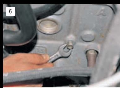
6 Ключом «на 13» с левой стороны двигателя отворачиваем пробку сливного отверстия и сливаем из блока цилиндров оставшуюся жидкость.
