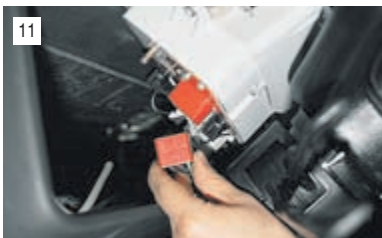
...и соединительные колодки от выводов комбинации приборов.
