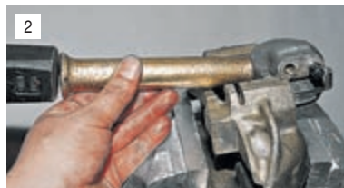
...выколоткой из мягкого металла выбиваем колесный цилиндр из суппорта.
