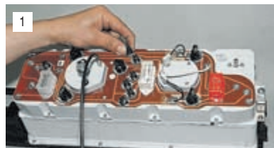
1 Повернув против часовой стрелки патрон лампы,...
