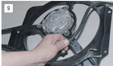
Отсоединяем крепление жгута проводов.
