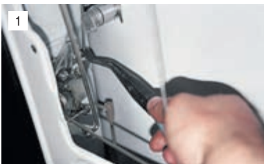
1 У передней двери круглогубцами или шлицевой отверткой снимаем с тяги конец резинового фиксатора и выводим тягу из отверстия в замке.
