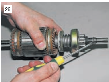
26 Поддев отверткой, снимаем стопорное кольцо.
