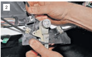
2 ...и отсоединяем от рычага тягу.
