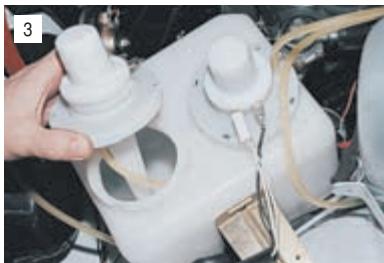
Снимаем шланг со штуцера.
