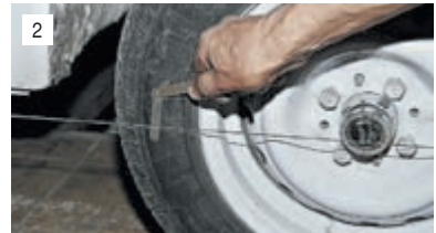
При правильно отрегулированном сходимости нити на задней части передних колес должны только слегка касаться боковины.
