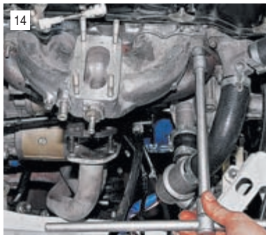
Головкой «на 13» отворачиваем семь гаек крепления коллектора...
