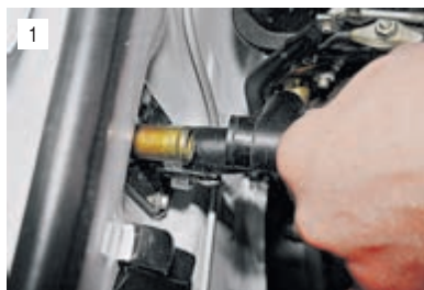
Отверткой ослабляем затяжку хомутов и снимаем шланги с труб радиатора.
