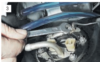
Ключом «на 7» отворачиваем шесть гаек...
