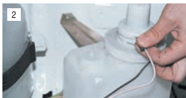
2 Снимаем наконечник провода с вывода «+» электродвигателя насоса (на крышке электродвигателя указана полярность) и наконечник провода «массы» с вывода «минус».
