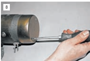
Для дальнейшей разборки стартера крестообразной отверткой отворачиваем два винта...
