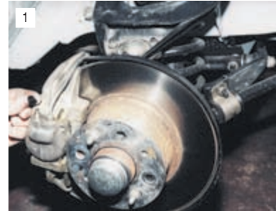
Снимаем резиновый защитный колпачок с прокачного штуцера правого колесного цилиндра.
