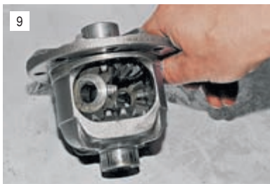
9 Проворачиваем шестерни полуосей и вынимаем шестерни-сателлиты.
