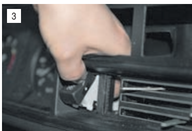
Вынимаем переключатель отопителя.
