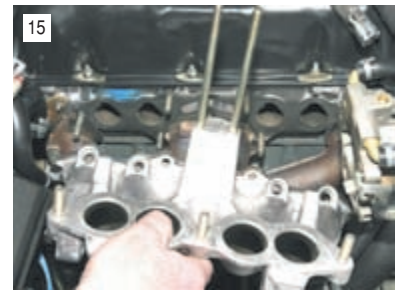
15 ...снимаем впускную трубу со шпилек головки блока цилиндров.
