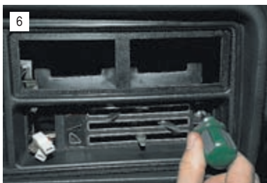
Крестообразной отверткой отворачиваем саморез крепления щитка приборов.
