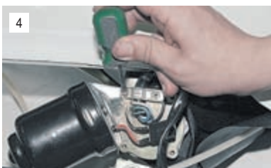
Отворачиваем винт скобы крепления жгута проводов...
