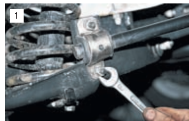
1 Ключом «на 13» отворачиваем две гайки крепления обоймы стабилизатора к нижнему рычагу.
