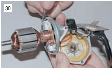
С торцов щеткодержателя вставляем на свои места пружины и загибаем отогнутые стенки щеткодержателей.
