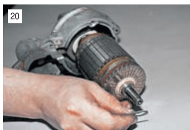
20 Снимаем с вала якоря регулировочную шайбу. При сборке ее необходимо установить на место.
