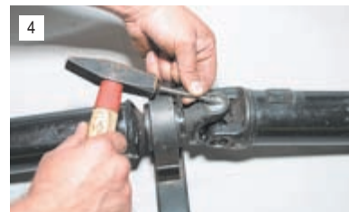
4 После сборки шарнира легкими ударами молотка через отвертку или бородок «помогаем» стопорному кольцу расправиться и полностью войти в проточку.
