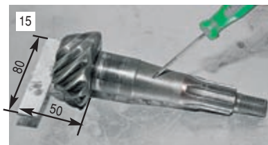
15 Привариваем пластину длиной 80 мм и торцуем ее в размер 50_{-0,02} мм относительно плоскости под подшипник. На конической части вала выгравирован заводской номер и отклонение в размере.
