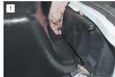
Изнутри багажника отворачиваем две пластмассовые гайки и снимаем крышку фонаря.
