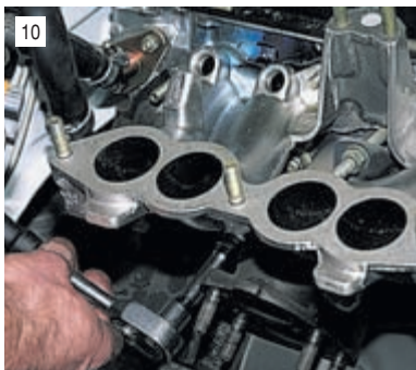
10 Высокой головкой «на 13» с удлинителем отворачиваем две гайки нижнего общего крепления впускной трубы и выпускного коллектора.
