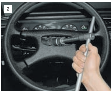
Головкой «на 24» отворачиваем гайку крепления рулевого колеса, оставив ее на валу заподлицо,...
