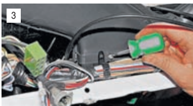
3 Крестообразной отверткой отворачиваем два самореза крепления верхних воздухопроводов к кожуху вентилятора...
