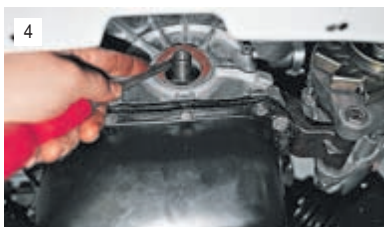
Поддеваем отверткой переднюю манжету коленчатого вала...
