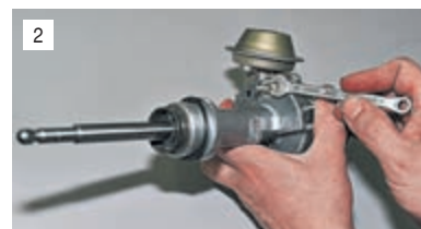
2 Ключом «на 7» отворачиваем гайку контакта низкого напряжения,...
