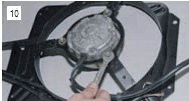
Ключом «на 10» отворачиваем три гайки,...
