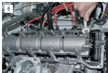
Ключом «на 13» отворачиваем девять гаек крепления корпуса подшипников распределительного вала.
