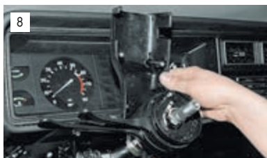
8 Снимаем верхнюю половину кожуха, не потеряйте резиновое кольцо с выключателя зажигания.
