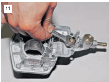
11 Ключом «на 10» отворачиваем седло клапана.
