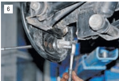
6 Ключом «на 8» отворачиваем два болта крепления оболочки троса к тормозному щиту и...
