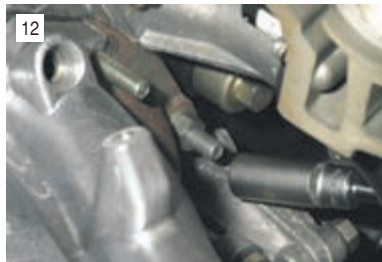
12 Высокой головкой «на 13» отворачиваем гайку переднего крепления выпускного коллектора.
