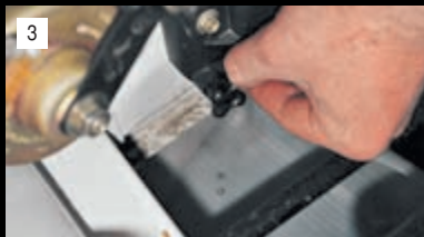
3 Отворачиваем пробку сливного отверстия, расположенную в нижнем левом углу радиатора,...
