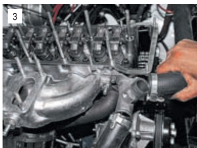
Снимаем шланги с двух патрубков головки блока цилиндров.
