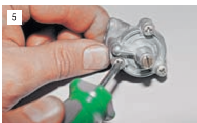
5 ...крестообразной отверткой отворачиваем три винта...
