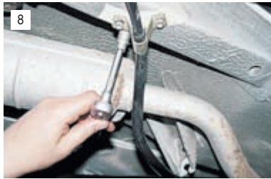
8 Ключом «на 10» отворачиваем две гайки крепления скобы троса к кузову и,...
