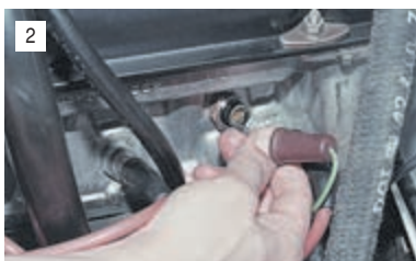
Отсоединяем наконечник провода от вывода датчика.
