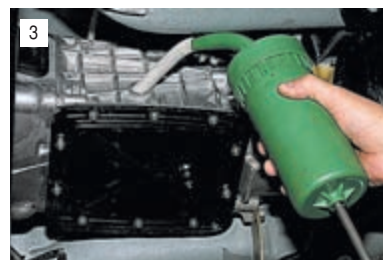
Шприцем заливаем новое масло до уровня нижней кромки заливного отверстия.
