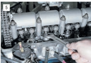
5 Для регулировки зазора ключом «на 17» ослабляем затяжку контргайки регулировочного болта.
