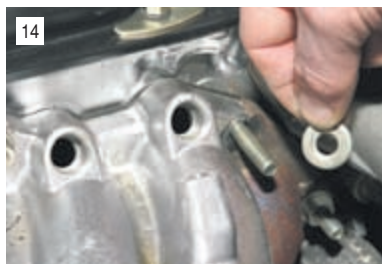
14 В четырех местах стыковки впускной трубы и выпускного коллектора на шпильках установлены утолщенные шайбы.
