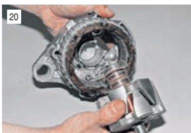
Ротор снимается вместе с подшипником.
