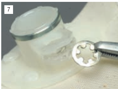
7 Вынимаем из прорези фильтра стопорную шайбу, крепящую фильтр на штифте насоса.
