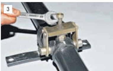
3 Приспособлением, через подходящую проставку, запрессовываем подшипник в вилку глубже проточки под стопорное кольцо.
