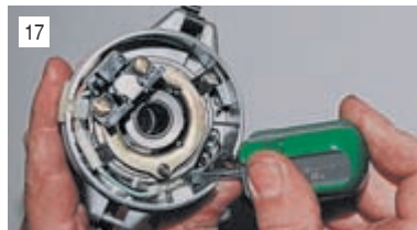
Перед установкой вакуумного регулятора аккуратно укладываем проводку датчика.
