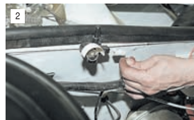
...отсоединяем наконечник провода.
