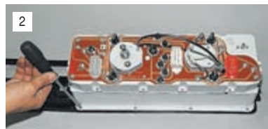
Отворачиваем четыре самореза крепления комбинации к щитку.
