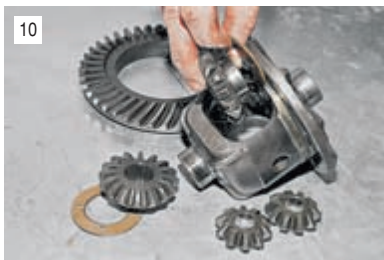
10 Вынимаем шестерни полуосей с регулировочными шайбами, пометив их положение.
