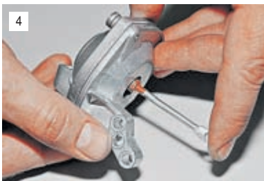
4 Надавлив на шток диафрагмы, закрываем пальцем входное отверстие.
