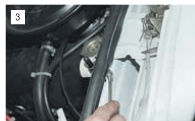
Ключом «на 8» отворачиваем гайку крепления выключателя к передней панели кузова и...
