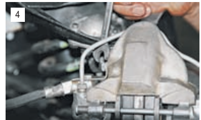
4 Ключом «на 10» отворачиваем болт крепления скобы, фиксирующей тормозной шланг, и...
