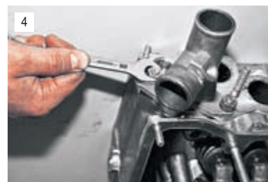
Ключом «на 13» отворачиваем две гайки крепления двойного патрубка...
