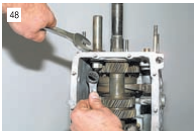
Накидным ключом «на 19» отворачиваем гайку крепления оси промежуточной шестерни заднего хода, удерживая ось от проворачивания ключом «на 24».
