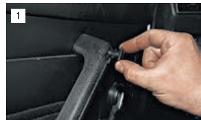
1 Поддев отверткой, вынимаем заглушку подлокотника.
