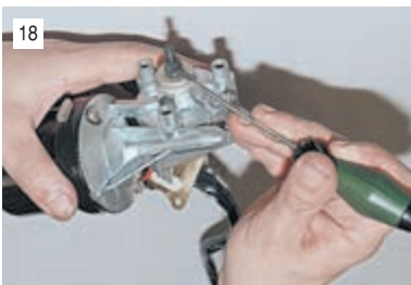
18 Поддев отверткой, снимаем стопорное кольцо,...
