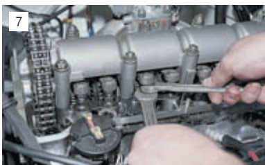
7 Вынимаем щуп и, удерживая ключом регулировочный болт, вторым ключом затягиваем контргайку.
