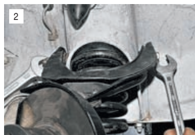
2 Двумя ключами «на 22» отворачиваем самоконтращуюся гайку оси рычага.
