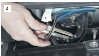
...и аккуратно вынимаем датчик из бака.
