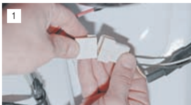
1 Разъединяем соединительную колодку проводов моторедуктора, расположенную на питающем проводе (см. «Замена предохранителей», с. 141).
