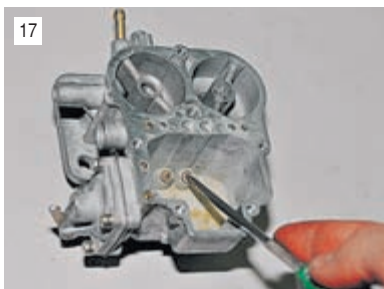
17 Отворачиваем главные топливные жиклеры.
