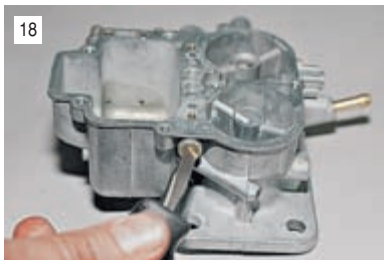
18 Отворачиваем корпус топливного жиклера переходной системы.
