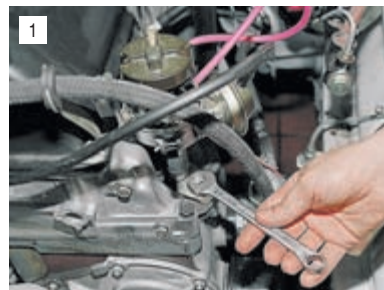
1 Ключом «на 13» ослабляем затяжку гайки крепления стопорной пластины.
