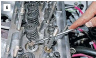
8 Отверткой поддеваем и снимаем маслоотражательный колпачок с направляющей втулки.
