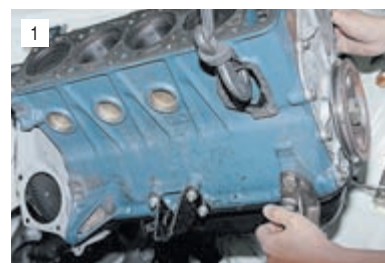
1 Закрепляем тросы подъемного устройства на блоке и приподнимаем его. Установив домкрат под коробку передач и слегка покачивая блок, разъединяем двигатель и картер сцепления.
