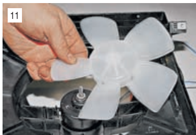
11 ...затем крыльчатку вентилятора.
