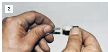
2 Для замены неисправной лампы вынимаем ее из патрона.
