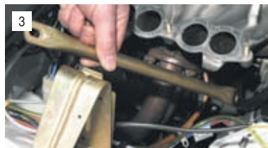
Снимаем передний опорный кронштейн.
