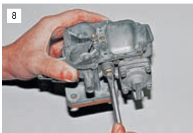
8 Отверткой с широким лезвием отворачиваем корпус топливного жиклера системы холостого хода.
