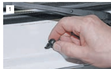
Ставим новую форсунку, направив отверстие жиклера на стекло. Убеждаемся, что оба усика-фиксатора защелкнулись.
