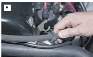
5 Снимаем с кронштейна топливный шланг карбюратора.
