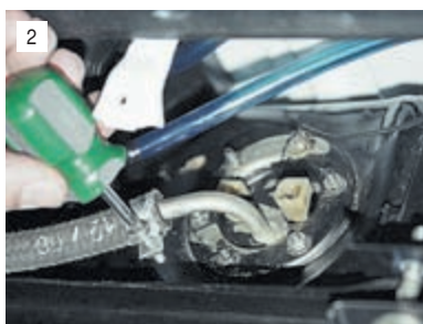
Крестообразной отверткой ослабляем винт крепления хомута топливного шланга и снимаем шланг со штуцера топливозаборника.
