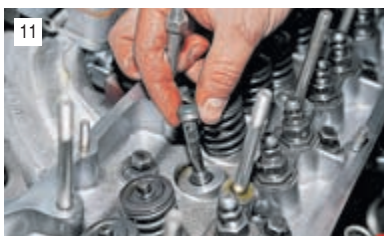
11 Смазываем рабочую кромку нового колпачка моторным маслом и надеваем его на стержень клапана.
