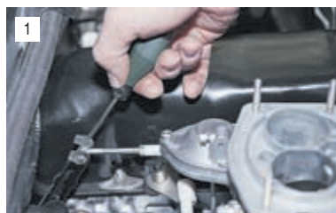
Тонкой отверткой поддеваем и снимаем пружинную скобу...
