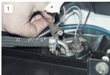
Отсоединяем два провода от выводов датчика, предварительно пометив их расположение.
