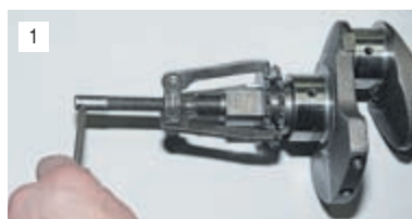
Съемником стягиваем шестерню с коленчатого вала...
