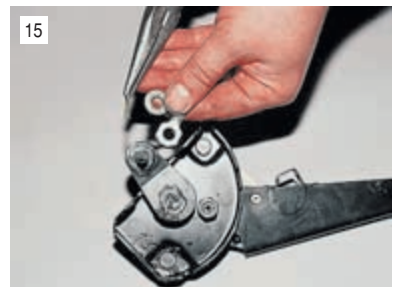
15 Расшплинтовав ось, снимаем с нее трос.
