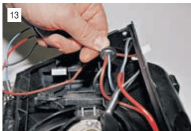
13 Протаскиваем внутрь кожуха провода электродвигателя.
