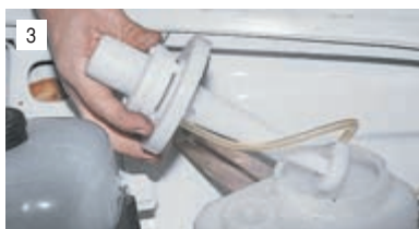
3 Повернув против часовой стрелки, вынимаем насос в сборе с электродвигателем из бачка.
