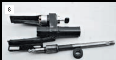
8 Развальцовываем загнутые края трубы кронштейна со стороны рулевого колеса, вставляем ключ в выключатель зажигания и отключаем блокировку. Легкими ударами выбиваем вал вместе с подшипником из трубы.
