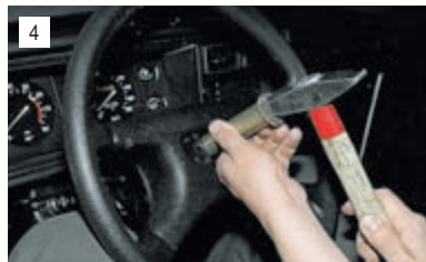
Если таким способом снять его не удается – поджав коленями обод, сбиваем его, нанося удары по валу через оправку из мягкого металла.
