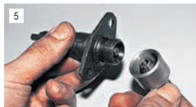
5 Проверяем исправность цапгового зажима. При поломке лапки зажима меняем колпачок или натяжитель в сборе.
