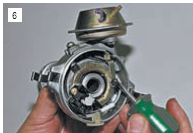
Поддев тонкой отверткой, снимаем запорную шайбу тяги вакуумного регулятора опережения зажигания.
