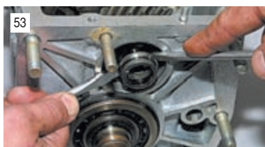
Двумя отвертками спрессовываем заднее внутреннее кольцо подшипника.
