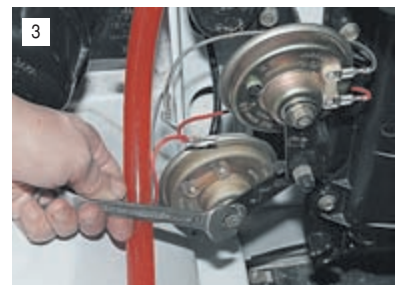
3 Ключом «13» отворачиваем гайку...
