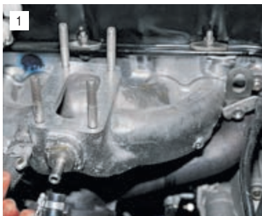
1 Ослабляем хомут крепления и снимаем шланг отвода охлаждающей жидкости из впускного коллектора,...
