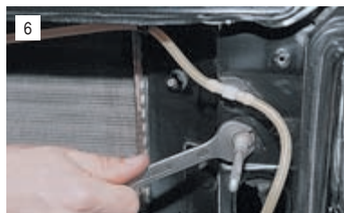
6 Ключом «на 14» отворачиваем гайку крепления моторедуктора, придерживая его с обратной стороны,...
