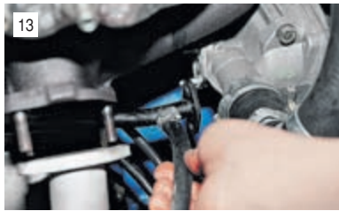
...и снимаем ее. Между трубой и насосом установлена уплотнительная прокладка.
