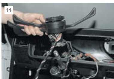
14 ...и снимаем их вместе со жгутами проводов с рулевой колонки, сдвинув вдоль оси вверх.
