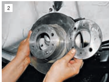
2 Снимаем дистанционное кольцо и тормозной диск.
