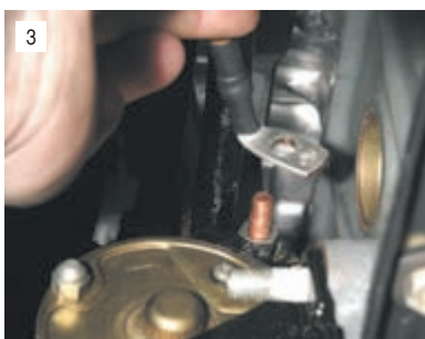
...и снимаем наконечник «плюсового» провода.
