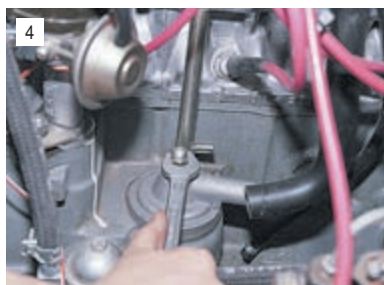
4 Ключом «на 13» отворачиваем гайку крепления крышки сапуна.
