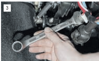
...ослабляем затяжку контргайки и выворачиваем выключатель из резьбового отверстия кронштейна.
