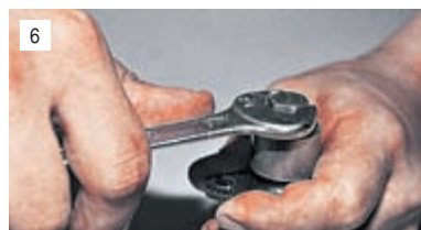
6 Утапливаем плунжер в корпус натяжителя до упора и, удерживая его в таком положении, затягиваем колпачковую гайку.
