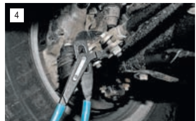
Поворотом муфты регулируем длину боковых тяг рулевого привода и, соответственно, схождение колес до тех пор, пока не исчезнут зазоры между нитями и боковинами покрышек на обоих колесах.
