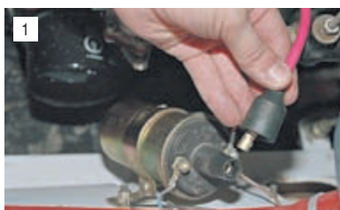
1 Вынимаем высоковольтный провод из крышки катушки.
