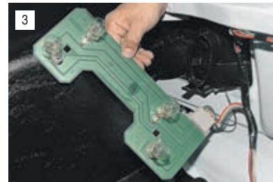
...снимаем плату с лампами. Меняем неисправную лампу.
