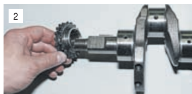
...и снимаем ее. Снять шестерню с коленчатого вала можно и на двигателе.
