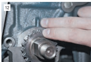
Проверяем одновременное совмещение меток на звездочках коленчатого вала и блоке цилиндров (цепь снята для наглядности), а также меток на звездочке распределительного вала и корпусе подшипников (см. «Регулировка зазора между рычагами и кулачками распределительного вала», с. 58).
