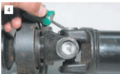
4 Подшипник выходит из вилки только на одну треть своей высоты.
