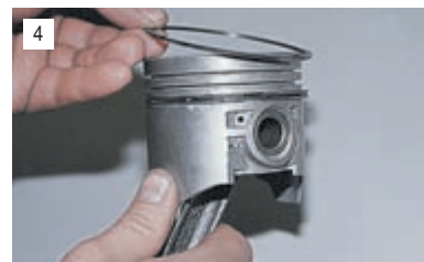
4 ...и нижнее компрессионные кольца. При их последующей установке метка «ВЕРХ» или «ТОР» должна быть направлена к дну цилиндра.
