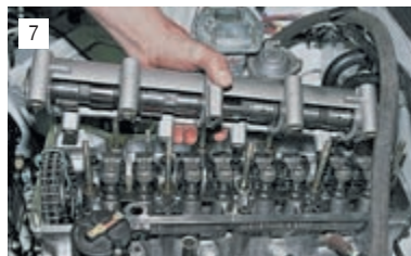
Снимаем корпус в сборе с распределительным валом со шпилек.
