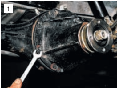
1 Ключом «на 13» отворачиваем восемь болтов крепления картера редуктора к балке заднего моста.
