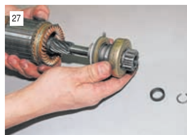
27 Снимаем с вала ограничитель и обгонную муфту в сборе с шестерней привода.
