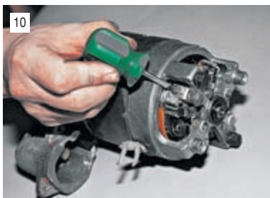
Для проверки состояния щеток отверткой отворачиваем винт крепления контактного провода...
