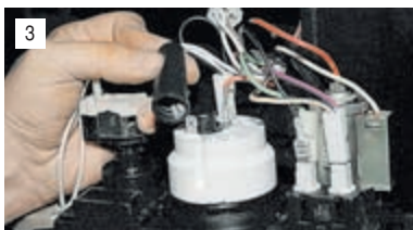
3 Отсоединяем три наконечника проводов от выводов часов, предварительно пометив порядок их подсоединения.
