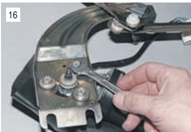
16 Ключом «на 10» отворачиваем три болта...
