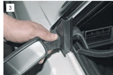
3 ...и снимаем зеркало с двери.
