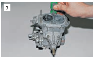
3 Крестообразной отверткой отворачиваем пять винтов крепления крышки...
