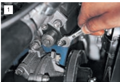
1 Ключом «на 10» отворачиваем две гайки крепления натяжителя к головке блока цилиндров.
