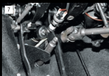
7 Снимаем промежуточный вал со шлицев вала червяка редуктора.
