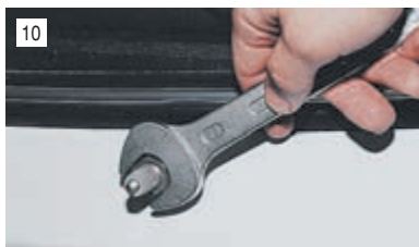
10 Ключом «на 22» отворачиваем гайку...
