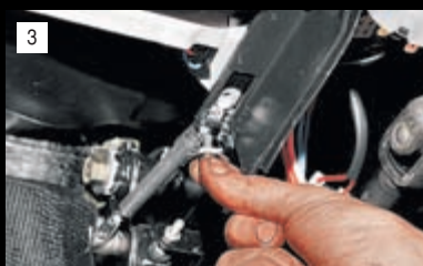
3 Под винтами установлены фиксирующие шайбы.
