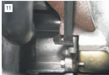
11 Осторожно отгибая отверткой, отводим кронштейн трубки отвода охлаждающей жидкости от шпильки выпускного коллектора.
