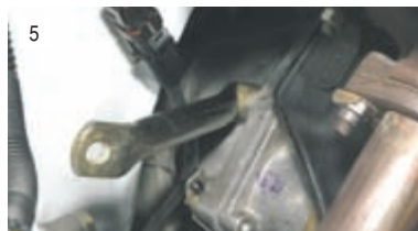
...отводим задний опорный кронштейн от впускной трубы.
