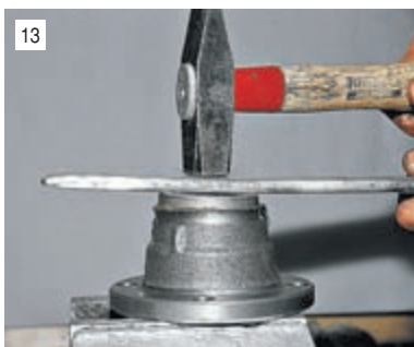
13 Осторожно запрессовываем новую манжету с помощью молотка и подходящего инструмента (монтажной лопатки).
