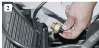
Соединение уплотнено медной шайбой.
