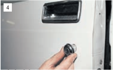
4 ...и вынимаем выключатель замка вместе с уплотнительным кольцом.
