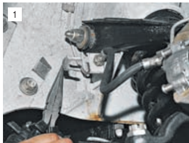
1 Пассатижами извлекаем скобу, фиксирующую тормозной шланг в кронштейне кузова.
