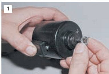
Снимаем с оси якоря шайбу.
