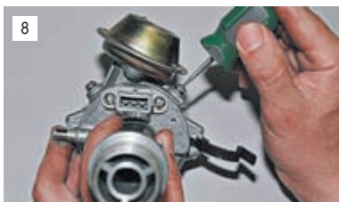
Отворачиваем два винта крепления вакуумного регулятора опережения зажигания
