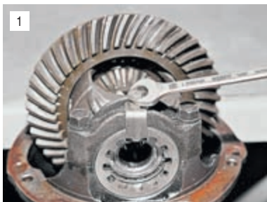
1 Установив редуктор на верстаке, ключом «на 10» отворачиваем два болта крепления стопорных пластин гаек подшипников дифференциала и снимаем пластины.
