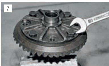
7 Ключом «на 17» отворачиваем восемь болтов крепления ведомой шестерни к корпусу дифференциала и снимаем ее.
