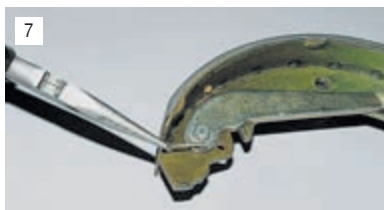
Пассатижами вынимаем из пальца шплинт.
