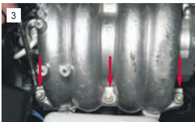
...и три гайки нижнего крепления ресивера к впускной трубе.
