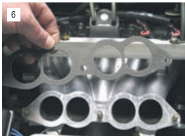
Снимаем уплотнительную прокладку.
