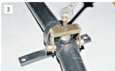
3 Устанавливаем приспособление (см. «Приложения», с. 244) на вилку шарнира и выпрессовываем игольчатый подшипник в чашку приспособления до упора крестовины в вилку.
