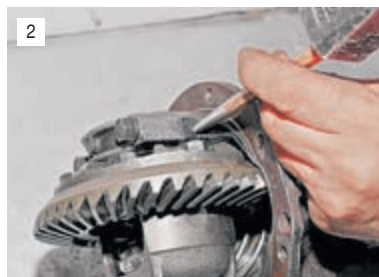
2 Керном наносим метки на постели и соответствующей крышке подшипника, чтобы при сборке установить крышки на свои места.
