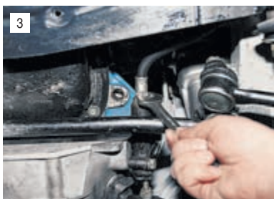
Ключом «на 17» ослабляем крепление наконечника шланга в пробке цилиндра.
