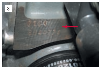
Модель и номер двигателя выбиты с левой стороны на приливе блока цилиндров, над масляным фильтром
