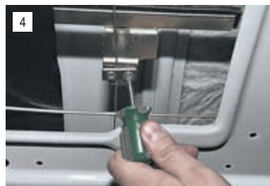
4 Крестообразной отверткой отворачиваем винты крепления обоймы стекла к тросу стеклоподъемника и опускаем стекло вниз до упора.
