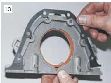
Между держателем и блоком установлена уплотнительная прокладка.
