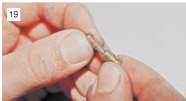
19 Вынимаем топливный жиклер из корпуса.
