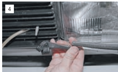
4 ...и снимаем рычаг-щетку с вала моторедуктора. Снимаем решетку радиатора (см. «Замена решетки радиатора», с. 184).
