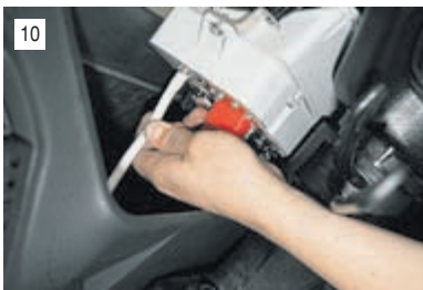
Сместив щиток вправо, отсоединяем шланг от штуцера эконометра...
