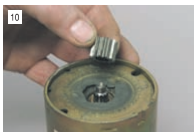
10 Снимаем с вала якоря центральную шестерню...
