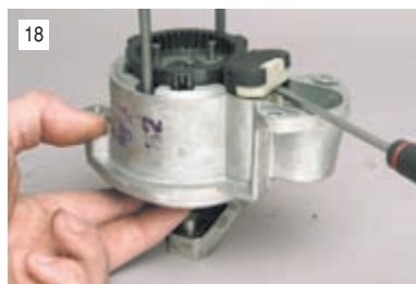
18 Нажимая пальцем на шестерню привода, отверткой поддеваем опору рычага...
