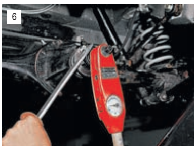
6 Устанавливаем новую гайку фланца и динамометрическим ключом постепенно затягиваем ее до момента в пределах 12–26 кгс·м, периодически проверяя усилие проворачивания вала динамометром.
