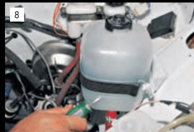
8 Заливаем жидкость в расширительный бачок до уровня на 3–4 см выше отметки «MIN».
