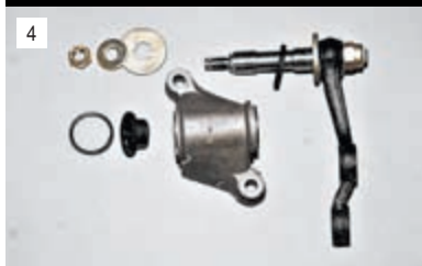
4 Вынимаем ось с рычагом из кронштейна.
