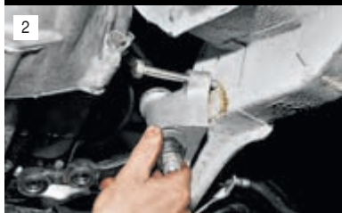
2 Нижний болт можно вынуть сразу, а верхний снимаем вместе с кронштейном.
