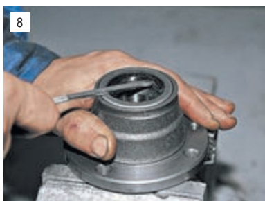
8 Манжету ступицы вынимаем, поддев ее отверткой.
