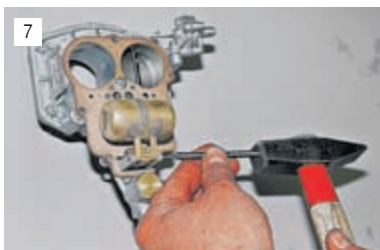
7 Тонким бородком выбиваем ось поплавка.
