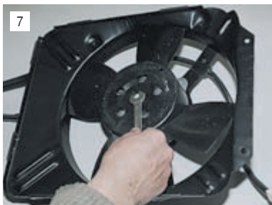
Ключом «на 10» по часовой стрелке отворачиваем гайку (левая резьба)...
