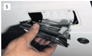
5 Снимаем наружную ручку двери вместе с тягой.
