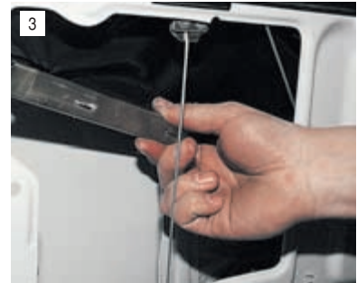
3 ...и, чуть опустив его и выведя язычок из паза, отодвигаем желобок в сборе с уплотнением.
