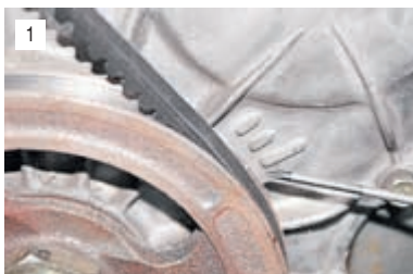
1 Первая метка по ходу вращения шкива коленчатого вала соответствует 10^\circ опережения зажигания, вторая – 5^\circ и третья метка, самая длинная – 0^\circ .
