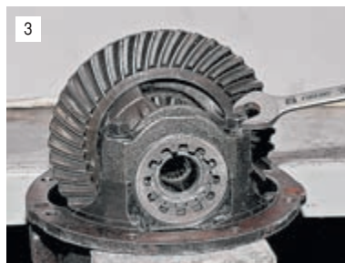
3 Ключом «на 17» отворачиваем болты крепления крышек подшипников.
