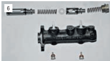
Ключом «на 12» отворачиваем два стопорных болта снизу цилиндра и извлекаем из него все детали. Раскладываем их по порядку.
