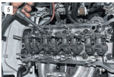
Головкой «на 12» отворачиваем десять болтов крепления головки к блоку цилиндров.
