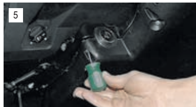
Крестообразной отверткой отворачиваем четыре винта, стягивающие с двух сторон половинки кожуха рулевой колонки,...
