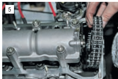
Снимаем звездочку вместе с цепью распределительного вала и укладываем в головку блока. Чтобы цепь не перескочила, привязываем ее к звездочке.
