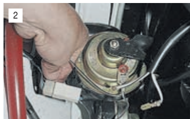
Разъединяем соединительную колодку.
