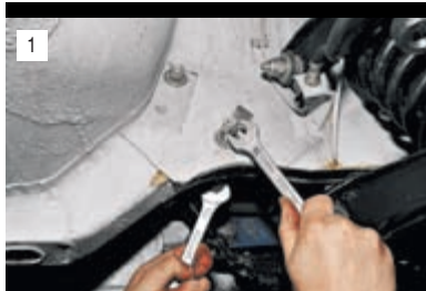
1 Двумя ключами «на 17» отворачиваем две гайки болтов крепления кронштейна к правому лонжерону кузова.
