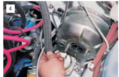
Осторожно поддев отверткой, вынимаем штуцер вакуумного шланга из корпуса усилителя.
