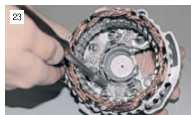
Головкой «на 8» отворачиваем три гайки крепления клемм статора к выпрямительному блоку.
