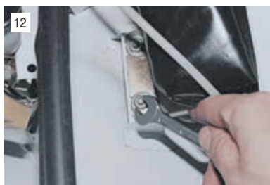
12 Ключом «на 10» отворачиваем две гайки крепления очистителя к кузову.
