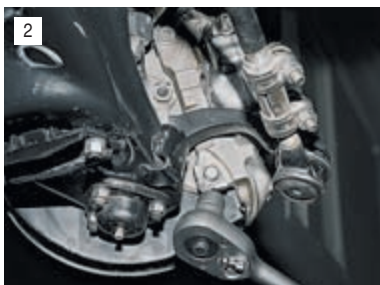
Головкой «на 17» отворачиваем два болта крепления суппорта.
