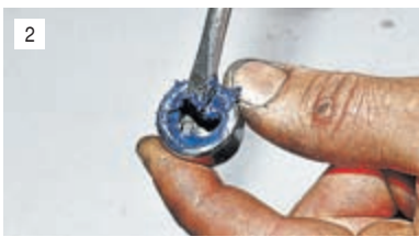
2 Закладываем смазку Фиол-2У или № 158 в подшипники шарнира.
