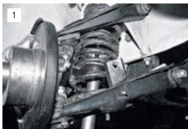
1 Устанавливаем приспособление на пружину и снимаем ее.
