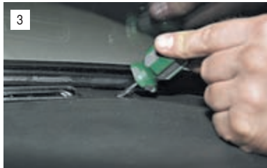
3 Крестообразной отверткой отворачиваем три самореза крепления верхней вставки панели приборов.
