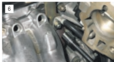
Головкой «на 13» отворачиваем гайку крепления «массового» провода и переднего рыма силового агрегата.
