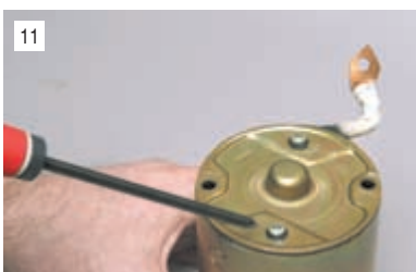
11 Крестообразной отверткой отворачиваем два винта...
