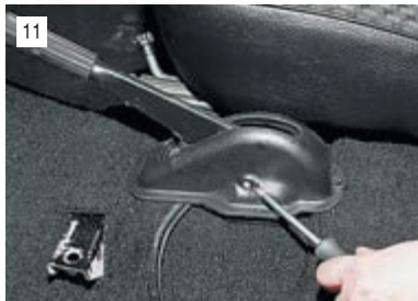
11 В салоне крестообразной отверткой отворачиваем саморез крепления защитного кожуха.
