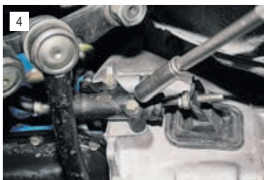
Головкой «на 13» отворачиваем два болта крепления цилиндра к картеру сцепления.
