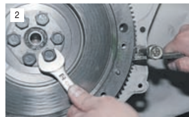
Опираясь на него, монтажной лопаткой или большой отверткой удерживаем маховик от проворачивания. Головкой «на 17» отворачиваем шесть болтов крепления маховика.
