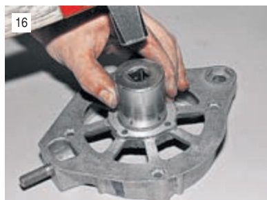
Через оправку выбиваем подшипник.
