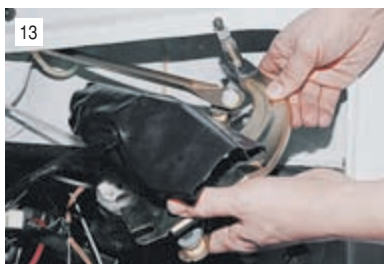
13 Аккуратно вынимаем очиститель, стараясь не погнуть тяги привода.
