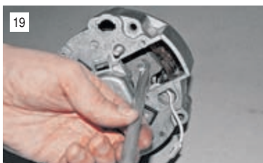
Выколоткой из мягкого металла выбиваем ротор из задней крышки.
