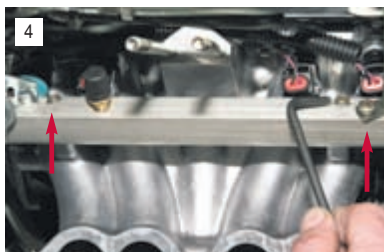
Шестигранником «на 5» отворачиваем два винта крепления топливной рампы к впускной трубе.
