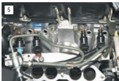
...и снимаем рампу в сборе с регулятором давления топлива, топливными трубками, форсунками и жгутом проводов.
