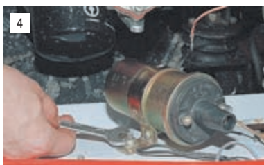
4 Ключом «на 10» отворачиваем на три-четыре оборота гайку крепления катушки...
