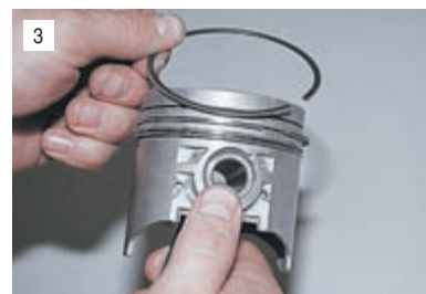
3 Зажимаем шатун в тиски и, разжимая, снимаем верхнее...
