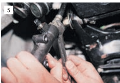
Удерживая наконечник шланга ключом «на 17» и вращая цилиндр руками, отсоединяем его от шланга.
