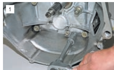
Головкой «на 13» отворачиваем одну гайку в нижней части коробки передач...
