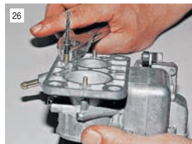
26 Пассатижами вынимаем трубки.
