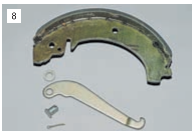
Снимаем с колодки рычаг, шайбу и палец.
