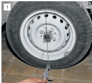
Штангенциркулем или линейкой измеряем расстояния от нити отвеса до верхней и нижней точек обода колеса.
