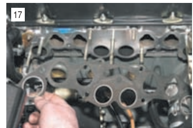
17 ...и уплотнительную прокладку впускной трубы и выпускного коллектора.
