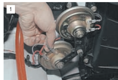
1 ...отсоединяем наконечник серого с черной полосой провода от вывода отключаемого сигнала.
