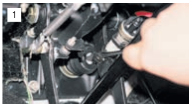
В салоне отверткой поддеваем и снимаем пружинный фиксатор со штифта, соединяющего толкатель с педалью тормоза, и...
