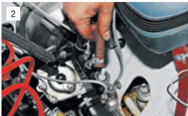
Ослабив ленточные хомуты, снимаем два гибких шланга со штуцеров главного тормозного цилиндра.
