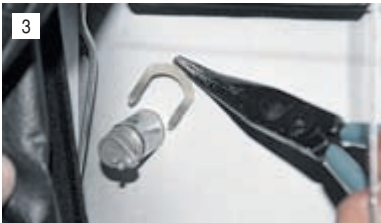
3 Плоскогубцами снимаем стопорную скобу...
