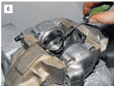
6 Поддев отверткой, извлекаем уплотнительные кольца.
