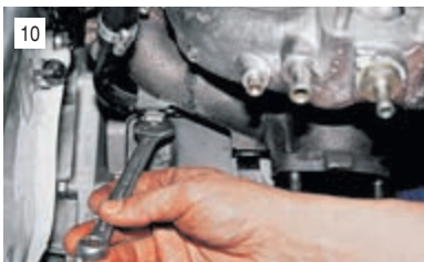
Ключом «на 13» отворачиваем вторую верхнюю гайку крепления...
