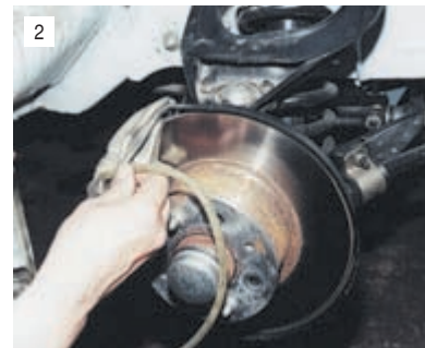
Надеваем на него шланг (лучше прозрачный), опустив его свободный конец в подходящую емкость.
