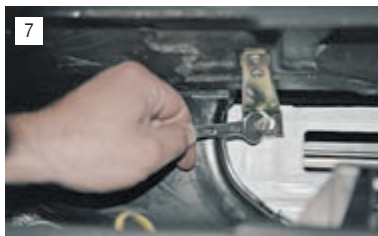
7 Ключом «на 10» внутри панели приборов отворачиваем четыре гайки ее верхнего крепления...
