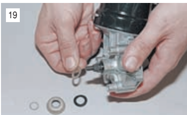
19 ...защитный колпачок, стальную и текстолитовую шайбы.
