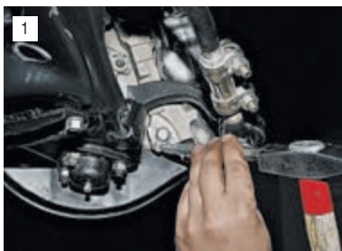
Зубилом отгибаем стопорные пластины двух болтов крепления суппорта.
