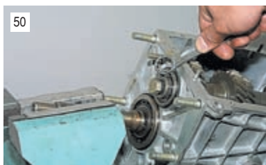
Накидным ключом «на 19» отворачиваем болт зажимной шайбы переднего подшипника промежуточного вала.
