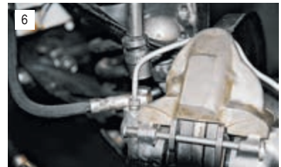
6 Головкой «на 14» отворачиваем болт крепления тормозного шланга и снимаем шланг.
