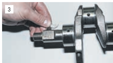
Отверткой поддеваем и вынимаем из паза сегментную шпонку.
