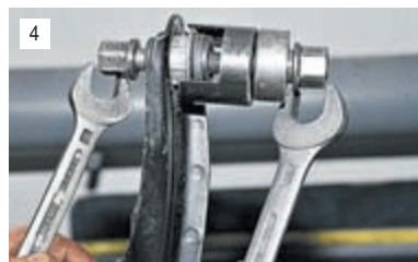
4 Затягиваем болт приспособления и последовательно выдавливаем шарниры из рычага в чашку приспособления.
