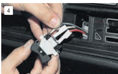
Отсоединяем наконечники проводов от выводов выключателя, пометив порядок их подсоединения.
