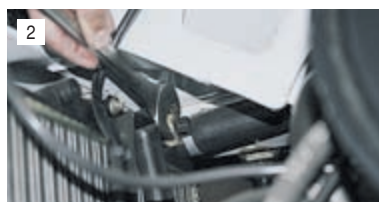
Ключом «на 30» отворачиваем датчик.
