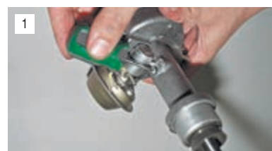
1 Отверткой отворачиваем винт крепления конденсатора.
