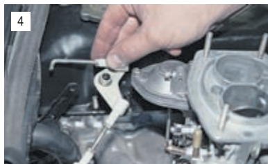
4 Снимаем с оси рычаг вместе с тягами.
