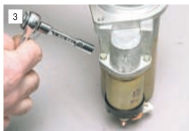
Головкой «на 8» отворачиваем два болта крепления тягового реле...
