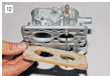
12 Снимаем теплоизоляционную прокладку.
