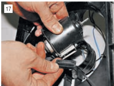
17 Вынимаем электродвигатель вместе с двумя резиновыми подушками.
