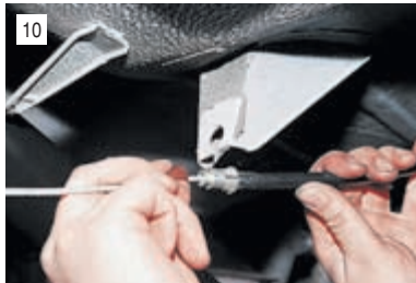
10 Отсоединяем от кронштейна наконечник оболочки заднего троса, сдвинув его назад и вниз.
