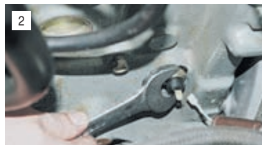
Ключом «на 22» (или свечным ключом «на 21») отворачиваем датчик.
