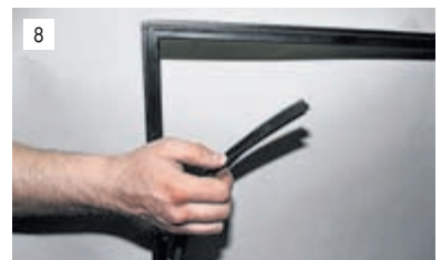
8 При дальнейшей разборке двери вынимаем из задней части рамки уплотнитель.
