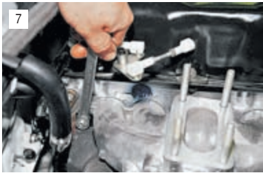
...и верхнюю гайки крепления воздухозаборника.
