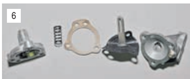
6 ...и, разобрав корпус пускового устройства, меняем неисправную прокладку или диафрагму.
