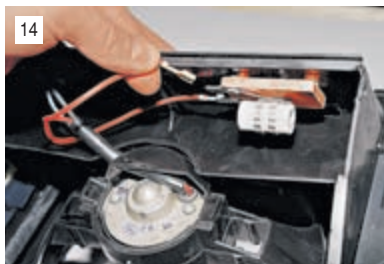
14 Отсоединяем красный провод, соединяющий электровентилятор с добавочным резистором,...
