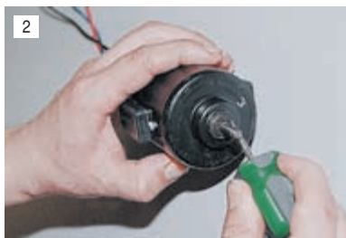
Поддев отверткой, снимаем стопорное кольцо...
