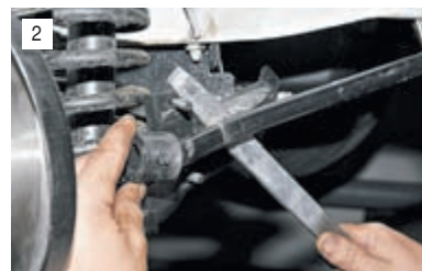
2 Монтажной лопаткой отжимаем конец штанги и ставим новую подушку, предварительно смочив ее отверстие мыльным раствором. Подушку устанавливаем так, чтобы ее выступ попал в отверстие скобы.
