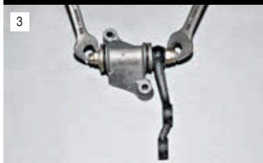
3 Вынимаем шплинт и двумя ключами «на 19» отворачиваем верхнюю гайку с оси маятникового рычага.
