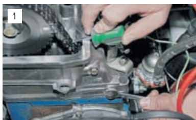
Удерживая отверткой успокоитель цепи, ключом «на 10» отворачиваем два болта его крепления.
