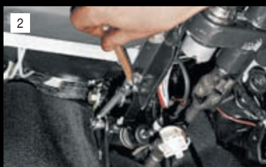
2 Если у болтов срезаны головки под ключ, то зубилом ослабляем затяжку оставшихся круглых головок и окончательно отворачиваем их пассатижами.
