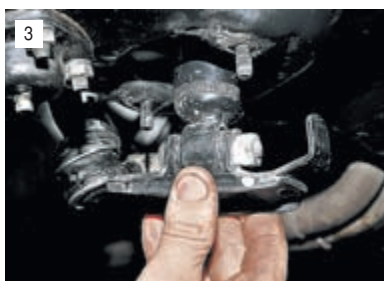
3 ...вынимаем амортизатор вместе с кронштейном вниз через отверстие в нижнем рычаге.
