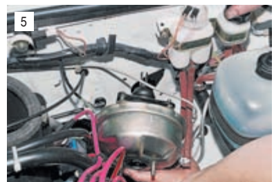
Снимаем усилитель с автомобиля.
