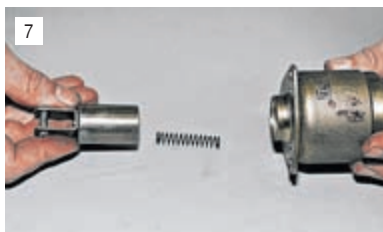
Из корпуса реле вынимаем шток с пружиной.
