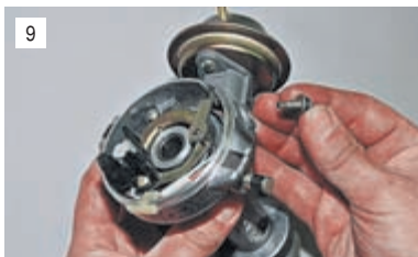
Один из винтов имеет удлинение для фиксации электропроводки датчика.
