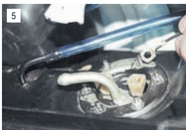
Под одну из гаек датчика устанавливаем «массовый» провод.
