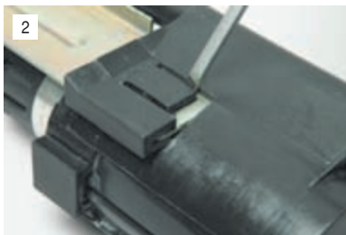
2 Поддев шлицевой отверткой защелку пластмассового держателя насоса...
