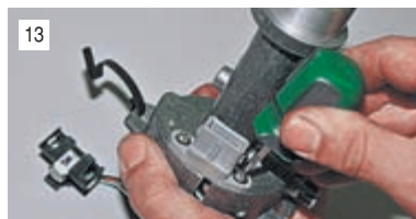
Отворачиваем два винта крепления соединительного разъема...
