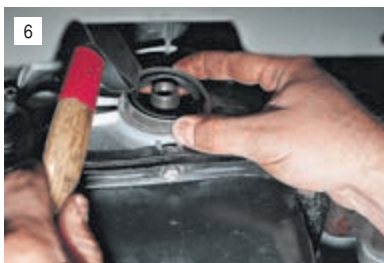
Смазав моторным маслом рабочую кромку новой манжеты, запрессовываем ее в крышку, используя старую манжету как оправку.
