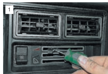
Шлицевой отверткой разжимаем фиксаторы рукояток и снимаем их с рычагов отопителя.
