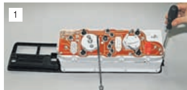
Крестообразной отверткой отворачиваем два винта крепления комбинации приборов к кронштейнам щитка.
