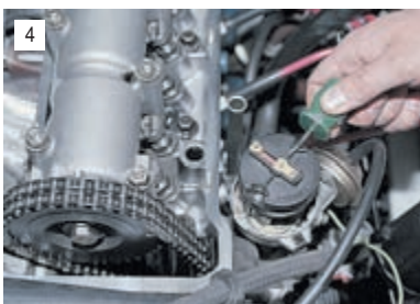
4 При повороте коленчатого вала на 180° распределительный вал, а также ротор распределителя зажигания поворачиваются на 90°.
