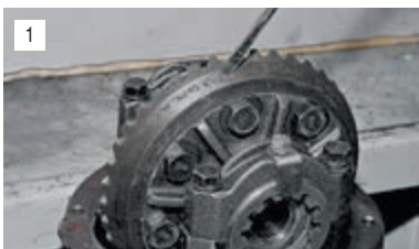
Место маркировки передаточного числа на ведомой шестерне.
