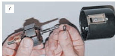
Вынимаем якорь из корпуса и снимаем две шайбы с вала.
