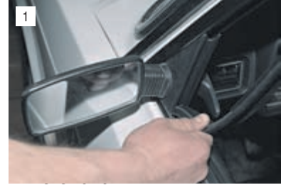
1 Вынимаем из передней части рамки двери уплотнитель.
