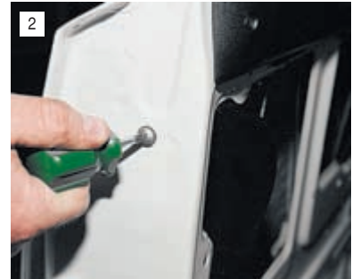
2 С торцевой стороны двери крестообразной отверткой отворачиваем два винта крепления желобка...
