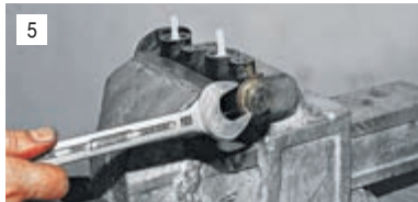
Ключом «на 22» отворачиваем торцевую заглушку.
