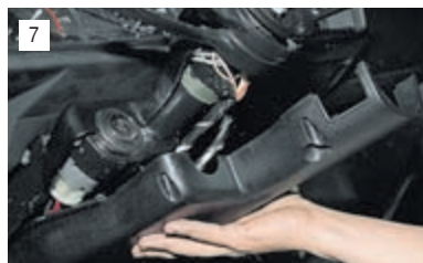
Снимаем нижнюю накладку, разрезав пластмассовый хомут крепления к ней жгута проводов.
