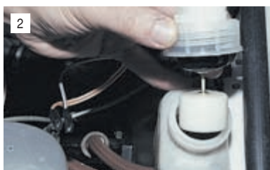
Отворачиваем крышку бачка и вынимаем датчик.
