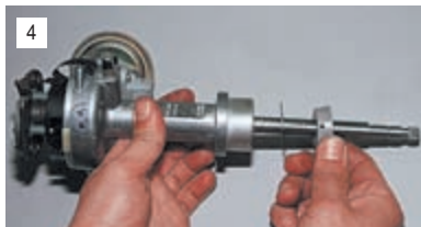
Снимаем с валика маслоотражатель и шайбу.
