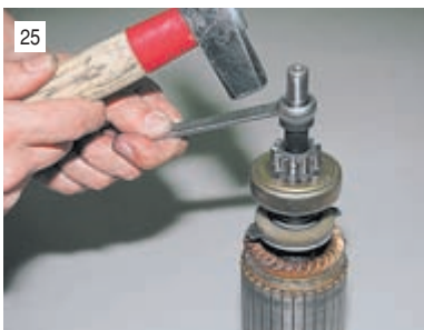
25 Оперев вал якоря на деревянный брусок, через ключ «на 13» сбиваем ограничитель со стопорного кольца.
