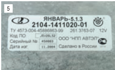
Маркировка контроллера двигателя ВАЗ-2104.
