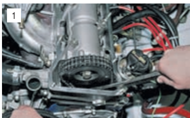
Ключом «на 13» ослабляем затяжку колпачковой гайки натяжителя цепи. Упираясь монтажной лопаткой в башмак натяжителя, отжимаем шток натяжителя и фиксируем его, затянув колпачковую гайку (шланг радиатора снят для наглядности).
