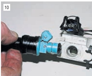
Покачивая форсунку, вынимаем ее из рампы.
