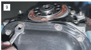
...ключом «на 10» отворачиваем два болта крепления поддона картера к держателю манжеты...
