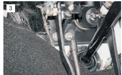
Головкой «на 13» отворачиваем четыре гайки крепления усилителя к моторному щиту.
