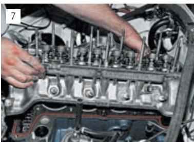
Снимаем головку блока цилиндров в сборе с коллекторами...
