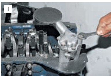
Ключом «на 13» отворачиваем два болта крепления масляного насоса...
