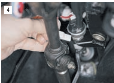
Провода подсоединяем к выключателю в произвольном порядке.
