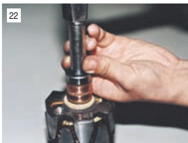
Новый подшипник запрессовываем, нанося легкие удары через оправку – и только по внутреннему кольцу.
