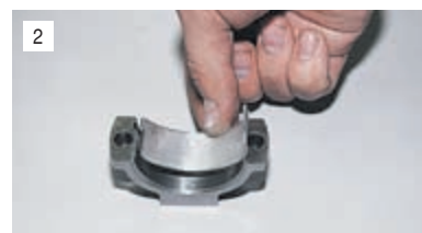
2 ...и крышках шатунов установлены сталеалюминиевые вкладыши.
