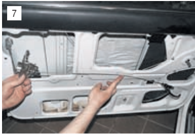
7 ...и вынимаем замок из двери вместе с тягой и внутренней ручкой.
