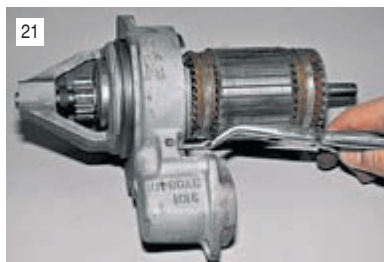
21 Расшплинтовываем ось рычага.
