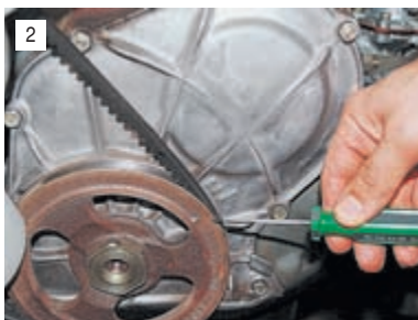
2 На шкиве коленчатого вала выбита метка верхней мертвой точки (ВМТ) первого цилиндра. На торце шкива в этом месте имеется прилив.
