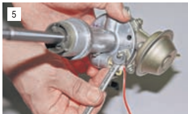
5 Ключом «на 7» отворачиваем гайку, снимаем наконечник провода низкого напряжения с вывода и подсоединяем его к выводу нового распределителя.
