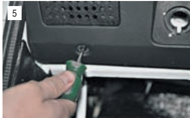
5 Крестообразной отверткой отворачиваем четыре самореза нижнего крепления панели приборов.
