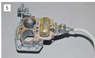
5 Перевернув крышку поплавком вверх, проверяем герметичность игольчатого клапана. Для этого резиновой грушей (или ртом через шланг, надетый на штуцер подачи топлива) создаем разрежение. Неисправный или засорившийся клапан разрежение не держит – груша тут же распрямляется.
