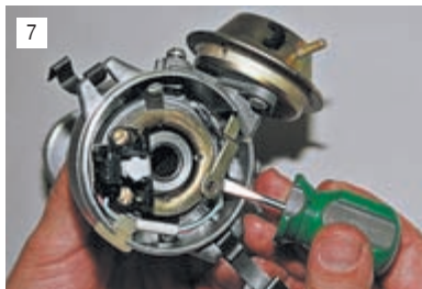
Снимаем тягу со штифта поворотной пластины.
