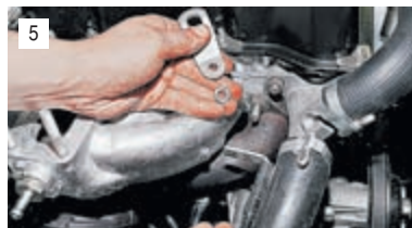
5 ...и снимаем со шпильки «минусовой» провод и рым.
