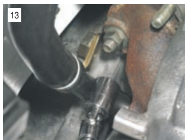
13 Головкой «на 13» с карданным шарниром отворачиваем гайку заднего крепления выпускного коллектора.
