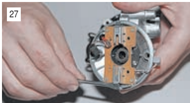
...тонкой отверткой отгибаем торцевые стенки щеткодержателей...
