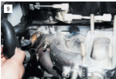
Снимаем с отводящей трубы шланг отвода охлаждающей жидкости из радиатора отопителя.
