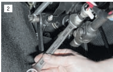
Ключом «на 19» отворачиваем пластмассовый буфер,...
