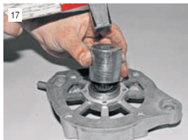
Устанавливаем новый подшипник, нанося легкие удары по его наружному кольцу через оправку. В качестве нее можно использовать отрезок трубы подходящего размера.
