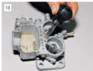
13 Отворачиваем клапан ускорительного насоса.
