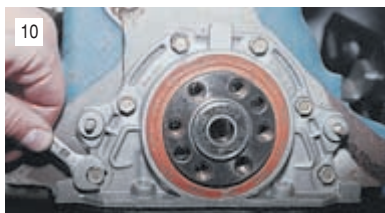
...и шесть болтов крепления держателя манжеты к блоку цилиндров.
