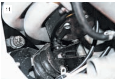
...и ключом «на 10» – болт нижнего крепления теплозащитного экрана стартера и снимаем его (см. «Замена стартера», с. 150).
