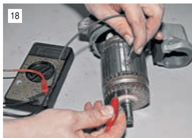
18 Омметром проверяем обмотки якоря на короткое замыкание. Неисправный якорь заменяем.
