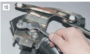
15 Ключом «на 10» отворачиваем гайку и снимаем кривошип.
