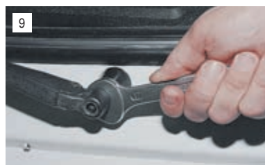
Ключом «на 17» стягиваем рычаг со шлицев оси.
