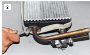
2 Ключом «на 10» отворачиваем два болта...
