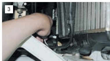
Снимаем два штекера с выводов датчика.
