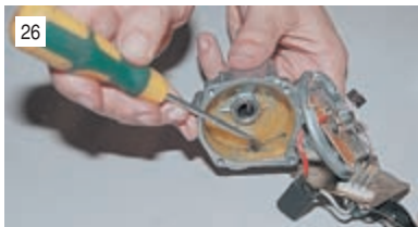
В крышке остаются пружина и подпятник, установленные в торце канала.
