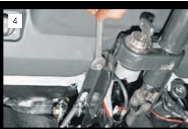
4 Ключом «на 13» отворачиваем две гайки крепления кронштейна руля...
