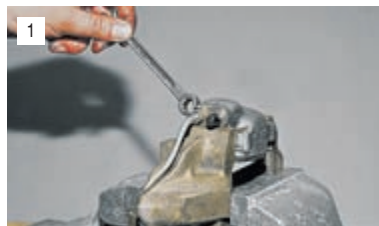
Ключом «на 10» отворачиваем штуцеры соединительной трубки рабочих цилиндров и...
