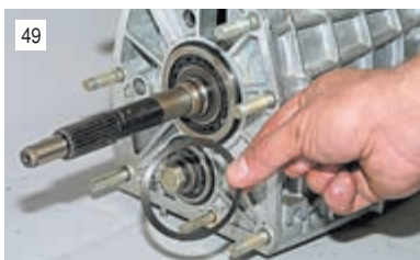
Снимаем с первичного вала пружинную шайбу с конической поверхностью (меньшим диаметром она обращена к подшипнику).
