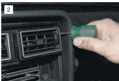
Поддев отверткой, вынимаем два сопла центрального воздуховода.
