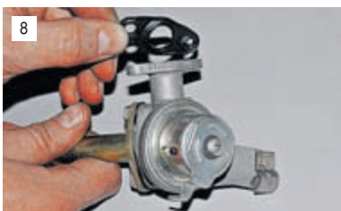
...и снимаем кран отопителя вместе с впускным патрубком и резиновой прокладкой.
