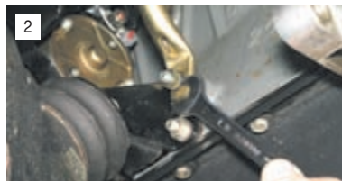
Тем же инструментом ослабляем затяжку гайки крепления переднего опорного кронштейна к шпильке кронштейна правой опоры силового агрегата.
