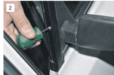
2 Крестообразной отверткой отворачиваем саморез крепления зеркала...
