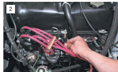
Подносим его наконечник на расстоянии около 1 миллиметра к оголенному контакту «массы» (например к болту или шпильке на двигателе).
