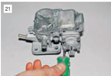
21 Крестообразной отверткой отворачиваем четыре винта крепления крышки ускорительного насоса.
