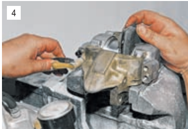
4 Нагнетая сжатый воздух через впускное отверстие для тормозной жидкости, поочередно выталкиваем поршни из цилиндров.
