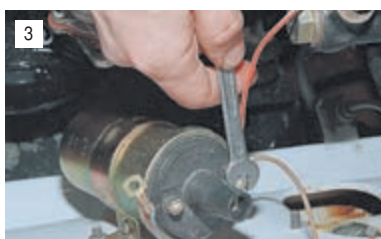
3 Аналогично отсоединяем два провода (красный и коричневый) от вывода, обозначенного буквами «ОК».
