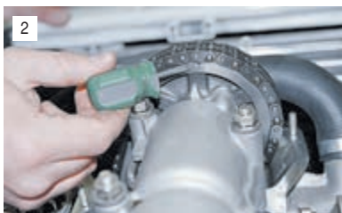
2 Ключом проворачиваем коленчатый вал по часовой стрелке (глядя спереди) до совпадения метки (сверления) на звездочке распределительного вала с выступом на корпусе подшипников.
