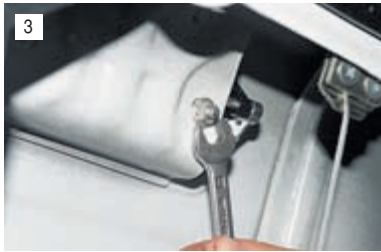
3 Ключом «на 8» отворачиваем две гайки крепления замка передней...
