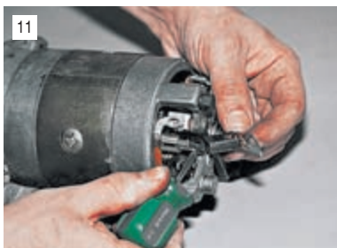
...и, отжав отверткой пружину, извлекаем щетку. Таким же способом извлекаем три оставшиеся щетки. Щетки, изношенные до высоты 12 мм и менее, заменяем.
