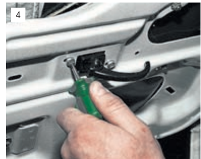
4 Той же отверткой отворачиваем два винта крепления внутренней ручки двери...
