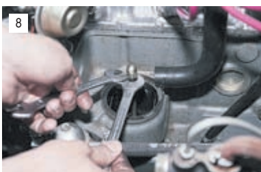
8 Затягиваем две гайки М8 на шпильке и ключом «на 13» отворачиваем ее.
