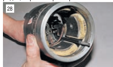
28 Перед сборкой стартера вставьте стяжные болты корпуса в соответствующие отверстия.
