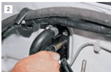
Отсоединяем подводящий шланг от трубы радиатора отопителя.
