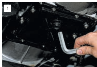
Шестигранником «на 12» отворачиваем пробку сливного отверстия...
