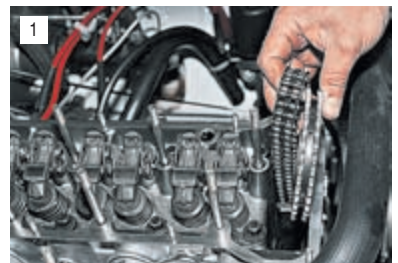
Снимаем цепь со звездочки распределительного вала.
