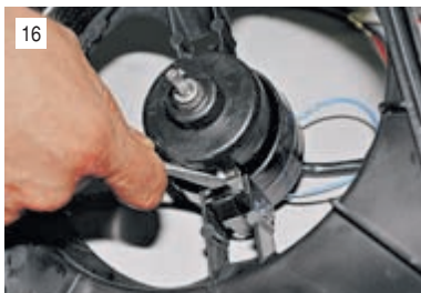
16 Отверткой поддеваем и снимаем две пружинные скобы.
