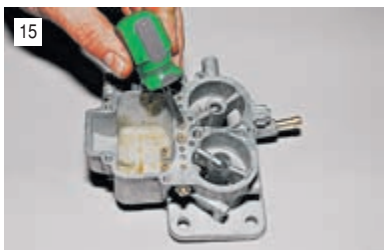
15 Отворачиваем воздушные жиклеры.
