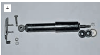
4 С помощью двух ключей «на 17» отворачиваем гайку и вынимаем болт крепления амортизатора к кронштейну.
