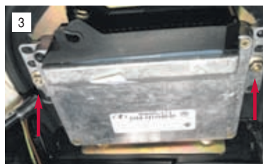
Головкой «на 10» отворачиваем две гайки крепления...
