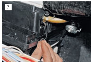
7 Поддеваем отверткой и поочередно снимаем четыре пружинные скобы крепления кожуха вентилятора отопителя.
