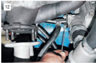
Ключом «на 10» отворачиваем две гайки крепления трубы к насосу охлаждающей жидкости...
