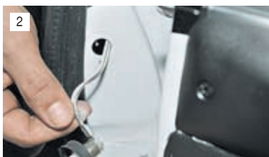
...вынимаем выключатель и отсоединяем от него провод.
