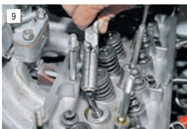
9 Снимать маслоотражательные колпачки удобнее специальными щипцами.
