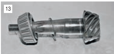
13 Под подшипником установлено регулировочное кольцо, обеспечивающее правильное взаимное расположение шестерен главной передачи.
