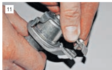
Снимаем и переставляем на новый кран скобу крепления тяги привода.
