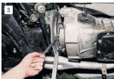
Удерживая маховик монтажной лопаткой, ключом «на 13» отворачиваем шесть болтов крепления кожуха сцепления, проворачивая коленчатый вал для доступа к ним.
