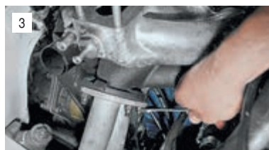
3 Ключом «на 13» отворачиваем четыре омедненные гайки крепления приемной трубы к выпускному коллектору.
