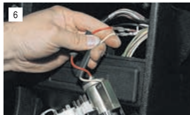
6 Разъединяем наконечники двух питающих проводов прикуривателя.
