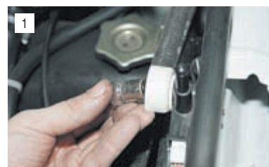
Для замены лампы слегка нажимаем на нее и, повернув против часовой стрелки, вынимаем.
