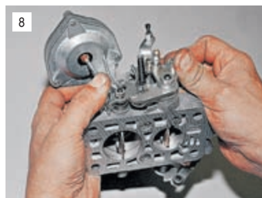
8 Удерживая шток диафрагмы поджатым, открываем рычагом заслонку первой камеры, при этом заслонка второй должна автоматически открыться. Если заслонка открылась не полностью – укорачиваем тягу. По окончании регулировки затягиваем контргайку тяги.
