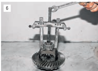
6 Съемником спрессовываем внутреннее кольцо подшипников.
