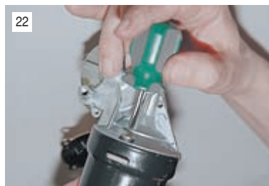
22 Отверткой отворачиваем два винта крепления редуктора,...
