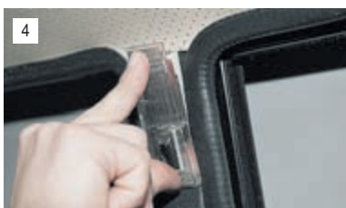
Устанавливаем плафон, надавливая на его верхнюю часть до срабатывания пружинной защелки.
