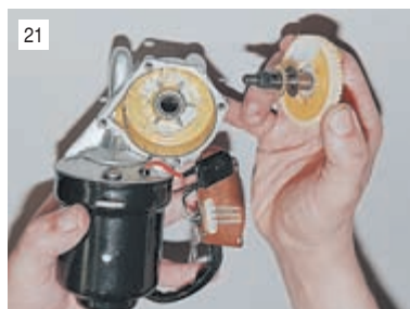
21 Снимаем с ее оси текстолитовую и стальную шайбы.
