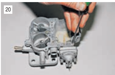
20 Отворачиваем регулировочный винт ускорительного насоса.
