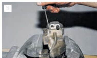
Нажав отверткой на подпружиненный фиксатор,...
