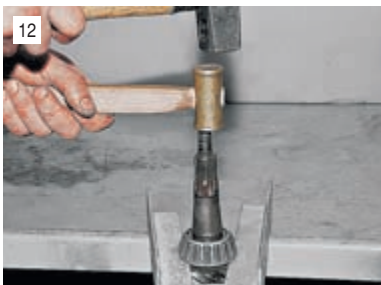
12 Выколоткой из мягкого металла сбиваем внутреннее кольцо конического подшипника с вала ведущей шестерни.
