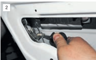
2 У задней двери отверткой или торцевым ключом «на 8» отворачиваем на 1–2 оборота стопорный винт замка.
