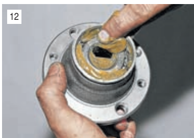
12 Закладываем в сепаратор внутреннего подшипника и внутреннюю полость ступицы около 40 г смазки Литол-24. Новую манжету покрываем той же смазкой.
