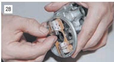
...и вставляем в них щетки, утопив их полностью, насколько позволяют прорези для проводов.
