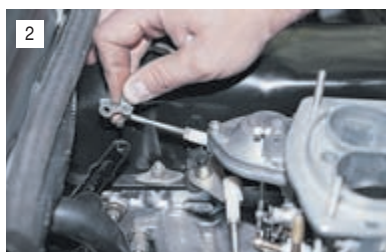
2 ...и отсоединяем тягу от валика привода дроссельной заслонки.
