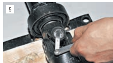
5 С помощью набора щупов измеряем зазор между стопорным кольцом и подшипником.
