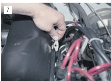
7 ...и снимаем со шпилек специальные шайбы.
