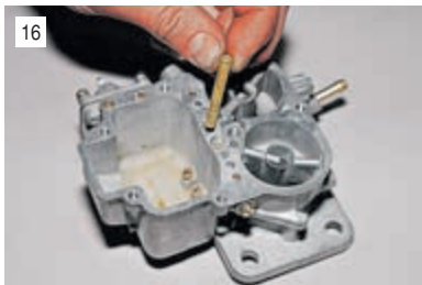
16 Извлекаем из каналов эмульсионные трубки главной дозирующей системы. Если они сами не выпадают из каналов, вворачиваем в их отверстия метчик М4 и вынимаем.
