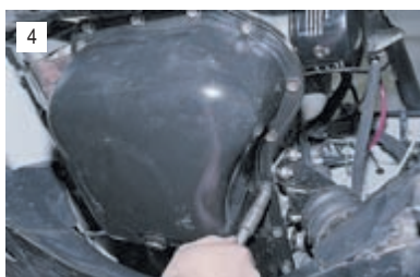
Головкой «на 10» отворачиваем девятнадцать болтов крепления поддона картера...
