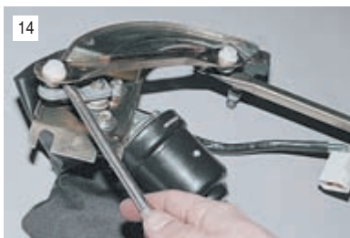
14 Поддев отверткой, снимаем короткую тягу с шарового пальца кривошипа.
