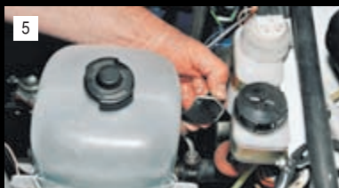
5 Отстегиваем ремень крепления расширительного бачка и, приподняв бачок, сливаем через радиатор оставшуюся жидкость из соединительного шланга. Устанавливаем бачок на место.
