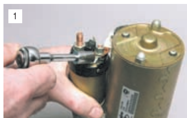
Головкой «на 10» отворачиваем гайку нижнего вывода тягового реле.
