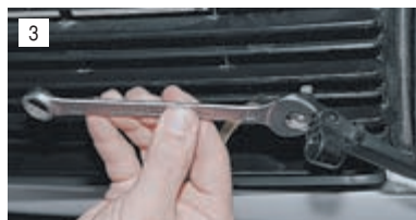
3 Отведя в сторону защитный колпачок, ключом «на 12» отворачиваем гайку...
