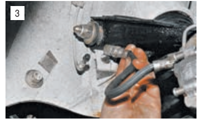
3 Вынимаем из кронштейна тормозной шланг, а на тормозную трубку надеваем защитный колпачок прокачного штуцера для предотвращения утечки тормозной жидкости.
