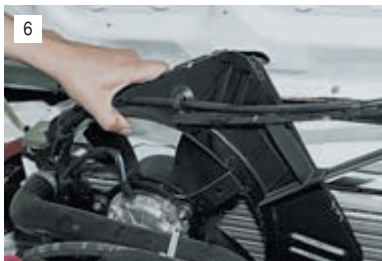
Снимаем вентилятор в сборе.
