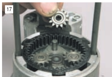
17 Вынимаем три планетарных шестерни привода.
