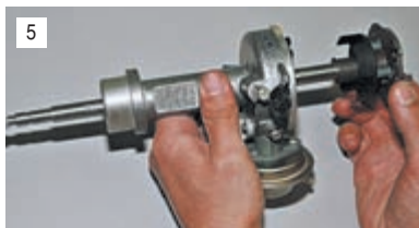
Вынимаем валик из корпуса распределителя.
