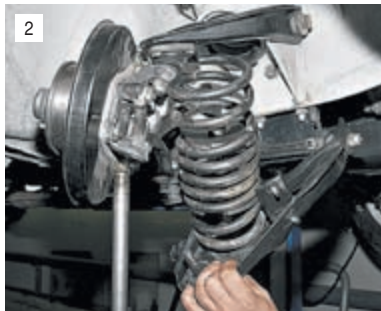
2 Убедившись, что витки пружины стянуты надежно, отжимаем нижний рычаг подвески вниз и вынимаем пружину вместе с приспособлением из нижнего рычага.
