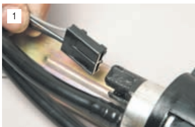
1 Отсоединяем колодку проводов от насоса.
