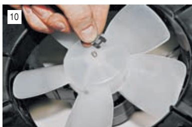
10 Поддев шлицевой отверткой, снимаем с вала двигателя пружинную скобу,...
