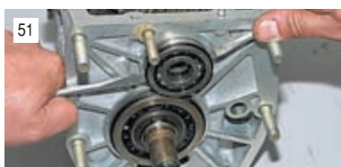
Двумя отвертками поддеваем за установочное кольцо передний двухрядный подшипник промежуточного вала...
