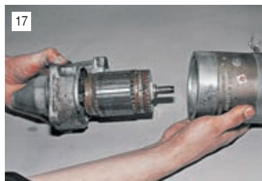
Разъединяем корпус стартера и вынимаем из него изоляционные трубки стяжных болтов.
