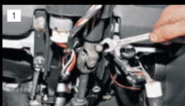
1 Ключом «на 13» отворачиваем гайки со стяжных болтов вилок карданных шарниров промежуточного вала и вынимаем болты.
