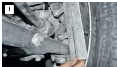
Шаблон для регулировки угла продольного наклона оси поворота.
