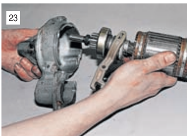
23 ...и вынимаем якорь с приводом.
