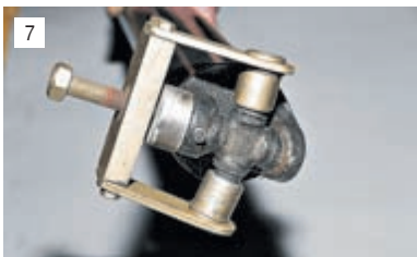
7 Устанавливаем приспособление на крестовину и аналогично выпрессовываем вторую пару подшипников.
