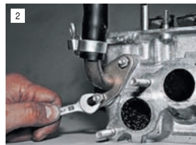
Ключом «на 10» отворачиваем две гайки крепления патрубка...
