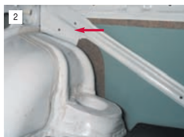
Идентификационный номер продублирован в багажном отделении на соединителе левой арки заднего колеса
