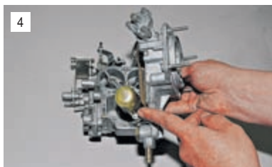
4 ...и, придерживая прокладку, снимаем ее (не потеряйте винты).
