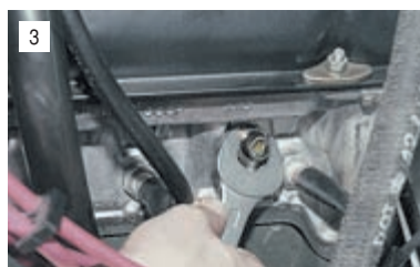
Ключом «на 22» (или свечным ключом) отворачиваем датчик температуры охлаждающей жидкости.
