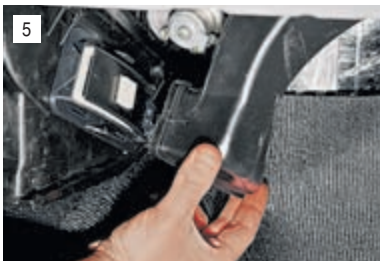
...и, поддев шлицевой отверткой четыре защелки по периметру воздухопровода, снимаем его.
