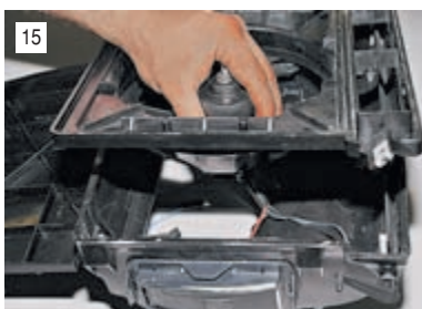
15 ...и снимаем направляющий кожух вместе с электродвигателем.
