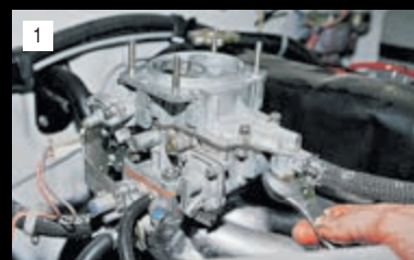
1 Ключом «на 19» отворачиваем пробку топливного фильтра (для наглядности корпус воздушного фильтра снят)...
