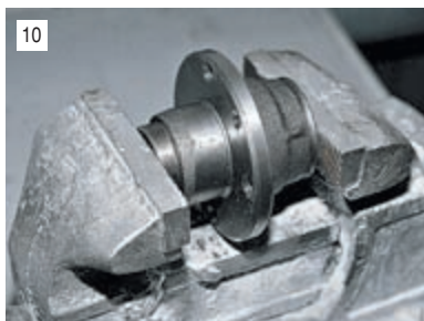
10 Наружные кольца подшипников запрессовываем в тисках, используя соответствующие кольца от старых подшипников.
