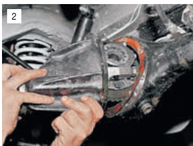
2 Снимаем редуктор в сборе.
