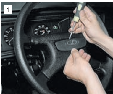
Поддев отверткой, снимаем декоративную накладку.
