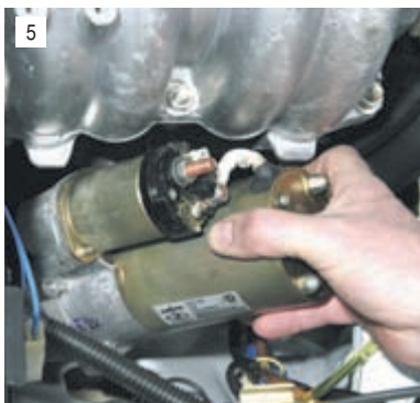
Снимаем стартер, выводя его из пространства между ресивером и брызговиком.
