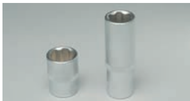
Торцевая головка: 7; 8; 10; 12; 13; 14; 17; 19; 21(высокая); 22; 24; 27; 30; 32.
