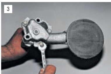
Ключом «на 10» отворачиваем три болта крепления и снимаем с насоса патрубок.
