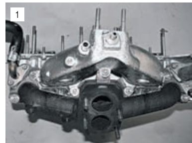
Отворачиваем семь гаек крепления коллекторов к головке блока и снимаем их (см. «Замена прокладок впускного и выпускного коллекторов», с. 48).
