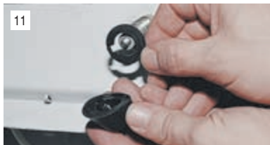
11 ...и снимаем втулку с резиновой прокладкой.
