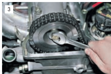
Включаем передачу и ключом «на 17» отворачиваем болт звездочки.
