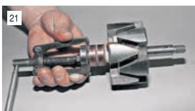
Замена заднего подшипника требуется реже. При необходимости стягиваем его с вала ротора универсальным съемником.
