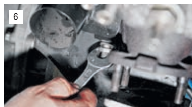
6 Предварительно сняв шланг с воздухозаборника теплого воздуха, ключом «на 13» отворачиваем нижнюю...
