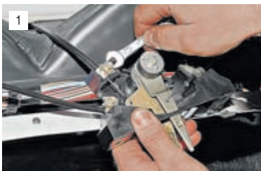
1 Ключом «на 7» отворачиваем болт, снимаем скобу...
