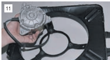
...снимаем и заменяем электродвигатель.
