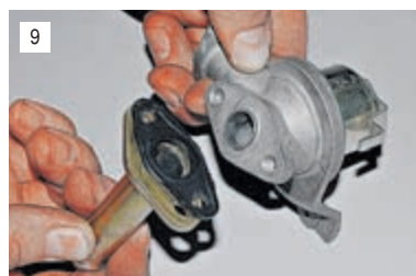
Ключом «на 10» отворачиваем два болта и отсоединяем от крана впускной патрубок со второй прокладкой.
