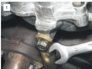
Ключом «на 13» отворачиваем болт крепления к впускной трубе переднего опорного кронштейна.
