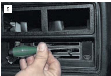
Поддев тонкой отверткой, снимаем заглушку.
