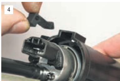
4 ...извлекаем фиксатор из гнезда в держателе.
