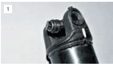
1 Надеваем уплотнения на шипы крестовины и ставим пластмассовые заглушки.
