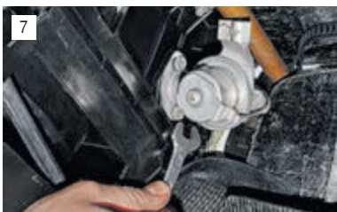
Ключом «на 10» отворачиваем два болта крепления крана к радиатору отопителя...
