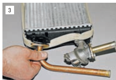
3 ...и снимаем трубу отвода охлаждающей жидкости с уплотнительной прокладкой.
