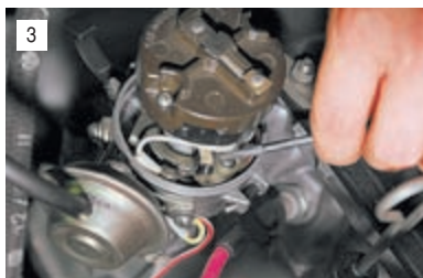
3 ...отверткой ослабляем винт крепления контактной группы...
