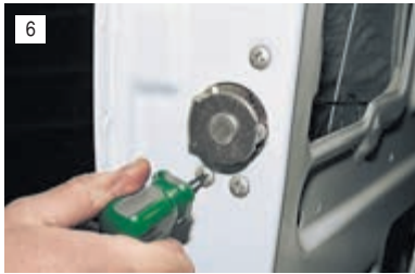
6 Крестообразной отверткой отворачиваем еще три винта...
