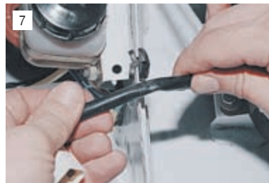
...и, сняв левый край уплотнителя капота, вынимаем жгут проводов из прорези панели.
