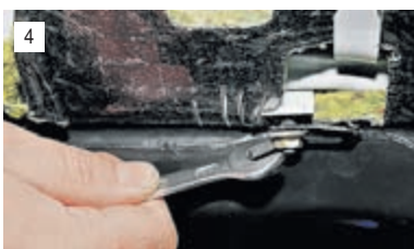
Ключом «на 10» в открывшемся проеме отворачиваем гайку...
