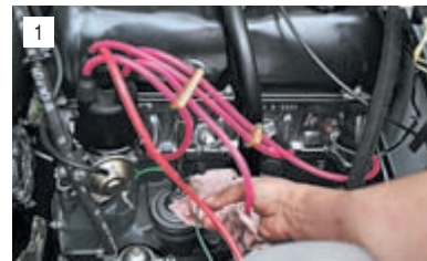
На двигателе, работающем на холостом ходу, поочередно отсоединяем высоковольтные провода от свечей зажигания.
