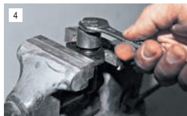
4 Зажав натяжитель в тисках, ключом «на 13» отворачиваем колпачковую гайку.
