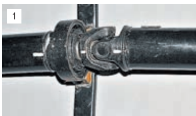
1 Наносим метки взаимного расположения валов и вилок.
