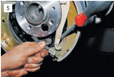
5 Отсоединяем от рычага наконечник левой ветви заднего троса.
