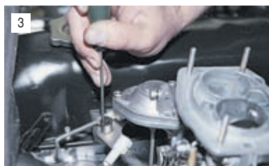
3 Отверткой поддеваем и снимаем стопорную пружинную шайбу рычага.
