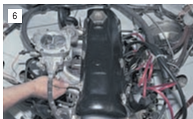
6 Ключом «на 10» отворачиваем восемь гаек крепления крышки головки блока цилиндров...
