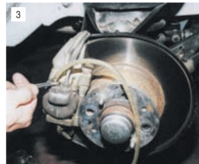
Ключом «на 8» отворачиваем на 1/2–3/4 оборота прокачной штуцер.
