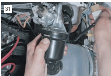
перед установкой моторредуктора на кронштейн включаем его на короткое время, подключив к бортовой сети автомобиля через разъем.
