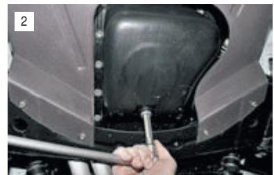
Шестигранным ключом «на 12» отворачиваем сливную пробку поддона картера и сливаем масло в заранее подготовленную емкость, объемом не менее 4 л.
