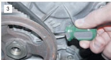
3 При этом метка на шкиве коленчатого вала должна располагаться напротив метки ВМТ (длинной) на крышке привода распределительного вала.
