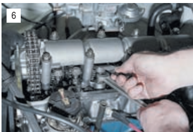
6 Вставляем щуп толщиной 0,15 мм между рычагом клапана и цилиндрической частью кулачка. Ключом «на 13» вращаем регулировочный болт, выставляя требуемый зазор. Перемещение щупа должно быть свободным, но без люфта.
