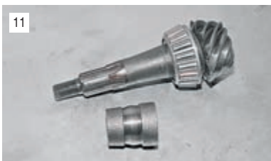
11 Вынимаем из картера ведущую шестерню и деформированную распорную втулку. При сборке редуктора заменяем втулку новой.
