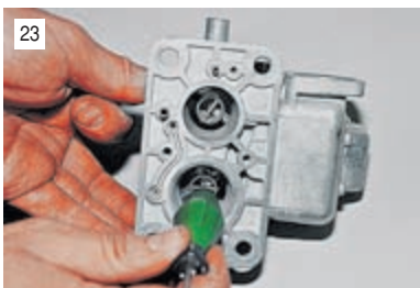
23 Ручкой отвертки осторожно выбиваем диффузоры...
