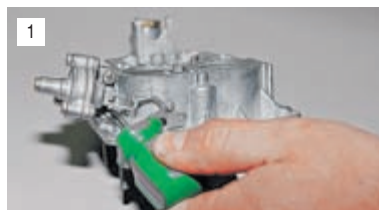
1 Крестообразной отверткой отворачиваем два винта крепления корпуса пускового устройства...
