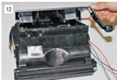
12 Переворачиваем кожух и открываем воздухораспределительную крышку.
