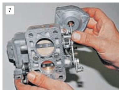
7 Нажимая на шток, утапливаем его в корпус диафрагменного механизма. (При закрытой заслонке первой камеры вторая должна остаться закрытой).
