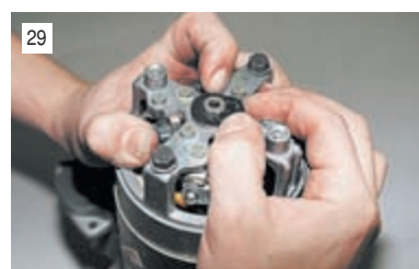
29 Чтобы защелкнуть стопорное кольцо, поджимаем якорь стартера через втулку крышки со стороны привода.
