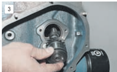
Вынимаем из блока цилиндров валик привода.
