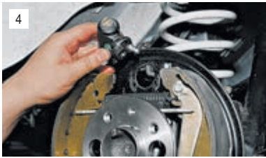
...и снимаем цилиндр.
