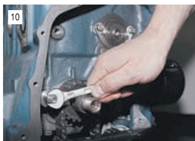
Ключом «на 10» отворачиваем ограничительный палец цепи и снимаем его.
