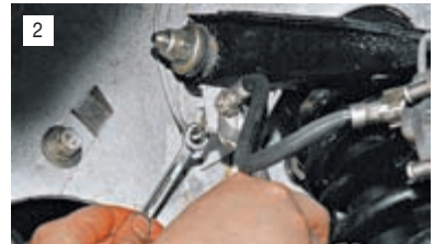
2 Удерживая наконечник шланга от проворачивания ключом «на 17», ключом «на 10» отворачиваем штуцер тормозной трубки.
