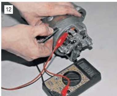
Подсоединяя омметр по очереди к выводам обмоток статора, проверяем их на замыкание на корпус и на межвитковое замыкание. При этом убедитесь, что свободные выводы обмоток изолированы от корпуса.
