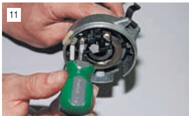
Отворачиваем два винта крепления датчика.
