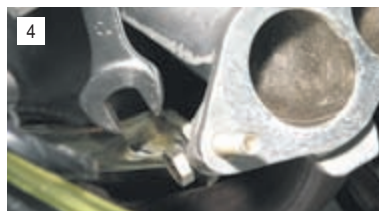
Ключом «на 13» отворачиваем болт крепления заднего опорного кронштейна к впускной трубе.
