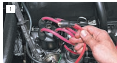
Вынимаем центральный высоковольтный провод (соединенный с катушкой зажигания) из крышки распределителя.
