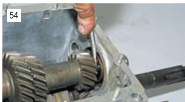
Вставив отвертку между торцами подшипника и шестерни I передачи промежуточного вала, сдвигаем задний подшипник.
