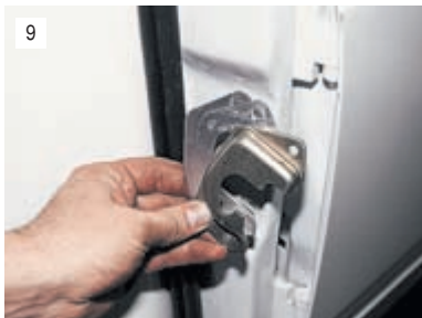
9 ...и снимаем фиксатор двери вместе с регулировочными прокладками. При установке нового фиксатора набор прокладок сохраняем.
