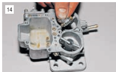
14 Снимаем распылитель с клапаном и уплотнительными прокладками из мягкого металла.
