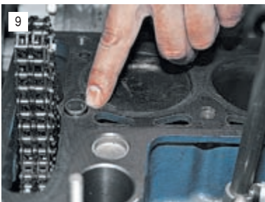
Для центровки прокладки и головки в блоке установлены две втулки.
