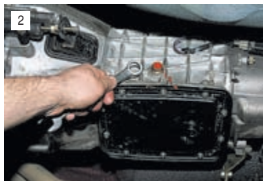
Ключом «на 17» отворачиваем пробку заливного отверстия.
