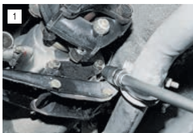
Головкой «на 13» отворачиваем две гайки крепления опоры коробки передач...
