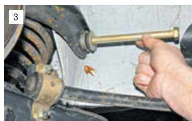
3 Вынимаем ось верхнего рычага и снимаем рычаг с автомобиля.
