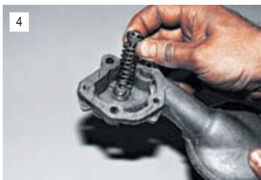
Извлекаем из патрубка редукционный клапан с пружиной...
