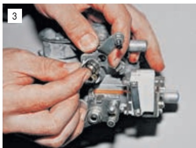
3 ...и, удерживая его, снимаем кронштейн крепления пружины.
