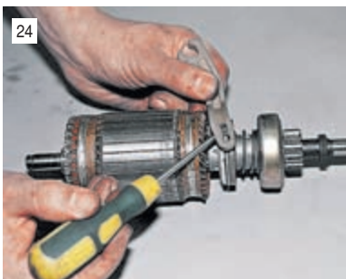
24 Поддев отверткой, снимаем рычаг привода.
