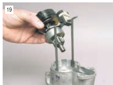
19 ...и снимаем привод в сборе с опорой вала привода и рычагом.
