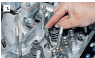
10 Чтобы не повредить рабочую кромку нового колпачка, надеваем на стержень клапана пластиковую втулку. Она продается в наборе с маслоотражательными колпачками.
