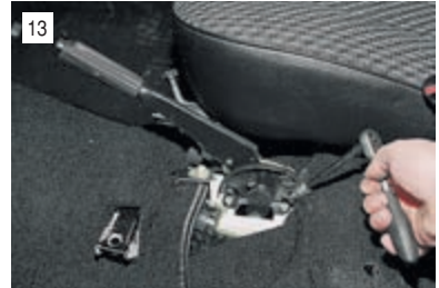
13 Ключом «на 10» отворачиваем четыре винта крепления опоры рычага к кузову.
