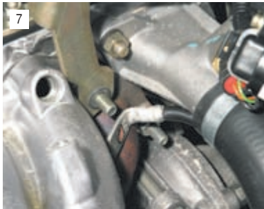
7 Снимаем со шпильки головки блока цилиндров наконечник «массового» провода...
