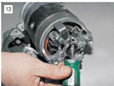
Поддев отверткой, снимаем стопорное кольцо.
