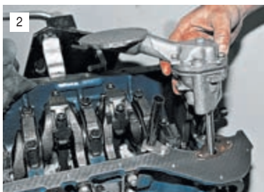
...и снимаем его. Между насосом и блоком цилиндров установлена прокладка.
