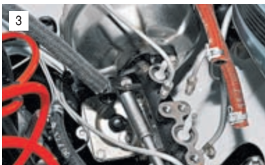
Головкой «на 13» отворачиваем две гайки крепления главного тормозного цилиндра к вакуумному усилителю тормозов.
