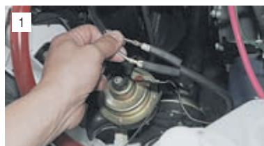
Разъединяем два штекера.
