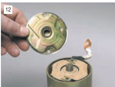
12 ...и снимаем заднюю крышку.
