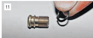
11 Снимаем с корпуса резиновое уплотнительное кольцо.
