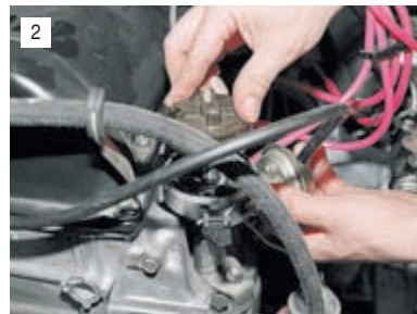
2 Медленно поворачиваем корпус распределителя против часовой стрелки до загорания лампы, при этом слегка прижимаем ротор против часовой стрелки, чтобы выбрать зазор в приводе. Удерживая его в таком положении, затягиваем гайку стопорной пластины.
