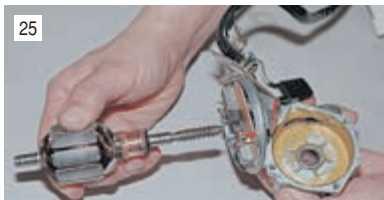
Из редуктора вынимаем якорь с надетой на его вал регулировочной шайбой.
