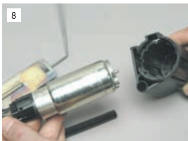
8 Разъединяем держатель и насос.
