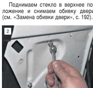
2 Ключом «на 8» отворачиваем болт верхнего крепления и гайку нижнего крепления переднего желобка...
