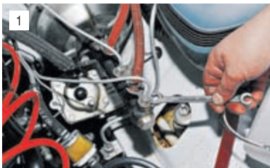
Ключом «на 10» отворачиваем штуцеры трех тормозных трубок от главного тормозного цилиндра, пометив порядок их подсоединения.
