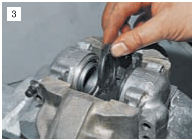
3 Поддев отверткой, снимаем защитные колпачки поршней.
