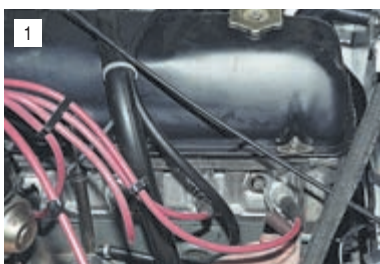
Датчик указателя температуры охлаждающей жидкости установлен в головку блока цилиндров с правой стороны.
