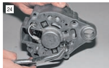
Из задней крышки извлекаем три болта вместе с изоляционными прокладками...
