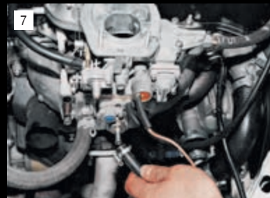
7 Образования воздушных пробок можно избежать, сняв резиновый шланг с впускного трубопровода. При появлении жидкости – надеваем шланг на штуцер (корпус воздушного фильтра для наглядности снят).
