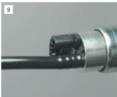
9 Для отсоединения пластиковой трубки от патрубка насоса необходимо разогреть конец трубки до температуры 70-80°C (например, поливая горячей водой или нагревая промышленным феном) или обрезать конец трубки, надетый на патрубков насоса.
