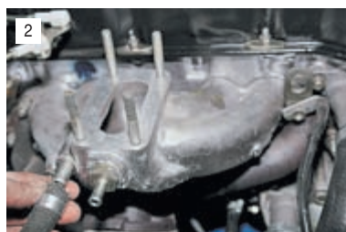
2 ...снимаем шланг вакуумного усилителя тормозов.
