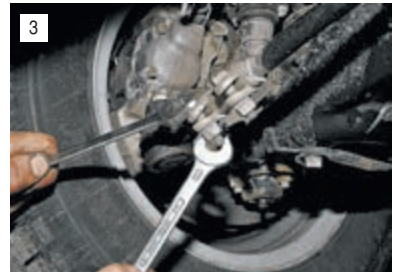
...двумя ключами «на 13» ослабляем стяжные хомуты на резьбовой муфте боковых тяг рулевой трапеции.
