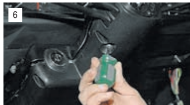
...и один саморез, фиксирующий нижнюю половину на колонке.
