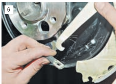
Отсоединяем рычаг привода стояночного тормоза от наконечника троса.
