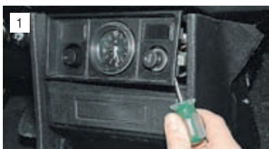
1 Отверткой отжимаем любой боковой край вкладыша, выводим фиксаторы из пазов панели радиоприемника и снимаем верхний вкладыш вместе с приборами.
