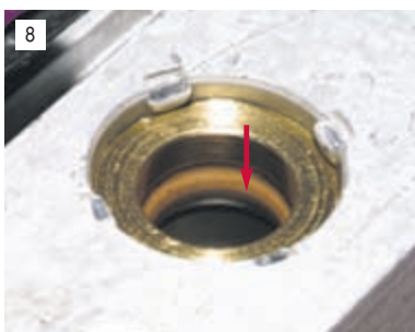
Наконечник трубки уплотняется резиновым кольцом.
