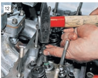
12 Пинцетом снимаем пластиковую втулку и через оправку напрессовываем колпачок на направляющую втулку.
