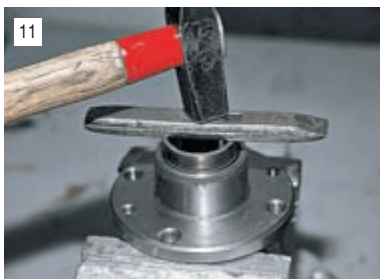
11 Соблюдая осторожность, можно запрессовать наружные кольца подшипников легкими ударами молотка через прокладку.
