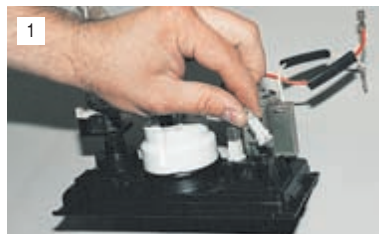
1 Повернув против часовой стрелки патрон лампы, вынимаем его из вкладыша.
