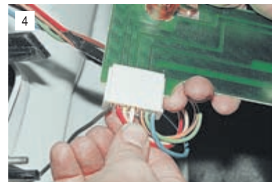
Нажав на выступ снизу колодки, отсоединяем ее от платы.
