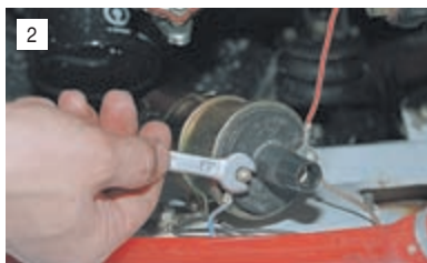
2 Ключом «на 8» отворачиваем гайку с вывода, обозначенного на крышке катушки буквой «Б», и снимаем наконечник голубого провода с красной полосой.
