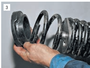
3 На верхней части пружины установлена резиновая изолирующая прокладка.
