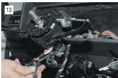
13 Головкой «на 8» ослабляем болт хомута крепления подрулевых переключателей...
