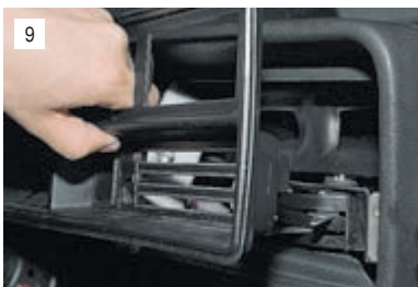
Вытягиваем правый край щитка на себя. Просунув руку между щитком и панелью приборов, отворачиваем гайку крепления троса привода спидометра.
