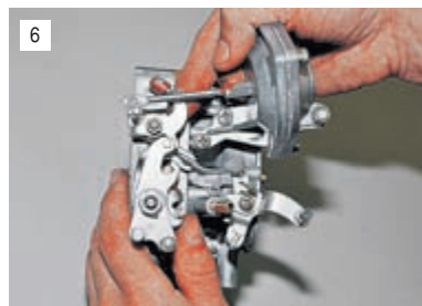
6 ...и регулируем ее длину, чтобы при полностью закрытой дроссельной заслонке второй камеры отверстие тяги находилось напротив пальца промежуточного рычага.
