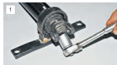
1 Торцевой головкой «на 27» отворачиваем, но не до конца, гайку крепления вилки переднего карданного вала.
