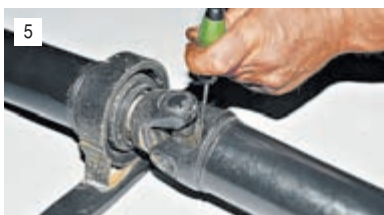
5 Отверткой, упиравшись в край корпуса подшипника, окончательно выбиваем выпрессованные подшипники из посадочных мест вилок.
