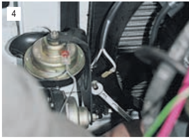
Ключом «на 8» отворачиваем два болта крепления кожуха вентилятора к левому бачку радиатора...
