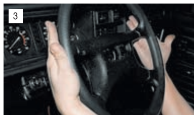
...ударами ладоней по ободу сбиваем рулевое колесо со шлицев вала.
