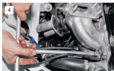
4 Головкой «на 13» отворачиваем гайку...
