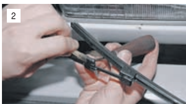
2 Поддев фиксатор шилом, снимаем форсунку омывателя фар с рычага-щеточки очистителя.
