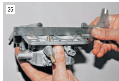
25 Линейкой на просвет проверяем основание корпуса на искривление.
