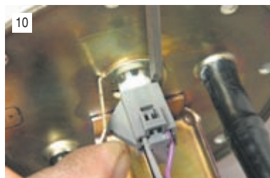
10 ...отводим фиксатор колодки проводов...
