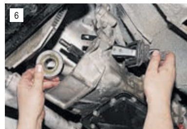
Потянув наружу из картера, вынимаем вилку выключения сцепления, снимаем с ведущего вала коробки передач подшипник выключения сцепления.
