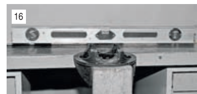
16 Выставляем картер в горизонтальное положение по уровню.
