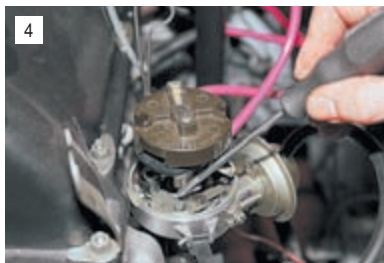
4 ...и регулировочный винт. Для удобства бегунок можно снять (см. «Замена ротора распределителя», с. 159).
