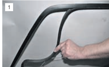
1 Вынимаем уплотнитель из передней и верхней частей рамки двери.
