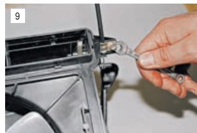
9 Ключом «на 7» отворачиваем саморез и отсоединяем тягу привода заслонок управления потоком воздуха.
