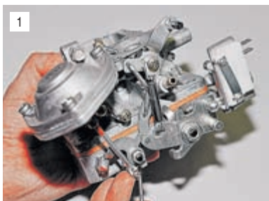
1 Поддев шилом, снимаем стопорное кольцо тяги пневмопривода дроссельной заслонки второй камеры.
