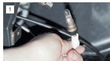
Открыв вещевого ящик, вынимаем из корпуса выключателя патрон вместе с лампой.
