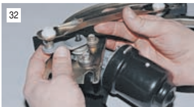
Кривошип устанавливаем параллельно короткой тяге привода. В противном случае щетки стеклоочистителя не будут останавливаться в нужном положении.
