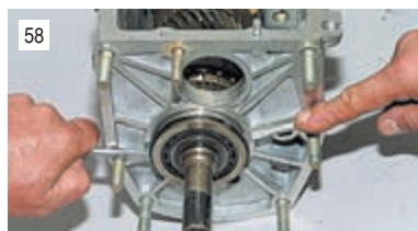
Поддев двумя отвертками за установочное кольцо задний подшипник первичного вала...
