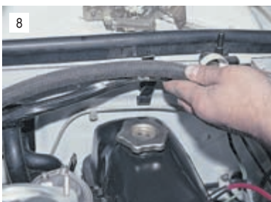
8 Разжимаем держатель и освобождаем шланг вакуумного усилителя тормозов и жгут проводов.
