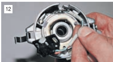
Вынимаем электропроводку датчика.
