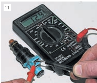
Сопротивление обмотки форсунки проверяем тестером.
