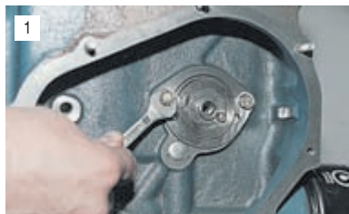
Ключом «на 10» отворачиваем два болта крепления упорного фланца валика...
