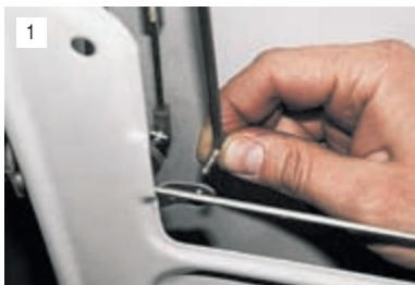
1 Шлицевой отверткой аккуратно отсоединяем тягу кнопки выключения замка.
