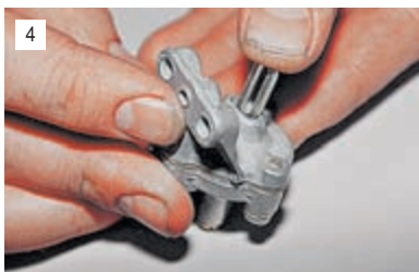
4 Нажав на шток диафрагмы, закрываем пальцем входное отверстие.
