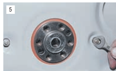
Ключом «на 10» отворачиваем две гайки крепления щитка картера сцепления...
