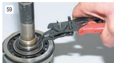
Щипцами разжимаем стопорное кольцо...
