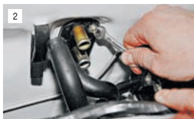
Ключом «на 8» отворачиваем два самореза...
