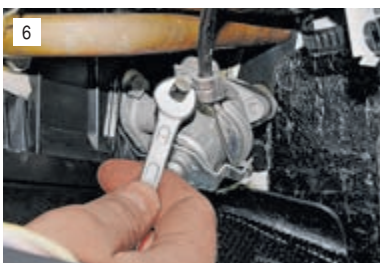
Ключом «на 7» ослабляем затяжку болта и отсоединяем от крана тягу привода.
