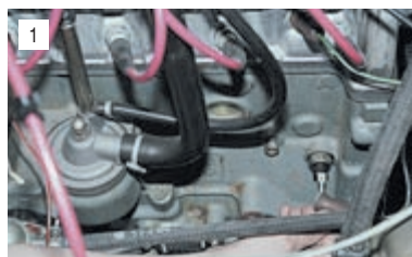
Снимаем колпачок и отсоединяем провод от вывода датчика.
