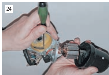
24 ...и снимаем корпус электродвигателя, удерживая отверткой якорь за червяк.
