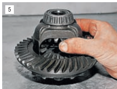
5 Проверяем отсутствие радиальных люфтов в шестернях полуосей.
