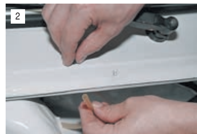
Придерживая форсунку, снизу надаем на нее подводящий шланг.
