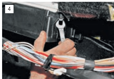
4 ключом «на 10» отворачиваем оставшиеся три гайки крепления...
