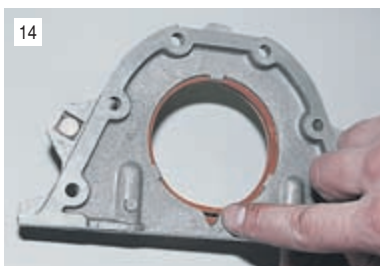
Отверткой через вырез в держателе выбиваем манжету.
