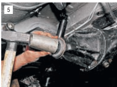
5 Легкими ударами молотка через отрезок трубы подходящего диаметра запрессовываем новую манжету, предварительно покрыв ее посадочную поверхность смазкой Литол-24.
