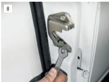
8 Отметив фломастером положение фиксатора на стойке, ключом «на 10» отворачиваем три болта крепления...
