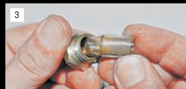
3 Фильтр и пробку промываем в ацетоне и обдуваем сжатым воздухом от шинного насоса.
