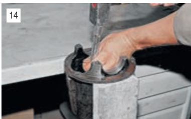
14 Подходящим инструментом выбиваем внешние кольца конических подшипников из картера.
