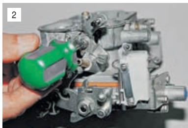
2 Крестообразной отверткой отворачиваем винт крепления трехплечего рычага...
