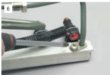
...крестообразной отверткой отворачиваем винт крепления держателя трубки.
