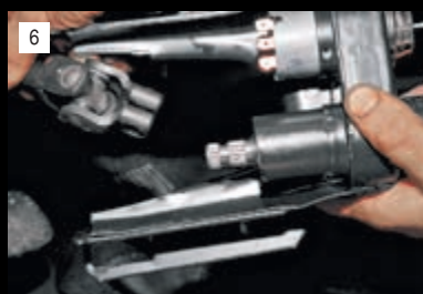
6 Вынимаем верхний вал из шлицевого соединения с промежуточным валом.
