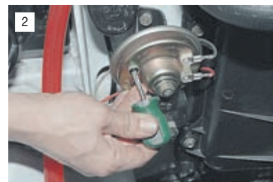
2 При включенном другом сигнале, отверткой плавно вращая регулировочный винт в ту или иную сторону, добиваемся чистого и громкого звука. Если регулировкой не удастся устранить хрипы – меняем звуковой сигнал.
