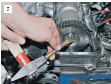
Отгибаем край стопорной шайбы болта крепления звездочки распределительного вала.
