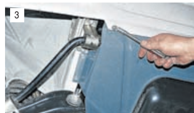
3 Головкой «на 8» отворачиваем 12 саморезов крепления брызговика.
