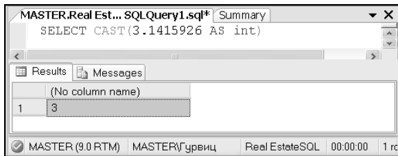
Рис. 13.5. Результат преобразования 3.1415926 к целому типу int
