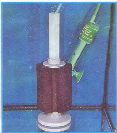
Простейший эрлифтный фильтр и нагреватель с терморегулятором
