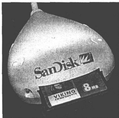
Рисунок 2.10. Считыватель для карт памяти может ускорить передачу изображений, если ваша цифровая камера не имеет быстрого соединения USB или FireWire
