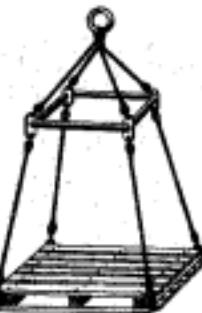
Рис. 16.6. Универсальная деревянная площадка грузоподъемностью до 3 т с захватами
