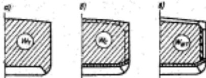
Рис. 7.1. К определению грузоподъемности судов: а – трансверсальной; б – изнутри грузу; в – извне грузу
