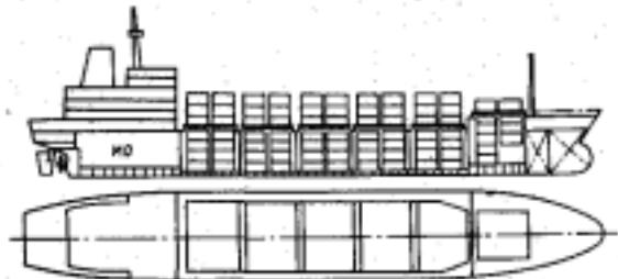
Рис. 25.5. Специализированное контейнерное судно типа „Симон Большой“ вместимостью 412 ТЕУ. Продольный разрез и схематизированый вид сверху
