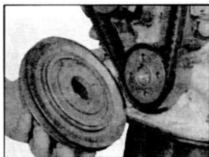
9.10 Снятие шкива коленвала/вибrogасителя
