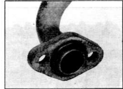
16.27 Кольцевое уплотнение на всасывающей масляной трубке
