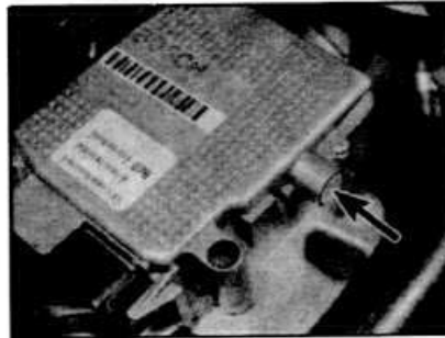
11.4 Расположение винта смеси холостого хода (отмечен стрелкой) - модель 1.8 литра
