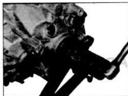
8.2 Ослабьте и снимите стопорную гайку фланца привода...
