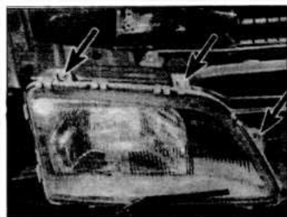
17.6a Монтажные болты фары (отмечены стрелками) - показана модель Omega
