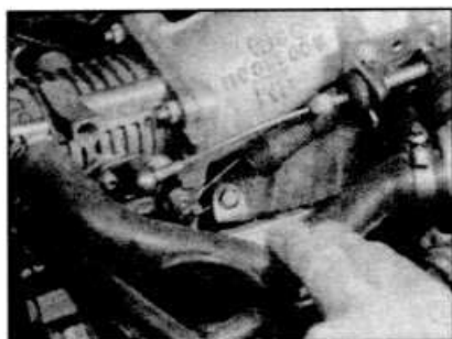
3.1a Соединение тросика акселератора к корпусу дросселя
