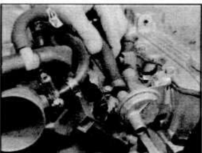
12.25b ... и отсоедините шланги вспомогательного пневмоклапана
