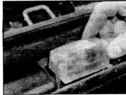
16.40a Удалите лампочку подсветки номерного знака ...
