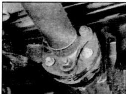
10.5 Заднее гибкое соединение шарнира диска карданного вала
