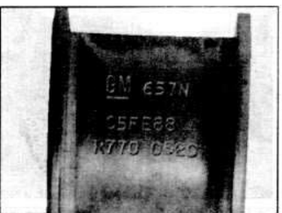
14.13б Номера идентификации на центральных коренных вкладышах
