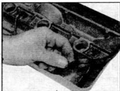
12.40b ... и главную прокладку на покрытие головки блока цилиндров
