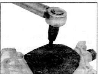
14.7 Сжатие винтов задней крышки масляного насоса
