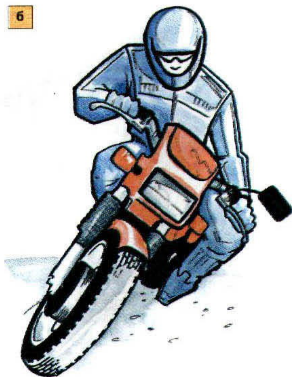
Рис. 3.8. Способы наклона тела водителя относительно мотоцикла: а — вместе с мотоциклом на один и тот же угол; б — на угол меньший, чем наклон мотоцикла
