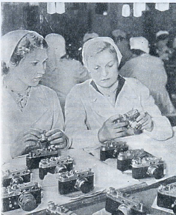
На пульсирующем конвейере собираются аппараты «Зоркий-С» Т. К. Кубарева (слева) и Р. А. Ленова
