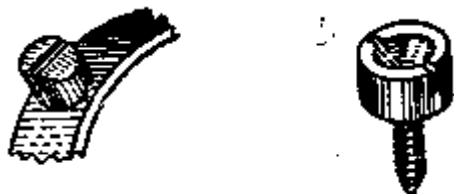
Рис. 92. Облегчение винтов баланса: 1 метод опиловки; 2 метод зенковки
