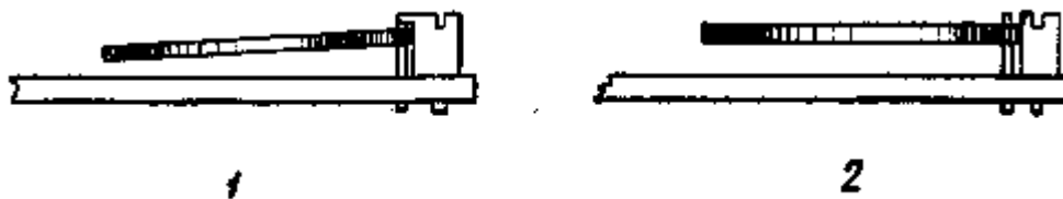
Рис. 75. Положение волоска: 1 — неправильное; 2 — правильное
