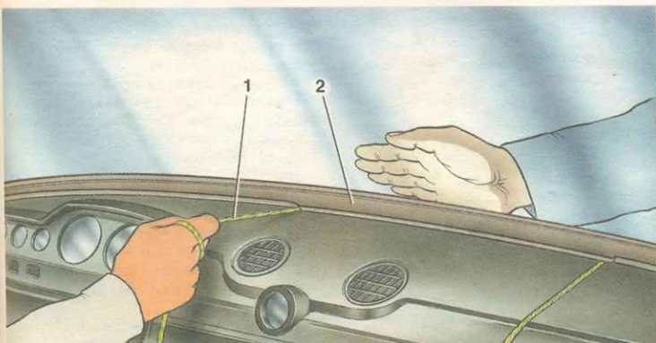
Рис. 9.16. Установка ветрового окна: 1 – шнур для установки ветрового стекла; 2 – уплотнитель
