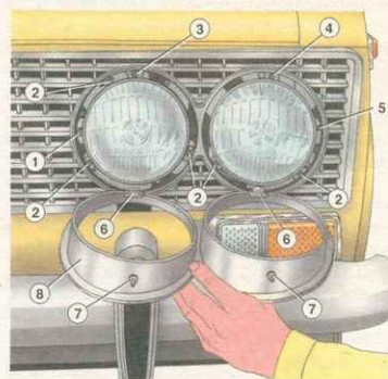
Рис. 11.14. Фары со снятой рамкой: 1 – винт для регулировки пучка света внутренних фар в горизонтальном направлении; 2 – винты крепления оптического элемента к внутреннему ободку; 3 – винт для регулировки пучка света внутренних фар в вертикальном направлении; 4 – винт для регулировки пучка света наружных фар в вертикальном направлении; 5 – винт для регулировки пучка света наружных фар в горизонтальном направлении; 6 – скобы крепления рамки фар; 7 – винты крепления рамки фар; 8 – рамка фар
