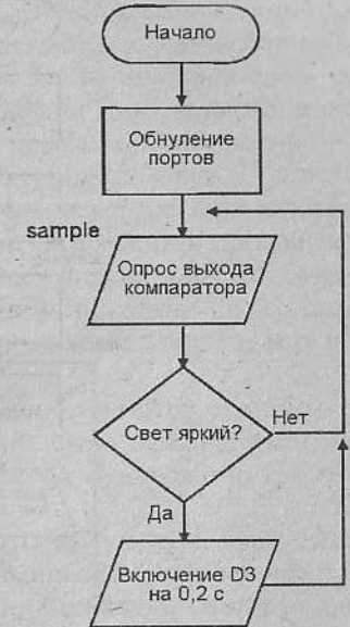
Рис. 6.15. Блок-схема показывает, что программа работает в режиме непрерывного цикла. Всякий раз при прохождении цикла опрашивается выход компаратора, а светодиод включается на 0,2 с или не включается, в зависимости от результатов опроса
