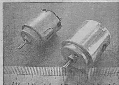
Рис. 2.19. Пара очень дешевых двигателей на 1,5 В и 4,5 В. Они формируют крутящий момент 8 гс·см и 18 гс·см соответственно. Эти двигатели не имеют коробки передач
