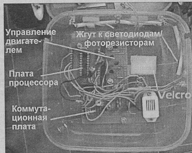
Рис. 6.14. Содержимое коробки по окончании монтажа (вид снизу). Большинство соединений — между платой процессора и коммутационной платой, однако провода отведены от процессорного гнезда, чтобы не мешать установке и извлечению микроконтроллера PIC. Жгут к светодиодам/фоторезисторам идет влево (на фотографии — вправо) вблизи от отрезка ленты Velcro. Выключатель питания S1 можно просматривается между отрезком ленты Velcro и зуммером
