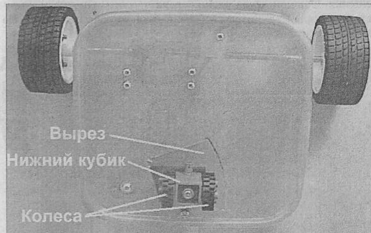
Рис. 6.1. Колесный узел робота "Скутер" прикреплен к крышке коробки (здесь — вид снизу). Робот движется на трех колесах, однако задний ролик, — это, фактически два колеса. Ролик вращается вокруг оси, расположенной с одной стороны продольной центральной линии. Здесь ролик показан в позиции, соответствующей движению робота прямо вперед
