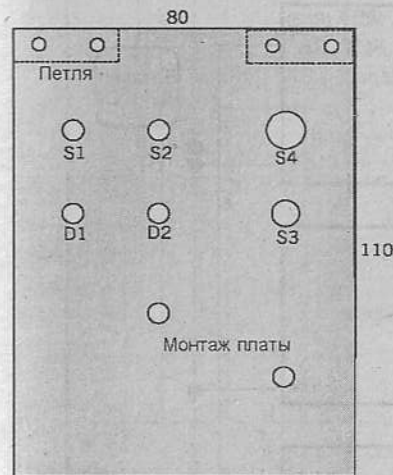
Рис. 9.9. Панель управления с двумя отверстиями для монтажа платы управления
