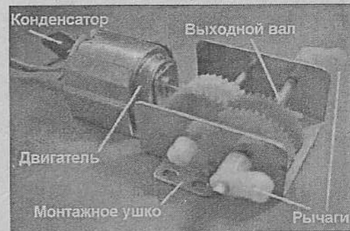
Рис. 10.20. Двигатель производства CIS для управления губками схвата. Подвижные губки привинчены болтами к двум рычагам, установленным на обоих концах выходного вала. Вал на несколько миллиметров выступает за рычаги для установки в два отверстия в основании подвижных губок (см. рис. 10.21)
