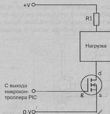
Рис. 3.38. Транзисторный ключ на n-канальном полевом МОП-транзисторе. Токоограничивающий резистор может не потребоваться. Если нагрузка носит индуктивный характер, то потребуется защитный диод
