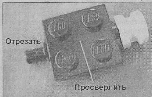
Рис. 10.3. Базовый узел (черный) с одним установленным колесом (белое). Канавка колеса достаточно широкая, чтобы плотно держаться на направляющей шириной 3 мм
