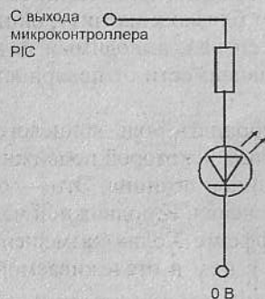
Рис. 3.34. Прямое управление светодиодом. Для расчета номинала резистора используйте формулу, рассмотренную выше в разделе "Источники питания"
