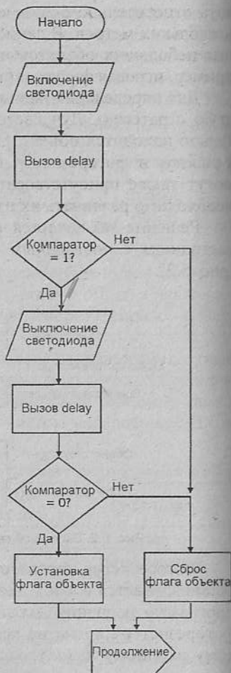
Рис. 5.3. Обнаружение объекта. Может случиться так, что другой источник света перестанет светить на фоторезистор в момент выключения светодиода. Возможно, это маловероятно, однако для защиты от этой ошибки перед установкой или сбросом флага следует повторить две проверки. Результат “Нет” для любой из четырех проверок сбрасывает флаг
