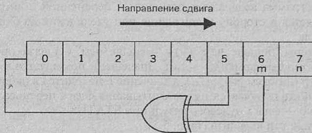
Рис. 5.6. Генератор случайных чисел может быть построен на базе микросхемы сдвигового регистра и логического элемента “Исключающее ИЛИ”
