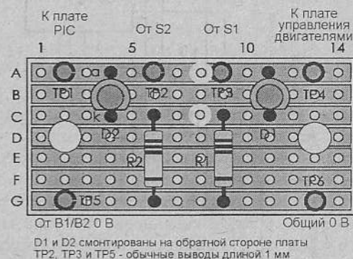
Рис. 10.31. Разводка платы управления питанием для системы PIC1. Эта плата крепится болтами к внутренней части левой боковой панели. Длина болтов — 25 мм, а светодиоды, размещенные в задней части платы, проходят через отверстия диаметром 5 мм, просверленные в панели
