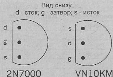
Рис. 3.8. Распределение выводов двух маломощных полевых МОП-транзисторов
