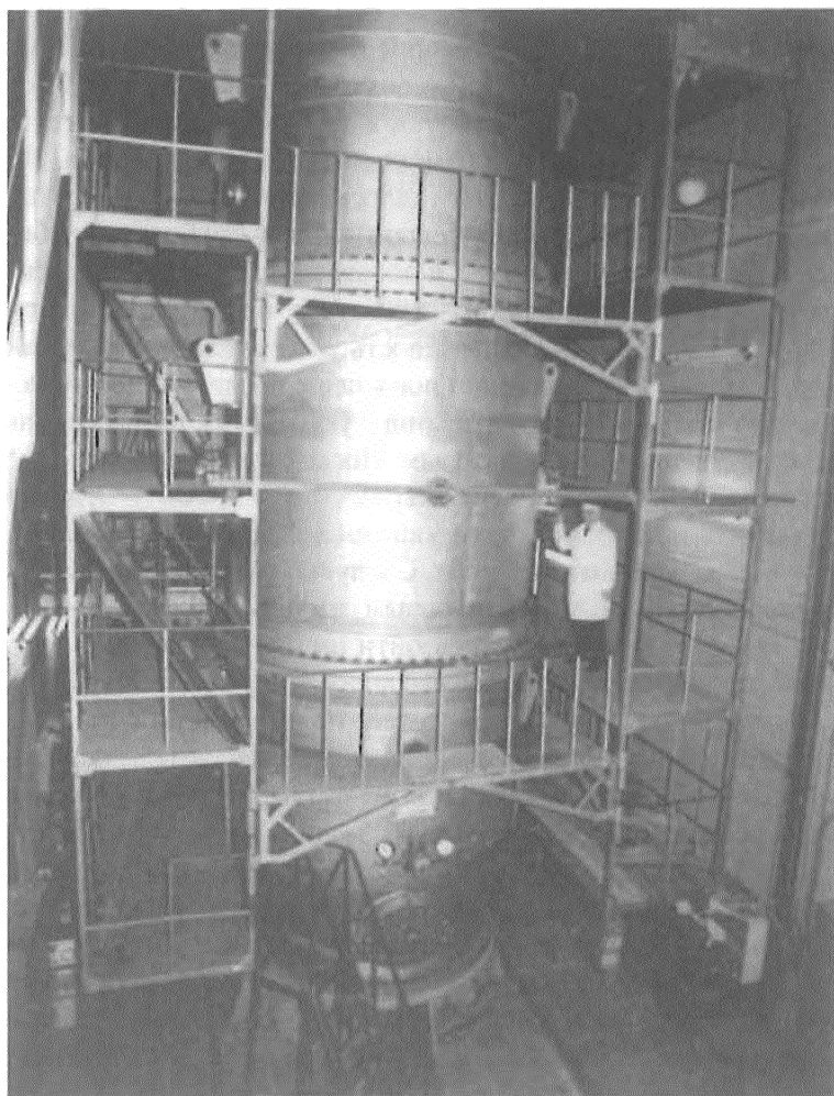
Электростатический перезарядный генератор ЭГП-10
