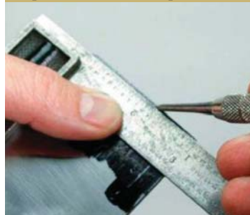
Разметьте угольником прямой угол на лезвии.
