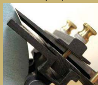
Выставление угла фаски на точиле это комбинация вылета лезвия и угла наклона столика этого подручника от Veritas.
