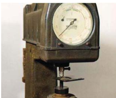
Наш старинный, времен Второй Мировой Войны, прибор для измерения твердости с тестируемой железкой струга.
