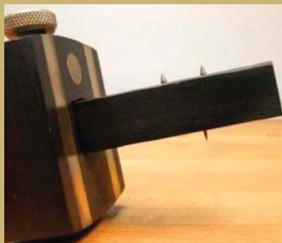
Разметочный рейсмус иглового типа с показанными иглами.
