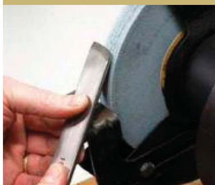
Точила с водяным охлаждением помогают избежать риска перегрева, а держатель обеспечивает точные, повторяемые углы. Но низкоскоростные круги отнимают больше времени для заточки кромки.
