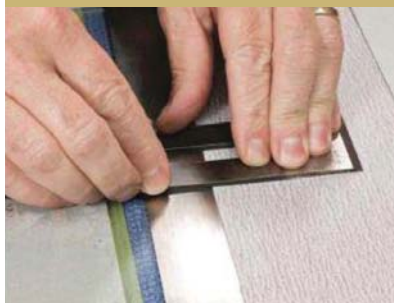
Тонкая металлическая линейка (или кусок пластика или что-нибудь еще) поднимает заднюю часть железки, что уменьшает усилия по выравниванию рабочего конца железки.
