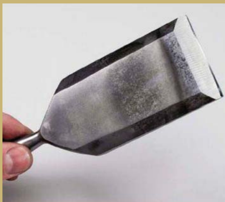
Это стамеска, заточенная на зернистости 8000.
