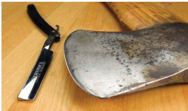
Разные режущие инструменты (опасная бритва слева и топор справа) требуют сильно отличающиеся углы фаски на их кромках.
