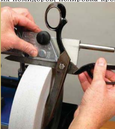
Приспособление для заточки ножниц для станка Tormek в работе.
