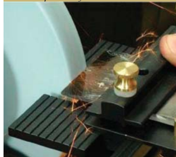
Обточите по линии, чтобы удалить зазубрины на кромке.
