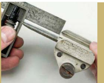
Вылет лезвия из каталки определяет угол фаски. Это каталка с боковыми прижимами, Eclipse-style.
