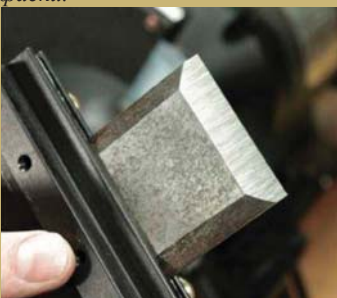
Ваша конечная фаска должна быть ровной и прямоугольной.
