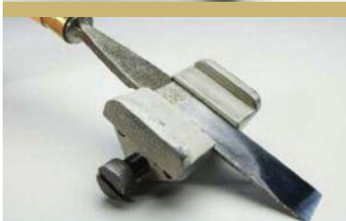
В нижнем зажиме, задняя сторона стамески крепится параллельно оси колесика.
