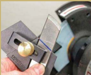
Зажим для заточки скошенных резцов от Veritas вращается на штыре в отверстии подручника.
