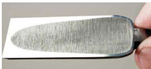
Японские стамески имеют впадину на задней поверхности, для того чтобы уменьшить количество стали, которое нужно удалить в процессе заточки.
