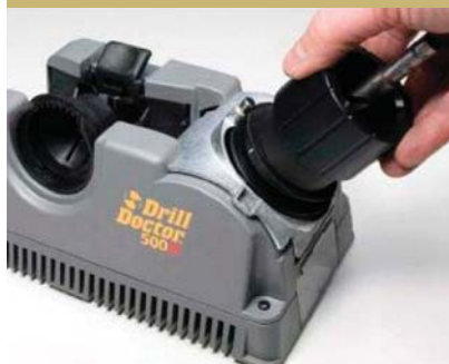
Сверло и патрон вставляются в заточное отверстие и ими покачивают вверх вниз с вращением влево и вправо.
