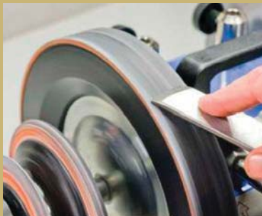
Полировка кромки, возможно, и не нужна для токарных резцов, но и не повредит, если вы будете избегать любых микрофасок, которые могли бы взаимодействовать с «трением фаски» используемым токарями.
