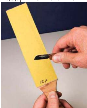
Эта легко изготавливаемая лопатка для заточки обклеена куском 12 микронной абразивной пленки с одной стороны и 5 микронной с другой.
