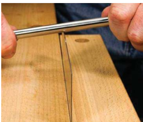
Наведите заусенец при помощи простой отводки в виде стержня.
