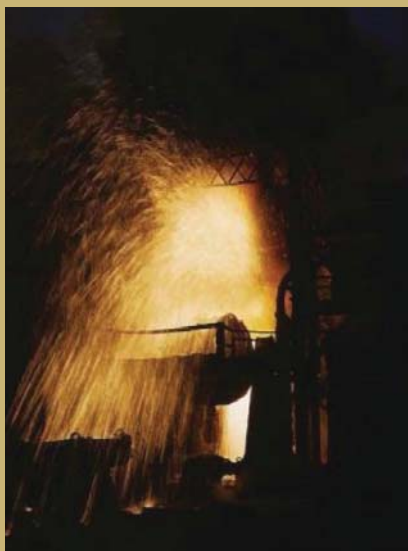
Бессемеровский конвертер в работе на Republic Steel Mill, Янгстаун, штат Огайо, 1941 год. Фото Alfred T. Palmer.
