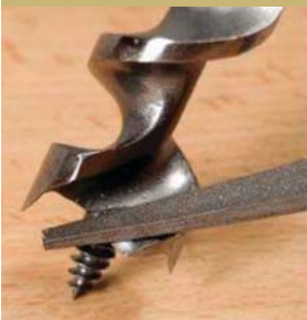
Используйте небольшой напильник с гладкой кромкой или камень с небольшим скосом.
