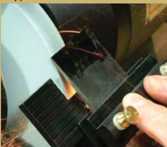
Избегайте перегрева при заточке фаски.
