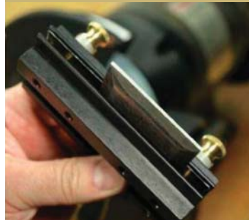
Эта кромка заточена до прямоугольной формы и готова для заточки фаски.
