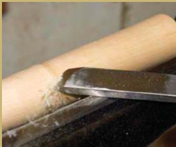
Когда вы закончите заточку, скошенный резец примется за работу по быстрому удалению материала.
