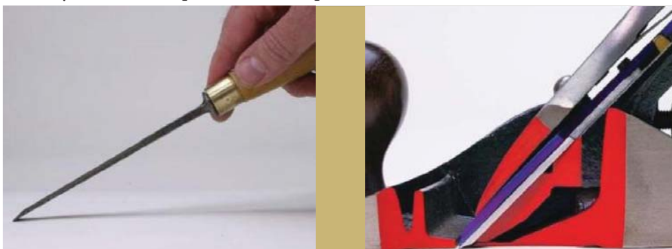
Ножи и стамески обладают изменяемым углом резания, который можно регулировать в процессе реза. Рубанки и пилы обладают фиксированным углом резания.
