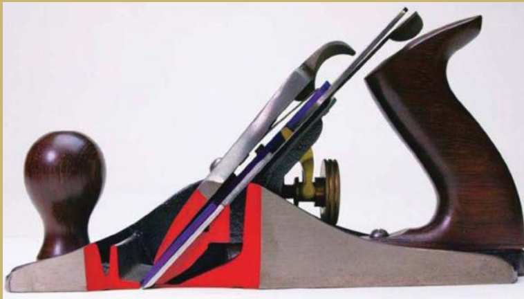
Столярный рубанок в разрезе
