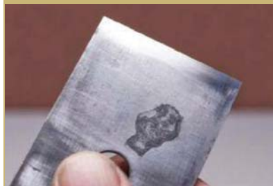
Всего за несколько секунд, я выровнял достаточную площадь задней плоскости, которой хватит как минимум на дюжину доводок фаски; и если я буду внимательным, то это уродливое ржавое пятно меня не побеспокоит еще годы.
