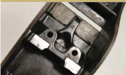
Рабочие поверхности, на которые ставится лягушка, нужно почистить (показана довольно плохая очистка). Поскоблите чем-нибудь или напильником, так чтобы обеспечить хороший контакт металла с металлом между лягушкой и колодкой рубанка.
