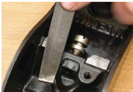
Опилите внутренние поверхности колодки рубанка.
