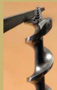
Тот же напильник с гладкой кромкой или камень используются для заточки внутренней передней и верхней части кромки зубцов.
