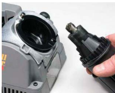
Вылет и направление сверла настроены и патрон затянут.
