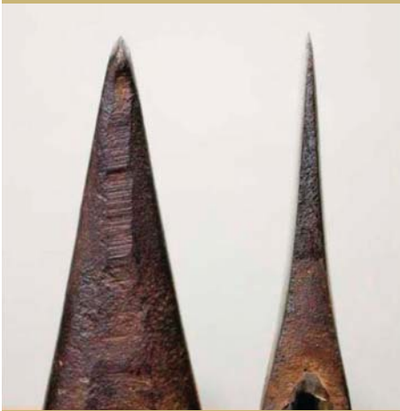
Колун, слева, обладает большой фаской, чтобы расщеплять древесину дров. Топор, справа, обладает гораздо меньшим углом фаски, чтобы рубить перпендикулярно древесным волокнам.
