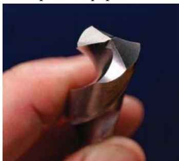
Острое сверло с крестообразной формой вершины.
