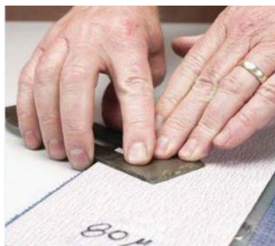
Обычно выравнивание задней стороны железки означает заточку задней стороны на камне или слое абразива
