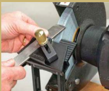
Зажим для заточки скошенных резцов от Veritas вращается на штыре в отверстии подручника.
