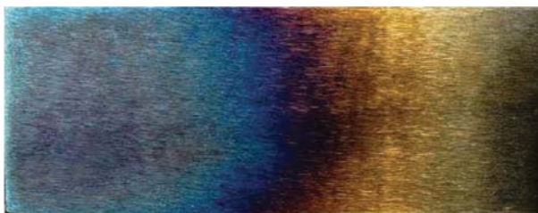
Хорошо узнаваемая радуга цветов, которая показывает температуру поверхности. Светло-соломенный цвет справа показывает примерно 400°F (200°C), темно-коричневый примерно 500°F (260°C), бледно-голубой примерно 600°F (315°C), а светло-голубой 640°F (340°C).
