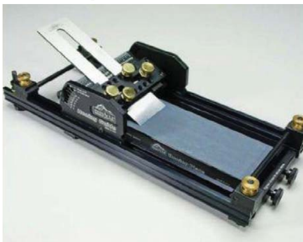
Скользилка от Pinnacle с держателем абразива и прикрепленной к нему абразивной пленкой.
