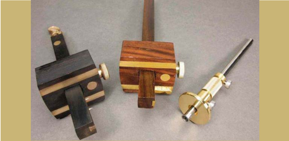
Рейсмусы слева направо: mortising gauge с иглой фирмы Garret-Wade, рейсмус с ножом фирмы Crown Tool, рейсмус с диском марки Tite-Mark фирмы Glen-Drake.
