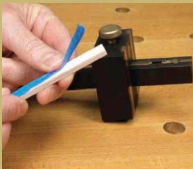
Разметочный рейсмус иглового типа with blue-taped ceramic rod.
