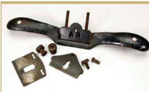
Стружок №151 фирмы Stanley. Этот струг валялся без присмотра слишком долго.
