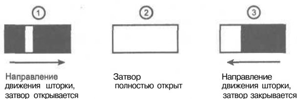
Рис. 7.2. Работа шторного затвора
